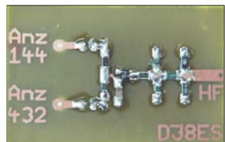
Bild 5: Fertig bestückte Detektorplatine; die SMD-Bestückung erfolgt auf der Leiterseite.
