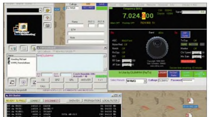
Bild 2: Die Software zur Bedienung der IRB-Stationen: Mit dabei Packet-Cluster und CW-Sendefenster
