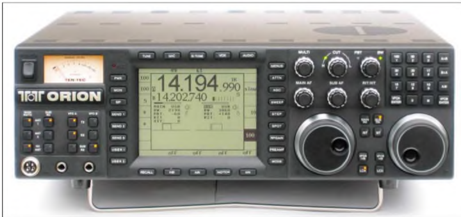
Bild 1: Die Front des Ten-Tec Orion Modell 565AT wird vom großen Display bestimmt. Die Knöpfe sind den VFOs, nicht den Empfängern zugeordnet.
