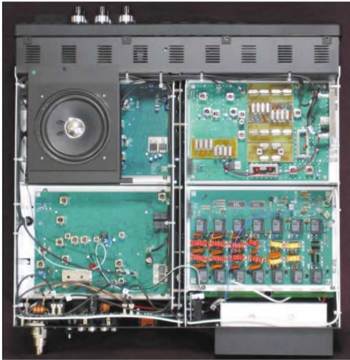
Bild 4: Ein Blick von oben in den geöffneten Orion. In der Mitte, von zwei Schirmblechen flankiert, das „Motherboard“ zur elektrischen Verbindung der wesentlichen Baugruppen/Leiterplatten. Oben links unter dem Lautsprecher der ZF-Konverter, daneben die 9-MHz-ZF-Leiterplatte, die auch die „Roofing“-Filter trägt. Die darüber befindliche Abdeckplatte wurde abgeschraubt. Links unten der Sub-Empfänger, rechts unten die Tiefpassfilter-Baugruppe des Senders, darunter die Endstufe samt Kühlkörper
