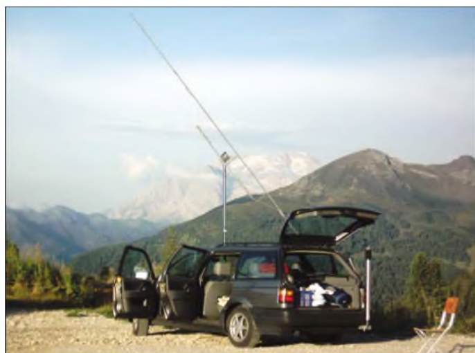
Ein Platz an der Sonne – die Antenne auf den Mond gerichtet. Mittels eines an der 12-V-Autobatterie betriebenen DJ9YW-Transverters (Typ BJ 250 A, Input 50 MHz/4 W, Output auf 1296 MHz bis zu 100 W) sowie einer 5 m langen 59-Element-Yagi für 23 cm (19,7 dBd Gewinn) wurden von Korsika und Sardinien 13 JT44-EME-QSOs gefahren.
