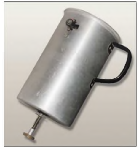
Über die Korrekturschraube im Boden wurde die wirkende Kapazität verändert, womit eine Feinabstimmung auf die Störfrequenz möglich war. Fotos: DL2LUX
