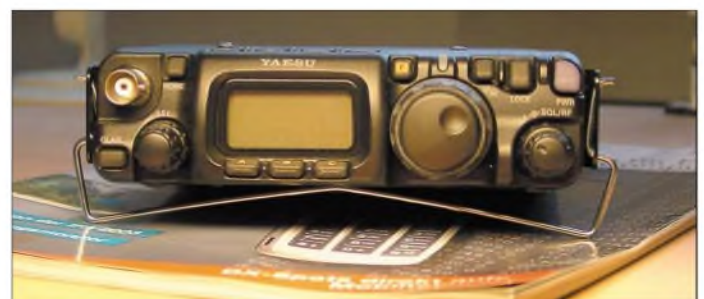
Bild 1: Bei der Nutzung längerer Stäbe aus Federstahl kann man den Kippwinkel weiter vergrößern.
