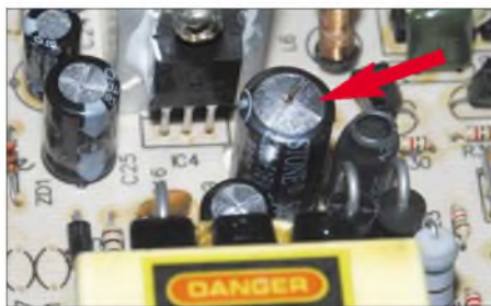
Bild 2: Heutige fernbedienbare Unterhaltungselektronik kennt keinen Netzschalter, das Netzteil läuft ständig durch. Nach zwei Jahren sind bei Billigplayern, wie hier beim Yamakawa 715, die überhitzten Elkos am Ende, sie platzen, blasen ihren Elektrolyt ab und trocknen aus ... Foto: DL2MCD
