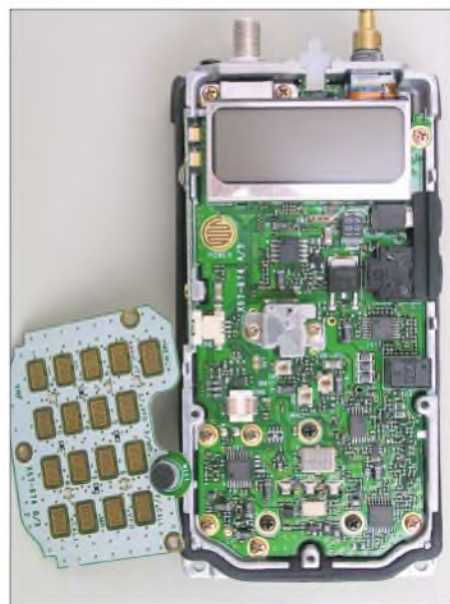
Die Hauptplatine ist SMD-bestückt, die Tastaturplatine aufgeschraubt (hier abgenommen).
