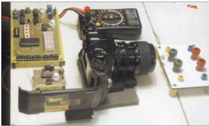
Bild 1: Als eine mögliche Anwendung der Zählerplatine zusammen mit zwei Lichtindikatoren ist die Messung der Verschlussöffnungszeit von Fotoapparaten realisierbar.
