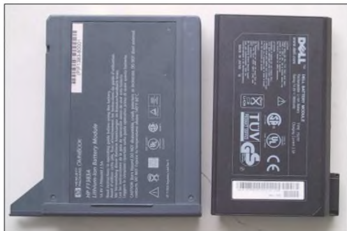
Bild 6: Verschiedene bei [1] ersteigerte Notebook-Akkumulatoren verdeutlichen die Weiterentwicklung – der große ist ein Backup-Akkumulator mit 2,7 Ah, der kleinere ein neueres Modell mit 3,8 Ah.
