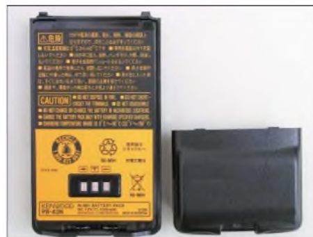
Der NiMH-Akkupack ist robust, allerdings auch doppelt so groß wie ein Lilon-Akku mit gleichen Anschlusswerten.
