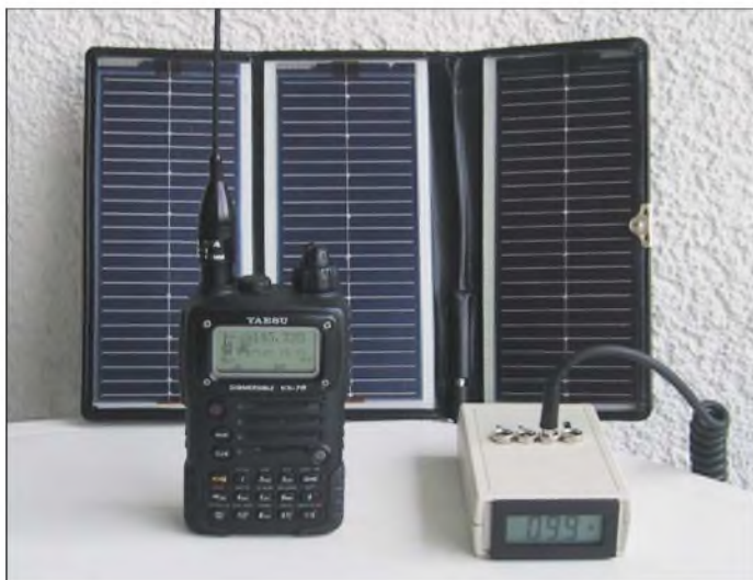
Bild 1: Die Powerbox kann man auch mit 100 mA Solarstrom an einem bewölkten Sommertag laden.
