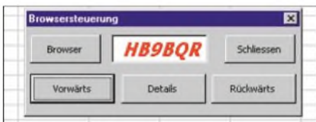
Bild 5: Das Formular erlaubt es, Excel-Programm völlig in den Hintergrund zu legen bzw. dessen Fenster zu schließen und lediglich mit dem User Form im Vordergrund den Browser zu steuern.
