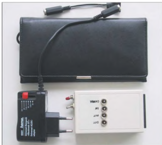
Bild 2: Als Ersatz für diverse Netzteile dient diese Reiseausrüstung bestehend aus Solarpaneele, Schaltnetzteil und Li-Ionen-Powerbox.
