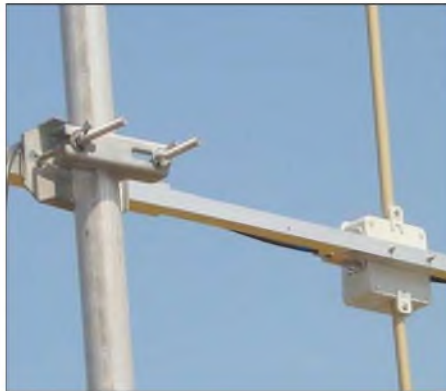
Bild 2: Ansicht der für Abgleichzwecke verschiebbaren Masthalterung
