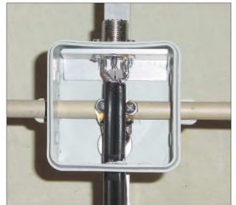
Bild 3: Praktische Ausführung des Strahlermittelteils und der Anpassdose
