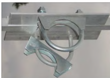
Bild 7: Selbstgebaute Masthalterung mit Winkel und Auspuffschellen
