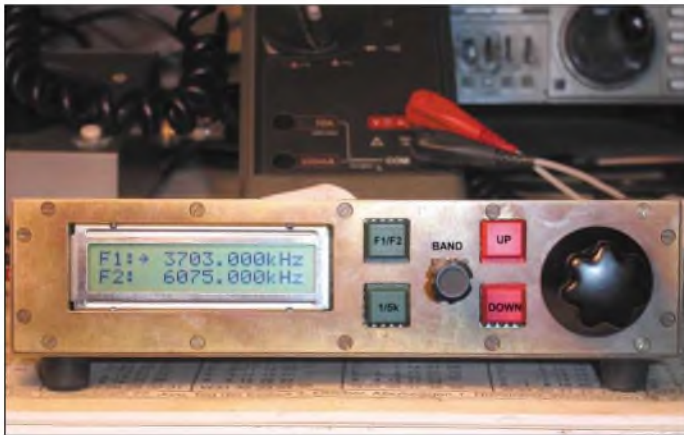
Bild 1: Testaufbau für AD9954-DDS, Frontansicht mit LCD und Bedienelementen
