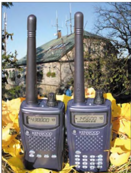
Das Signalgemisch aus Rundfunk-, TV-, Bündelfunk- und BOS-Sendern auf dem 939 m hohen Kösseinegipfel stellt Empfangsteile auf eine harte Probe.
