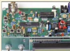
Eine kompakte Einheit aus Haupt- und Bedienplatine ist dieses Gerät, das man zum direkten Empfang von Wetterbildern oder als Nachsetzer beim Konvertereinsatz nutzen kann.
