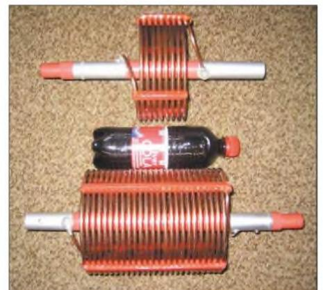
**Bild 5: Luftspulen für 80 und 40 m mit einer Belastbarkeit von 1 kW PEP**
