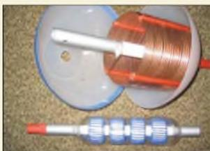
Im Vergleich zu voluminösen Luftspulen stellen auf Ringkerne gewickelte Induktivitäten eine sinnvolle Lösung für Eigenbau-Mobilantennen dar.
