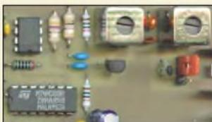
Der PSK31-Empfänger, für den es auch einen Bausatz gibt, basiert auf dem Schaltermischer MAX 4544 (links oben im Bild) und weist dadurch eine beachtliche Großsignalfestigkeit auf.
