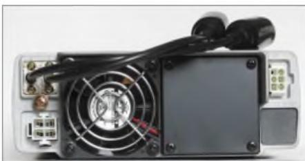
**Bild 7:** Der TS-480SAT braucht, weil er nur über eine HF-Endstufe verfügt, lediglich einen Lüfter und eine Stromversorgungsbuchse. Die entsprechenden Öffnungen wurden einfach abgedeckt. Vielleicht baut dort jemand in Eigenregie die Antennenbuchsen ein?
