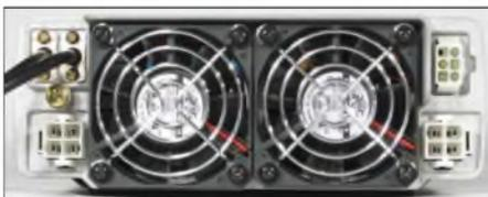
**Bild 6:** Auf der Rückseite des TS-480HX war offenbar wenig Platz. Die beiden Lüfter verbrauchen die meiste Fläche. So reichte es nur noch für die beiden Stromversorgungsbuchsen (s. Text) und einen Anschluss für ein externes Antennenabstimmgerät, aber nicht mehr für zwei Antennenbuchsen. Sie hängen an Kabelschwänzen heraus.
