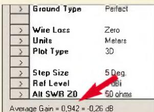
Die Antennensimulationssoftware EZNEC verfügt mit der Anzeige „Average Gain“ über ein Bordmittel, das systembedingte Ungenauigkeiten bei der numerischen Integration der Modellgleichungen aufspürt. Screenshot: DF6SJ
