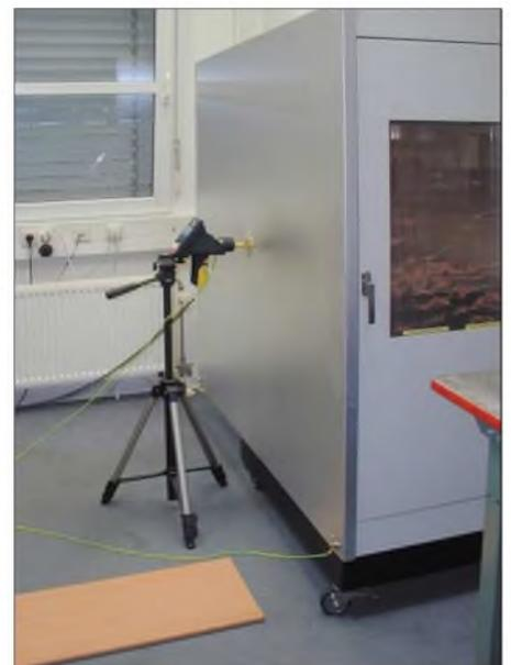
**ESD-Pistolen-Kalibrierung mittels Target und Oszilloskop in einem Faradayschen Käfig**
