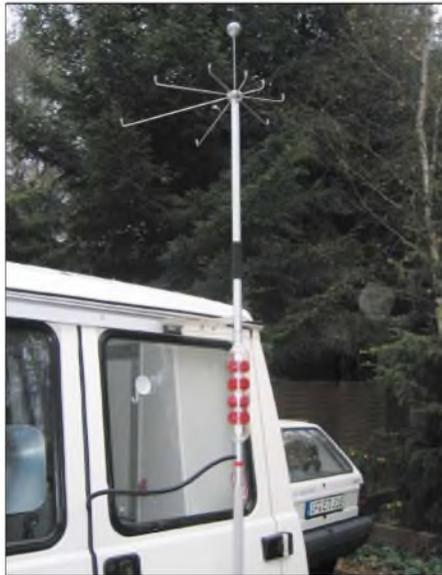
**Bild 4: Konstruktionsbeispiel der Antenne am Heck des Wohnmobils**
