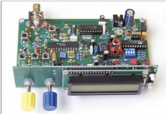
**Bild 1:** Die Grundplatte ist nur 137 mm × 84 mm groß und dient als Montagebasis für die 137 mm × 37 mm messende Anzeige- und Bedienplatte. Durch den kompakten Aufbau entfallen fast alle Verdrahtungsarbeiten.
