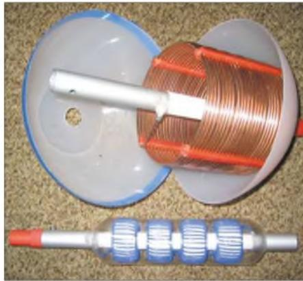
**Bild 7: Größenvergleich der 80-m-Spulen**
