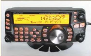
Durch die Trennung Bedienteil – eigentlicher Transceiver eignet sich der TS-480 sehr gut für Mobilbetrieb (im Bild die zugehörige Befestigung). Der TS-480HX schafft hier zudem 200 W aus 13,8 V. Die beleuchtbaren Tasten erleichtern die Bedienung bei Dunkelheit. Foto: TO
