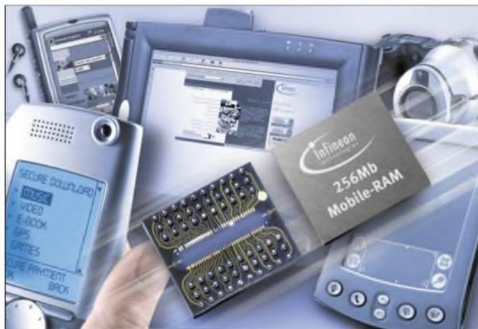
und die benötigte Spannung auf einen möglichst niedrigen Wert reduziert. Von den üblichen 3,3 V, die bisherige DRAM-Schaltkreise benötigen, konnte der Wert bei den neuen mobilen RAMs auf 1,8 bis 2,5 V verkleinert werden.
