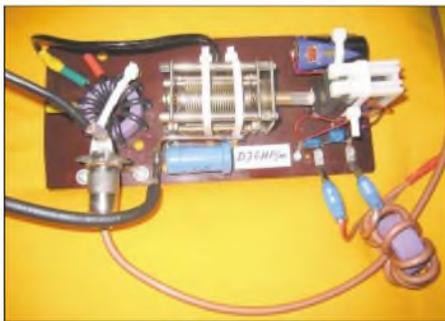
**Bild 1: Schaltungsaufbau der Anpassung inklusive Servomotor**
