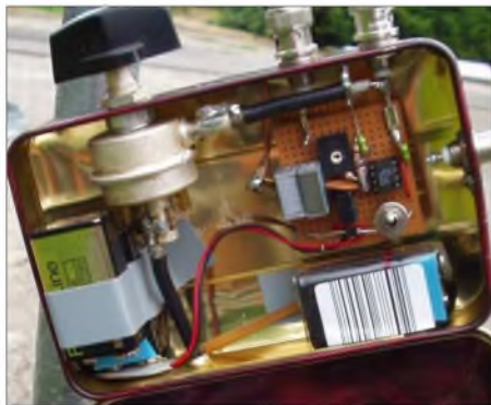
Bild 3: Geöffnete Umschaltbox; links oben ist der koaxiale Abschwächer zu erkennen
