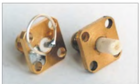
Bild 8: Die verwendeten Proben zur Signaleinkopplung sollten isoliert oder galvanisch mit Masse verbunden sein.
