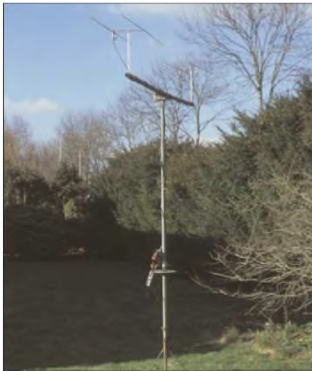
Bild 1: Ansicht der beschriebenen Peileinrichtung mit zweimal HB9CV
