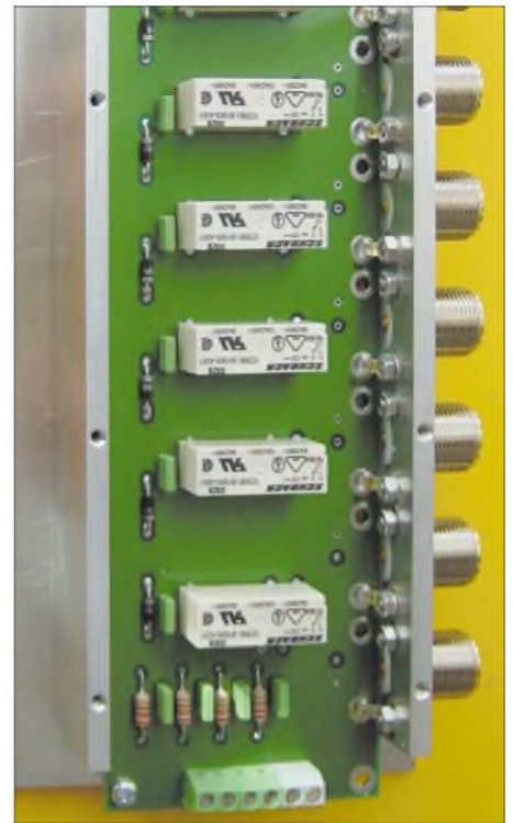
Bild 3: Ansicht der auf einer 222 x 66 mm 2 großen Platine bestückten Umschalteinheit; die Relais von Schrack [1] haben Kontakte mit Goldauflage und schalten 8 A bei 240 V.
