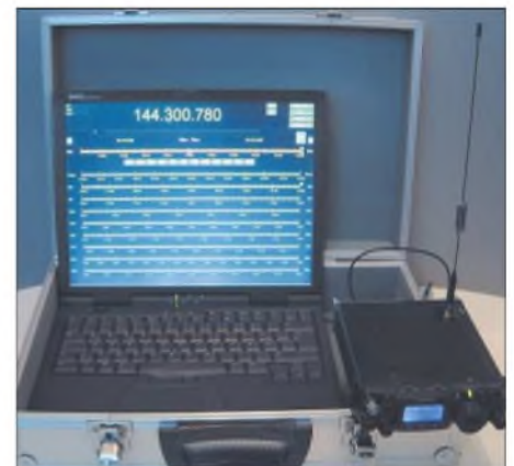
Bild 2: Portabel QRV aus dem Koffer mit Ham Radio Deluxe und Yaesu FT817
