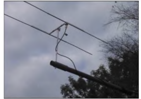
Bild 2: Montage der zerlegbaren HB9CV am Antennenträger
