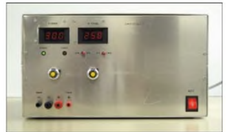
Bild 3: Frontansicht des 25-A-Netzteils mit Anzeigen und Sollwertpotenziometern
