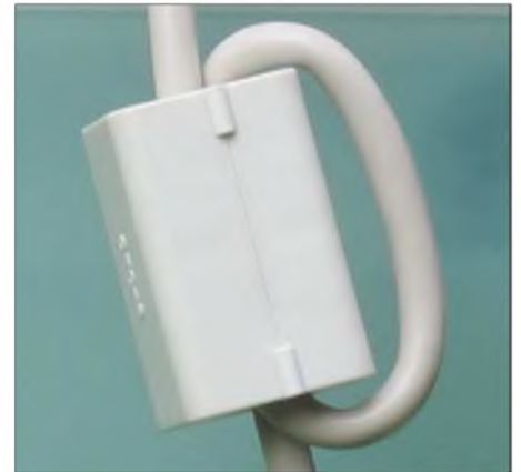
Bild 3: Klappferrit im Einsatz Fotos: DC9ZP
