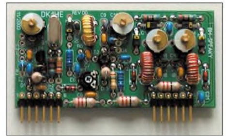
Bild 3: Bis zu fünf solcher Bandmodule kann man im Transceiver einbauen und von der Frontplatte umschalten. Fotos: DK3RED
