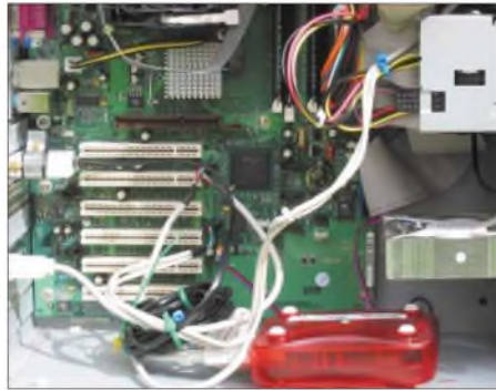
Bild 1: Teil des PC-Innenraums mit einem aus Strahlungsgründen eingebauten, externen Modem.
