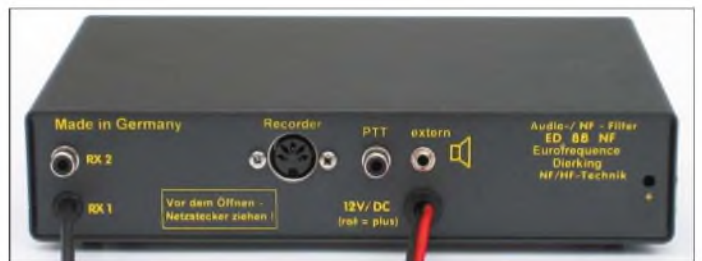
Bild 1: Frontansicht des analogen NF-Filters ED 88 NF von Eurofrequency Dierking NF/HF-Technik
