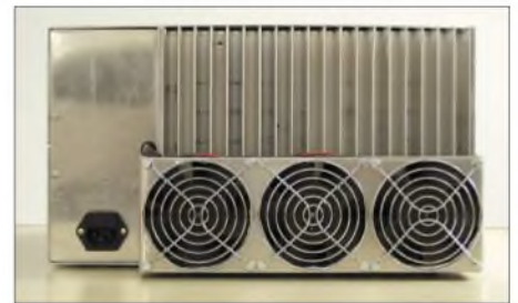
Bild 4: Auf der Rückseite des Netzteils dominieren die drei erforderlichen Lüfter.
