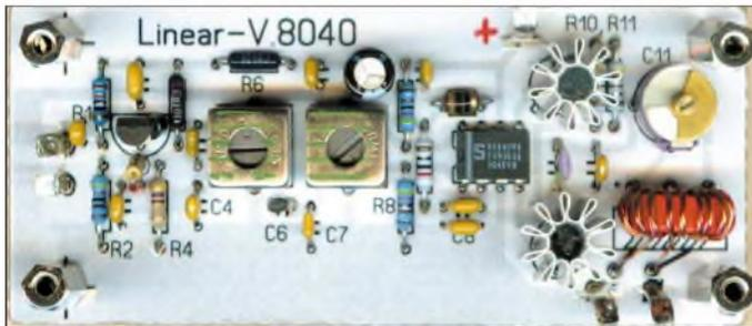
Bild 13: Musterbau des Linearverstärkers
