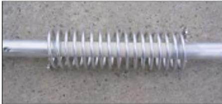
**Bild 1: Luftspule hoher Güte zur elektrischen Verlängerung eines Antennenelements**
