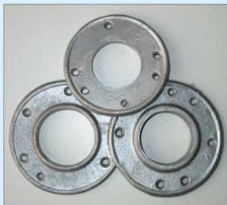
Nach dem sorgfältigen Entgraten eignen sich diese Abspannteller als drehbare Lager für den Teleskopmast.
