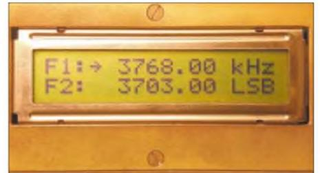
**Bild 2:** Geändertes LCD-Layout mit Seitenbandanzeige
