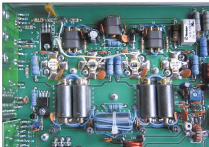
**Bild 5:** Änderungen im Verstärkerteil – die ursprünglich links oben auf der Platine liegenden Dioden *D9* und *D10* sind mechanisch auf den PA-Transistoren zu platzieren. Links oben befindet sich jetzt ein Spindelpotenzimeter anstelle von *R19*.
