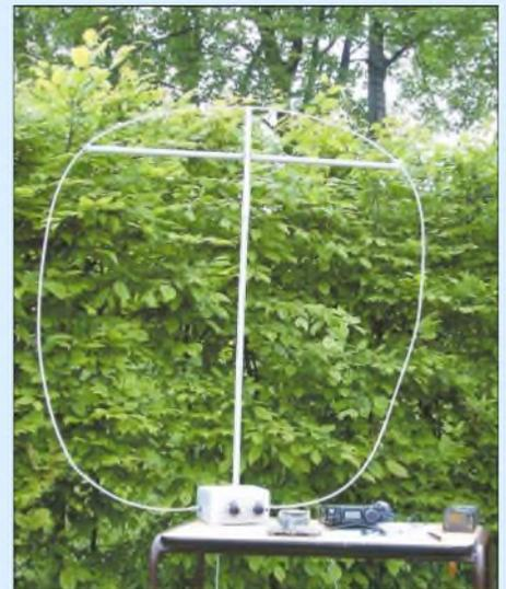
**Bild 3:** Betriebsfertige Portabelausrüstung mit Magnetantenne
