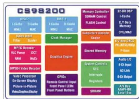
Der DVD-Prozessorchip des CS98200 von Cirrus Logic enthält zwei 180-MHz-RISC-Prozessoren, Video MPEG1-, MPEG2- und DivX/MPEG4-Decoder sowie ebenfalls mit 180 MHz laufende Audio-DSP für Dolby Digital, DTS, MP3, WMA und 8-Kanal-DVD-Audio.
