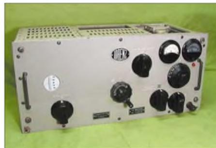
Der Lo 40 K 39d von Lorenz wurde in den 40er Jahren gebaut und bestand aus dem Sender S 23725 und der Netzversorgung RGLE 0.2/2bno. Das Gerät war mit drei Röhren RL 12 P 35 bestückt, verfügte in drei Abschnitten über den Frequenzbereich 3,0 bis 16,667 MHz und hatte eine Ausgangsleistung von 70 W.
