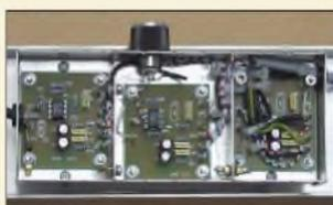
Erscheinen die bisher vorgestellten Gerätevarianten zu groß, so stehen auch für die Ortung nicht so tief liegender unterirdischer Objekte abgerüstete Schaltungen zur Verfügung. Foto: DG9WF
