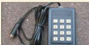
Nur wenige Bauelemente sind zusätzlich zu einem ATMELE erforderlich, um eine Frequenzeingabe-Tastatur für Yaesu Winzlinge aufzubauen. Foto: DH1FAX
