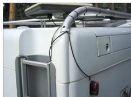
Masseleitungen an allen Ecken: hinten – oben – rechts
