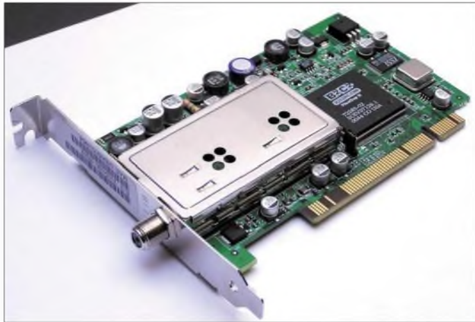
Bild 4: Die zum Wetterbildempfang genutzte DVB-Empfängerkarte TechniSat SkyStar 2 lässt sich in einen freien PCI-Slot einbauen.
