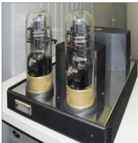
Kronzilla-SD-Röhrenendstufe: MOSFETs treiben die beiden armdicken Audio-Trioden.
