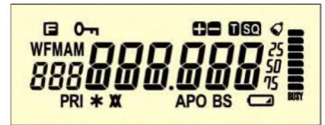
Die Anzeigen und Symbole des Displays. Bei einem Reset erscheinen noch weitere, die das DJ-C7E jedoch nicht nutzt.
