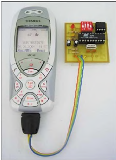
Bild 1: Siemens Handy MC60 in Verbindung mit einem Musteraufbau der Zusatzinheit Handytrack-O
