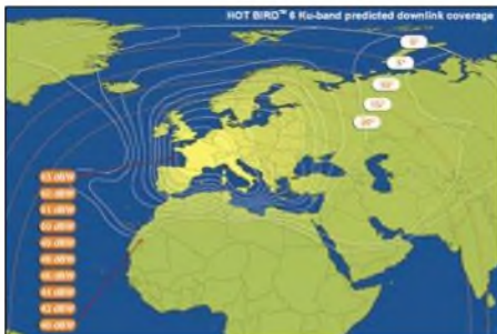
Bild 7: Die vom Meteosat 8 aufgenommenen Bilder sind über den Downlink von Hotbird 6 mit sehr guten Feldstärken in Deutschland empfangbar.
