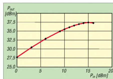
Bild 8: Ausgangsleistung beim Musterexemplar als Funktion des Eingangspegels
