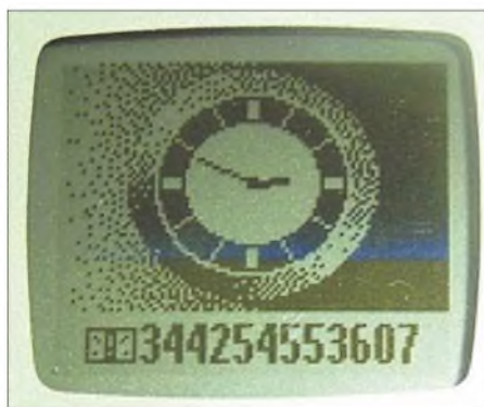
Bild 2: Zwölfstellige Positionsanzeige auf dem Handy-Display im modifizierten Gauß-Krüger-Format; der Rechtswert lautet 3442540, der Hochwert 5536070.
