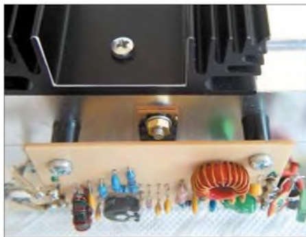
Bild 7: Montagevorschlag für Platine und VMOS-Transistor Fotos: DM2CQL
