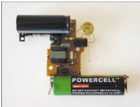
Bild 1: Ansicht der ausgebauten Leiterplatte nach dem Umbau Foto: DK3RED
