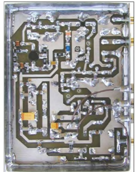
Bild 4: Unterseite eines Prototyps; alle SMD-Bauelemente werden auf der Unterseite der Platine untergebracht. Gegenüber Bild 5 weist die Bestückung des Prototyps geringfügige Unterschiede auf.
