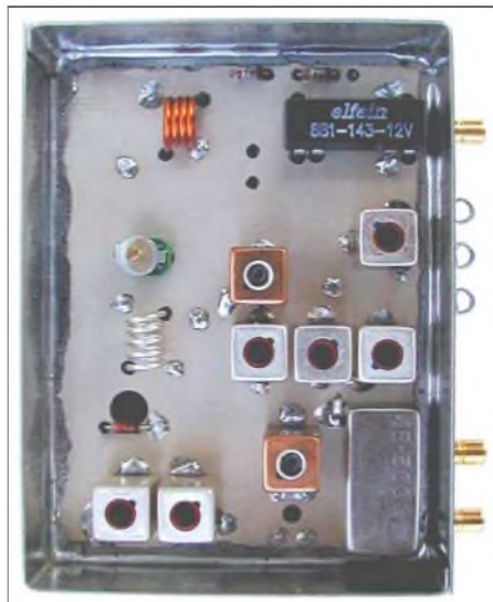
Bild 7: Oberseite des fertig bestückten Frontends im Weißblechgehäuse
