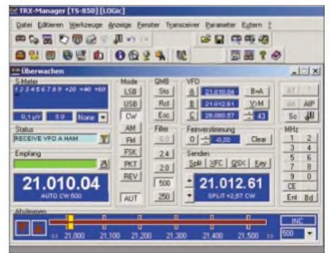
Bild 10: Überwachungsfenster des TRX-Managers für die Transceiver-Steuerung
