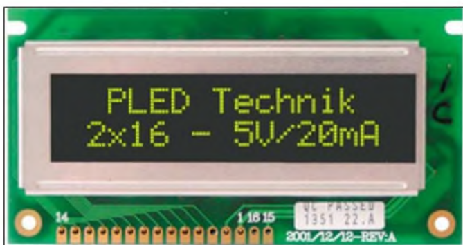
Bild 1: PLEDs werden in den gleichen Bauformen wie LC-Displays angeboten und lassen sich daher wie gewohnt montieren.
