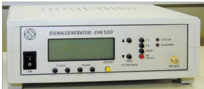
DDS-Signalgenerator mit Netzwerkanalysator bis 500 MHz von Bernd Kaa, DG4RBF – Gesamtsieger im Selbstbauwettbewerb
