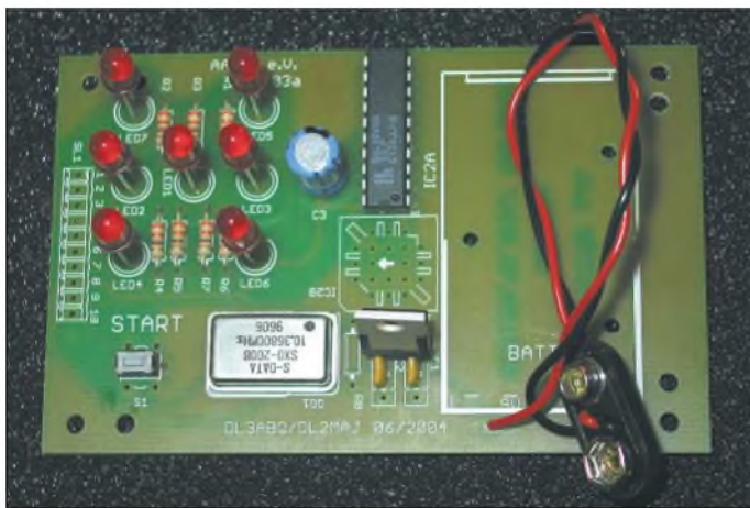
Aufgebaute Platine mit eingelötetem Taster, DIL-GAL und Batterie-Clip, ohne angelötete Winkelsteckerleiste Foto: AATiS
