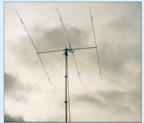
Bild 2: Hoch angebrachte Richtantennen, hier ein Mosley-Beam TA-33JRN für 20, 15 und 10 m, sorgen für eine flache Abstrahlung kurzer Wellen. Foto: DL2RD
