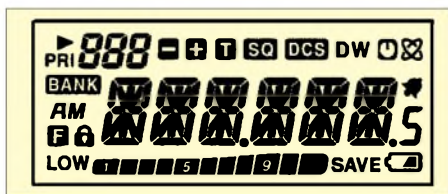
Das Display kann bis zu sechs Zeichen lange Speichernamen anzeigen.
