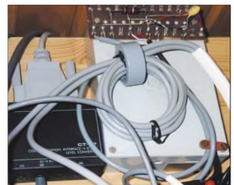
Bild 5: Bestandteil der Messanordnung ist das kommerziell hergestellte OPV-Modul (rechts) Fotos: DJ1YQ
