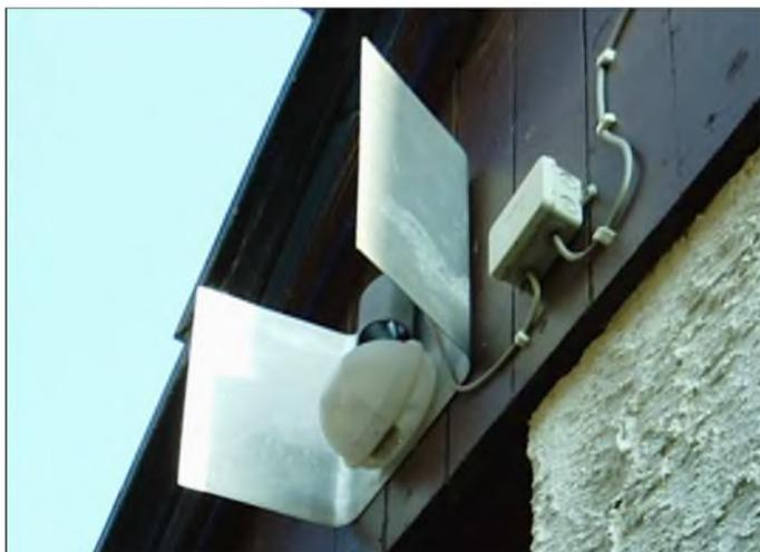
**Bild 14:** Zusammen mit dem Helligkeitssensor TSL250 sind zwei Temperaturfühler am Dachgiebel untergebracht.
