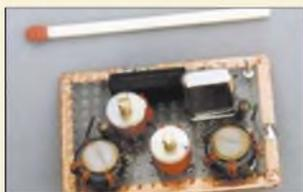
So klein kann ein Eigenbau-CW-Filter sein, wenn man die Ansprüche an die Weitabsektion reduziert, weil die Baugruppe ohnehin einem SSB-Filter nachgeschaltet wird. Foto: DL7HG
