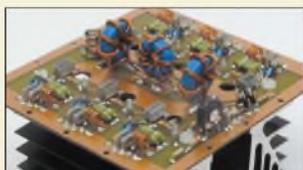
Diese doppelseitig bestückte, nur 12 × 13 cm<sup>2</sup> große Platine beherbergt sechs Power-MOSFETs, mit denen sich 250 W Sendeleistung auf den KW-Bändern erzeugen lassen. Foto: DK6AE
