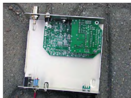
Digital Mosquita für 40 m im Teko CH2-Gehäuse: Es bleibt reichlich Platz für Batteriepack und/oder Antennenanpassgerät. Rechts oben der DDS-VFO. Foto: DL4JAL/2FI
