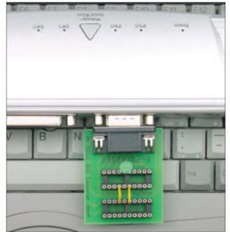
Bild 2: Experimentierplatine an die serielle Schnittstelle stecken und loslegen. USB-RS232-Adapter sind dabei problematisch.
