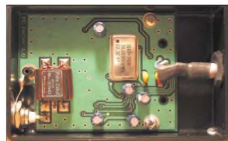
Bild 4: Fertig bestückte Platine, eingebaut in einem Plastikgehäuse
