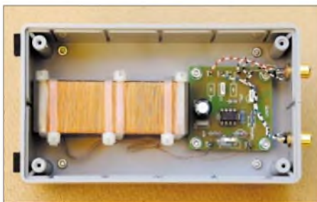
Bild 9: Eine aktive, magnetische Antenneneinheit. Der Kern ist gedämpft befestigt.
