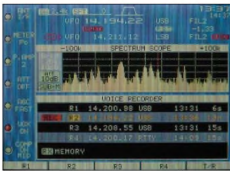
Bild 5: Wichtigste Neuerung auf dem Display ist das Mini-Scope, das den unteren Displaybereich für andere wichtige Einstellungen frei macht (vgl. Bild 1).
