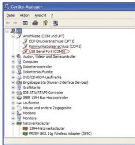
Bild 4: So in etwa stellt sich der erfolgreich installierte virtuelle COM-Port im Geräte-manager von Windows dar.
