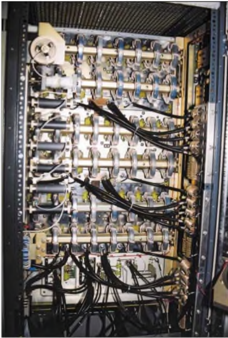
Rückansicht eines 19-Zoll-Gestells mit 48 Ringkern-Spulen zur Auskopplung
