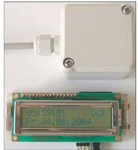
Bild 6: LC-Display und DCF77-Empfänger sind fertig für den Einbau bzw. die Montage
