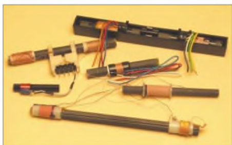
Bild 1: Verschiedene bewickelte Ferritantennenstäbe. Bei den Typen mit zwei Wicklungen handelt es sich um MW- und LW-Kombinationsantennen. Die kleine Antenne links ist auf den Sender DCF77 abgestimmt. Bei dem unteren Ferritstab handelt es sich um eine gefiederte Ausführung.
