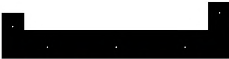
Bild 12: Die Montageschablone ist aus einer 100 mm \times 25 mm großen Platine herzustellen, M1:1.
