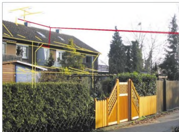
Bild 3: Umgebung der FD3-Antenne (rot) bei DJ3GE; gelb eingezeichnet: weitere metallische Leiter
