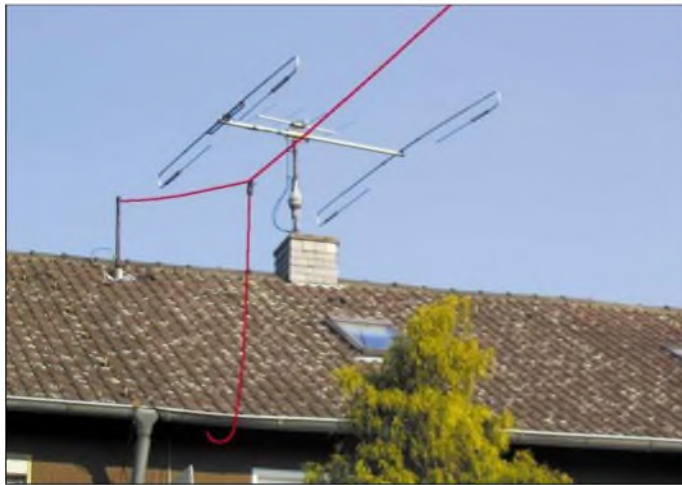
Bild 1: Die nur 21 m lange FD-3-Antenne (hier rot hervorgehoben) wird auf 160 m erregt und erweist sich zumindest für Europa-Verkehr als brauchbar.
