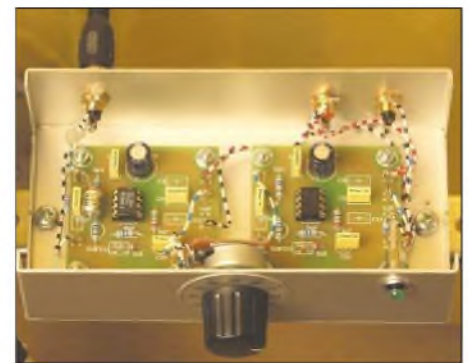
Bild 20: Innenansicht des Antennenverstärkers. Durch die Aufteilung der unterschiedlichen Verstärkungsfaktoren (5- und 30fach) kann die Antenne sowohl für schwache Signale eingestellt werden, sie lässt sich aber auch für den Empfang der hohen Amplituden von Blitzferics verwenden.
