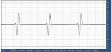
Bild 21: Signale einer Ferritantenne bei starker Bedämpfung – es erfolgt eine reale Wiedergabe.
