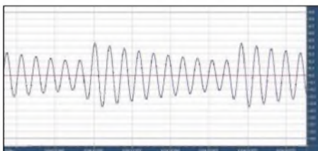
Bild 23: Signale einer Ferritantenne bei schwacher Bedämpfung – die ursprüngliche Impulsform ist nicht mehr zu erkennen.
