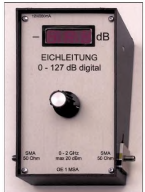
Bild 1: Die kommerziell hergestellte Dämpfungsgliederung wird mit der Steuerung in einem Pultgehäuse untergebracht. Sie lässt sich so ohne Schalt- und Rechenfehler bedienen.
