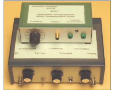
Bild 25: Zwei kleine Hilfsgeräte, die das Experimentieren mit den Ferritantennen enorm erleichtern. [12] beinhaltet eine genaue Beschreibung des PZGs (unten), mit dem die notwendige Spulenbedämpfung zur unverfälschten Übertragung festgestellt werden kann. Fotos und Screenshots: DG9WF
