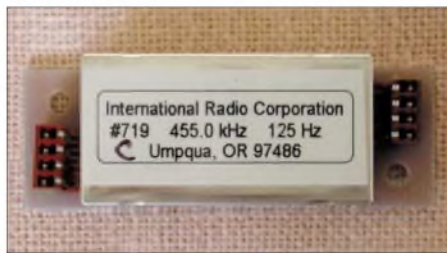
Bild 3: Inrad-CW-Filter; f_m = 455 kHz, B = 125 Hz, S = 2,2 Fotos: DJ2EV
