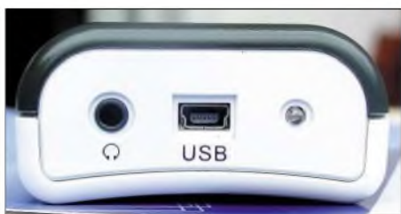
Bild 3: Die Anschlüsse für Kopfhörer und USB-Kabel sind gut auf der Vorderseite des DRM World Travellers zugänglich – rechts ist die Betriebsanzeige-LED zu sehen.
