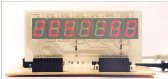
Bild 1: Die LED-Anzeigeplatine wird direkt auf die Leiterplatte des 200-MHz-Zählers gesteckt, wodurch Verdrahtungsarbeiten entfallen.
