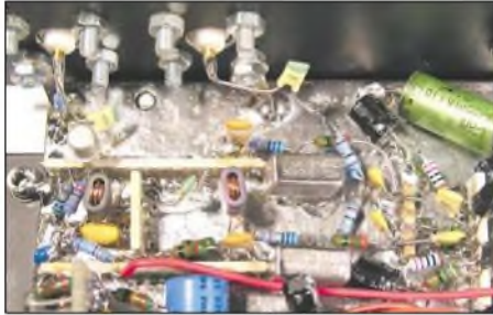
Bild 8: Detailansicht des Quadratur-Hybrids im Mustergerät Fotos: DL7MAJ
