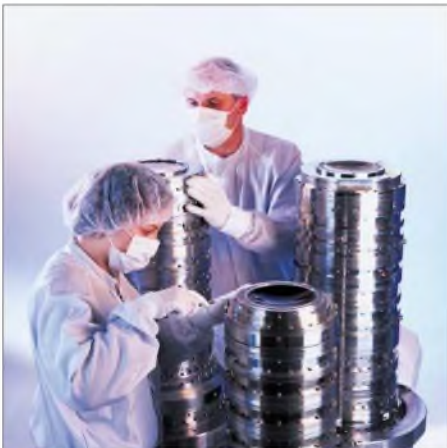
Bild 1: Optik von heute – ein solches Objektiv enthält bis zu 30 Linsen höchster Güte und projiziert das Chiplayout bei einem Verkleinerungsfaktor von Vier auf das Substrat.
