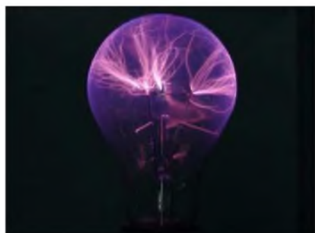
Bild 1: Eine 200-W-Glühlampe kann auch als Plasmakugel dienen.
