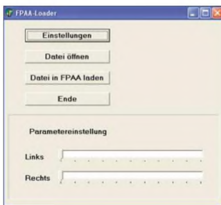
Bild 16: Die PC-Demosoftware erlaubt die Verstärkungseinstellung für zwei Kanäle.
