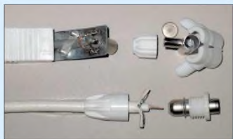
Bild 1: Abisolierung eines 75-Ω-TV-Kabels für die Klemmmontage in einem schraubenlosen Stecker (unten); darüber: IEC-Steckverbinder mit Schraubmontage Foto: DL2RD
