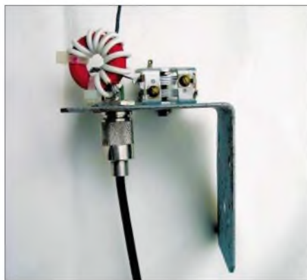
Bild 6: Fuchskreis mit Befestigungswinkel; Spulendaten siehe Text
