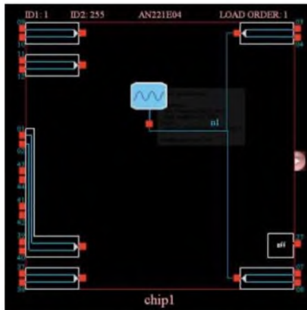
Bild 15: Diese Schaltung realisiert einen Generator, der seine Frequenz in Stufen von 1 kHz ändert.
