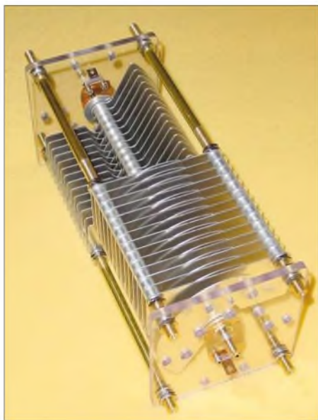
Bild 7: Doppeldrehkondensator zweimal 230 pF/4 kV Fotos: DK7ZB
