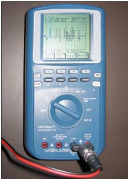
Bild 1: Der Displayinhalt des DMM 750 lässt sich dank eines kleinen Programms auf Knopfdruck im PC speichern.
