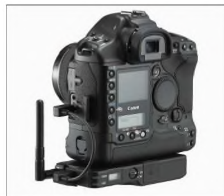
Computer mit eingebauter Spiegelreflexkamera: die Canon EOS-1Ds Mark II mit WLAN-Funkanlage Werkfotos
