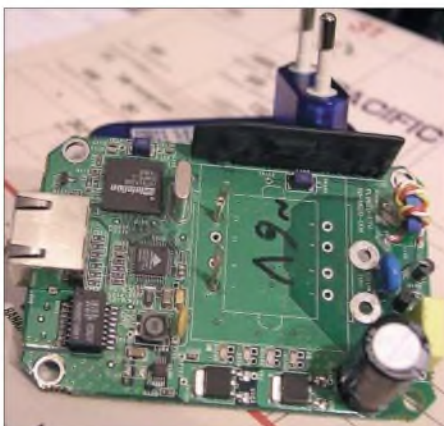
Bild 4: Innenansicht des PLC-Modems von Devolo Fotos: OE3MZC
