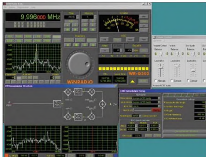
Bild 6: Der Professional Demodulator und seine Einstellmöglichkeiten
