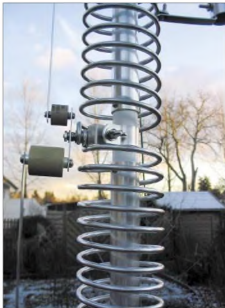
Bild 4: Detail Spulen mit Kondensatoren für 80 und 40 m
