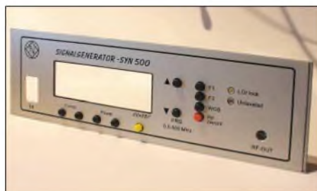
Bild 14: Fertig belichtete Alucorex-Frontplatte mit bereits montierten Tastern
