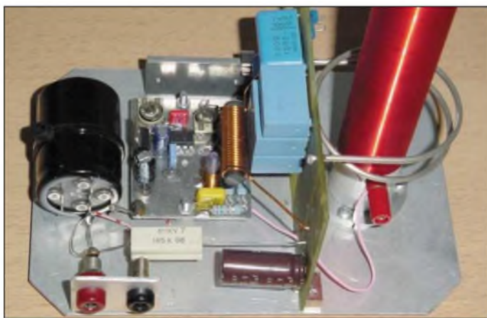
Bild 9: Detailansicht des Primärkreises beim Mini-Tesla
