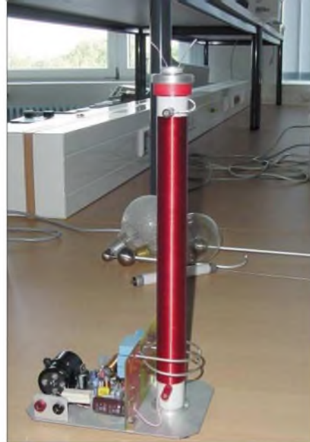
Bild 10: Nach dem Anschluss einer 30-V-Spannung ist der kleine Tesla-Transformator für die HF-Vorführung bereit. Fotos: DB1NV
