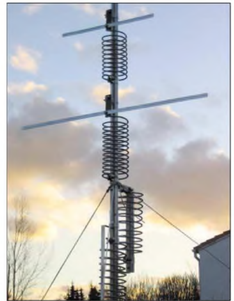
Bild 6: Spulen für 12 m und 17 m mit Dachkapazität Fotos: DL3VL
