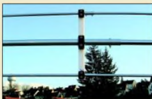
Nahaufnahme der bei der OB11-5 angewandten Spreizertechnik: So werden die 12- und 17-m- Parasitärelemente an die 20-m- Elemente angekoppelt. Foto: DF2BO
