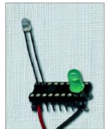
Bild 10: Konstantstromquelle nach Bild 9 zur Auswahl vorhandener LEDs; die am Gehäuse kurzgeschlossene grüne LED dient als Umschaltstecker. Fotos: DF6GF
