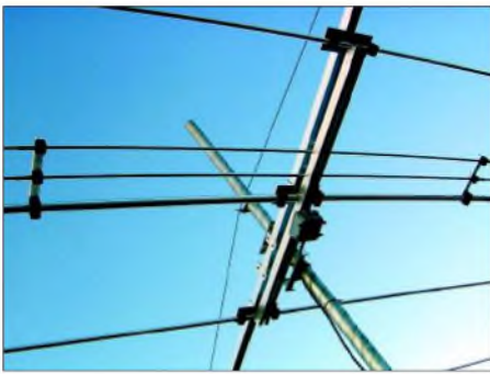
Bild 2: Strahlerzelle, von unten aufgenommen; erkennbar sind auch die Spreizer, mittels derer die 12- und 17-m-Parasitärelemente an die 20-m-Elemente gekoppelt werden.
