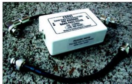
Bild 1: Flugfunk-Bandpassfilter mit Druckgussgehäuse und BNC-Buchsen Foto: Autor
