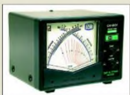
Stehwellenmessgeräte CN-801H (links) für 1,8 bis 200 MHz sowie CN-103L für 140 bis 525 MHz
