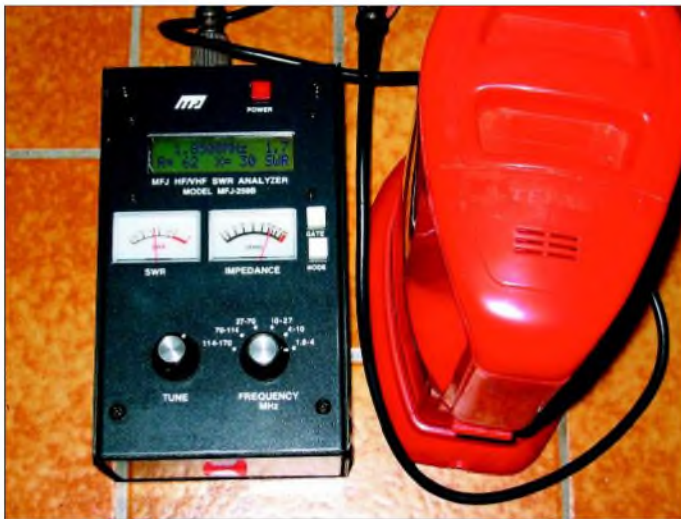
Gar nicht so schlecht für einen Wasserkocher – Stehwellenverhältnis s = 1,7 auf 160 m!
