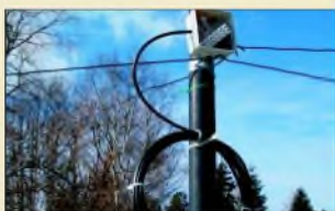
Die beschriebene Zweibandantenne weist bis auf die hier gezeigte Mantelwellensperre keine Induk- tivitäten auf und ist daher schnell aufzubauen. Foto: DL2RD
