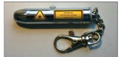
Bild 2: Laserpointer älterer Bauart gemäß Laserklasse 3A, heute nicht mehr zugelassen Foto: DL7UHU
