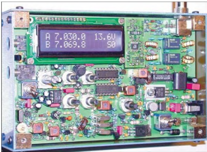
Bild 1: Blick auf die bestückte Platine eines Mustergeräts; das Display zeigt: VFO A, VFO B, S-Meter, Telegrafiegeschwindigkeit, Spannung des Akkus, Sendeleistung, SWV.
