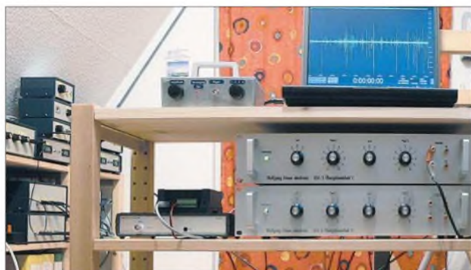
Bild 23: SEA3 im praktischen Einsatz; links neben dem Laptop befindet sich ein Antennenanpassverstärker.
