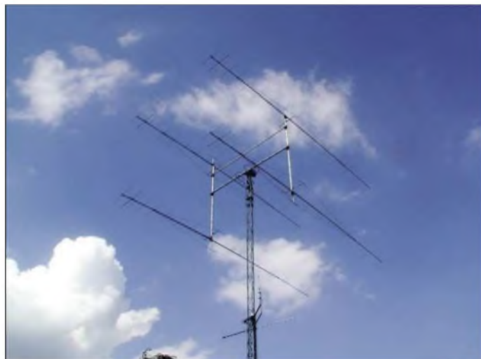
Die von Alfred, DL9GS, genutzte 4 x 17-Element-Antennengruppe auf einem Firmengelände in Bochum – prima Standort ohne TVI-Sorgen.
