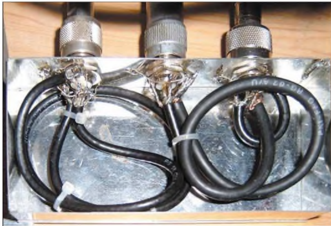
Bild 1: Ansicht des aufgebauten Prototyps bei geöffnetem Deckel; es finden hier einzelne Stücke RG58C/U und RG62A/U Verwendung.
