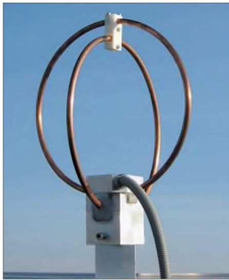
Bild 16: Die Signale der um 90° versetzten Antennenwicklungen werden bei LMU zur Berechnung des Einfallswinkels verwendet.
