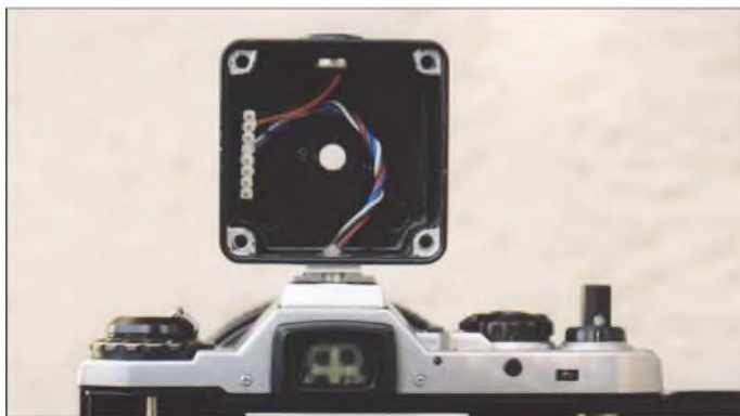
Bild 10: Das Sendergehäuse ist an die Stelle des Blitzschuhs auf der Kamera zu montieren und festzuschrauben.
