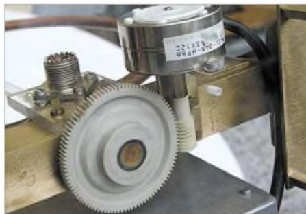
Bild 5: Durch Vorschalten eines Getriebes lassen sich Kraft und Präzision eines Schrittmotors noch beträchtlich erhöhen.
