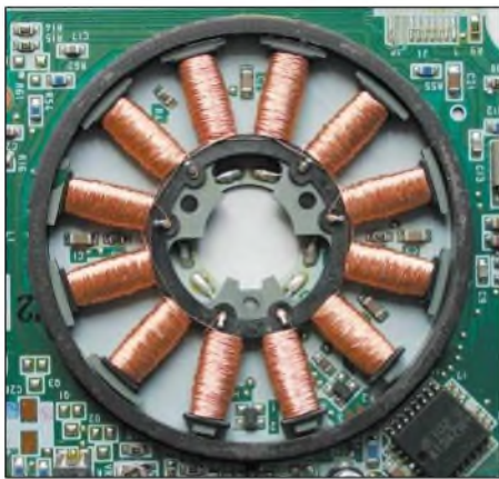
Bild 1: Blick in den Schrittmotor eines Diskettenlaufwerks; Im sich drehenden Deckel war der ringförmige Magnet befestigt.
