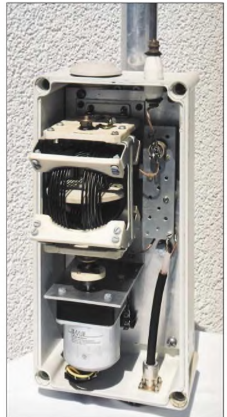
Bild 3: Innenansicht des Antennenkopplers, links unten Synchronmotor mit aufgeflasschem Reduktionsgetriebe, darüber die flexible, keramische Kupplung; links oben das Variometer, rechts davon das Lochblech für die Kondensatoren. Fotos: HB9PL
