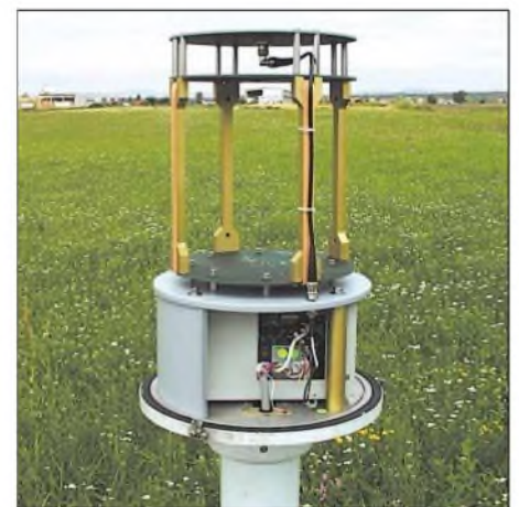
Bild 17: Geöffneter IMPACT-Sensor des Blitzortungssystems von ALDIS
