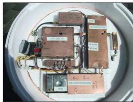
Die Montageplatte mit Sender, Transponder und Ablaufsteuerung
