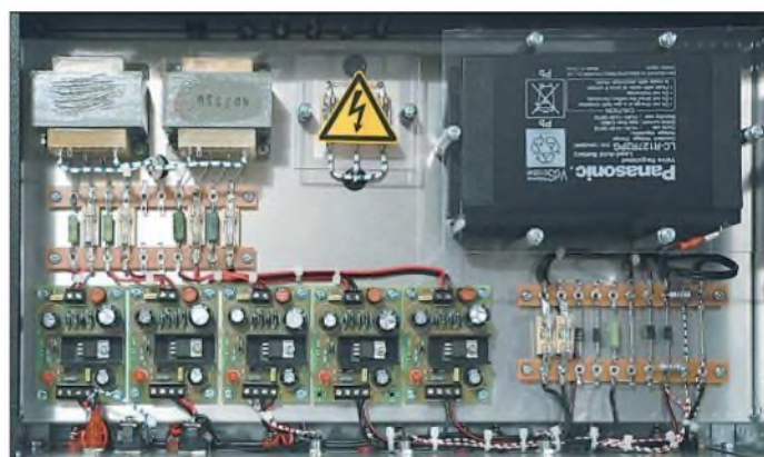
Bild 21: Blick in die Übergabeeinheit des SEA3 zur Vervielfältigung und Pufferung der Signale der Antennenanpassverstärker
