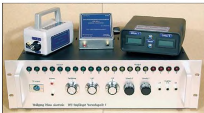
Bild 11: Dieser selbst gebaute DFE-Versuchsempfänger registriert Signale, die teilweise schon im Vorfeld von Gewittern im LW- bzw. MW-Bereich ausgesendet werden. In der Mitte oben befindet sich der Antennenanpassverstärker.
