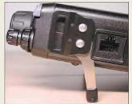
Dieses praktische Stützbein „Peg Leg“ für FT-817 ist als Komplettbausatz mit lasergeschnittenen Füßen und V2A-Schrauben für 12,50 € erhältlich bei Dieter Engels, DJ6TE, Elchinger Weg 6/2, Tel. (0731) 9266-133, Fax -134; info@palm-radio.de
