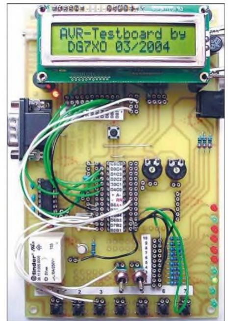
Bild 2: Entwicklungsboard für den ATmega8 im Einsatz
