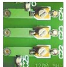
**Bild 12:** Stellung der Trimmer C22 bis C24
