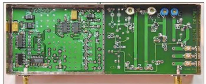
**Bild 2: Blick auf die Unterseite der bestückten Platine**
