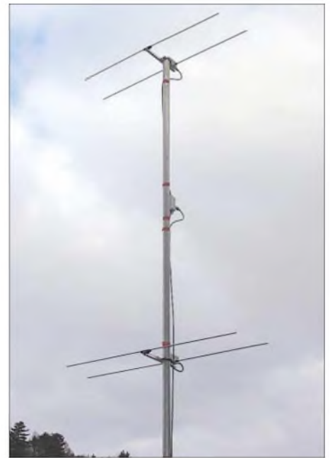
Bild 3: Die Zweiergruppe aus 2 × 28-Ω-Yagis mit Direktor
