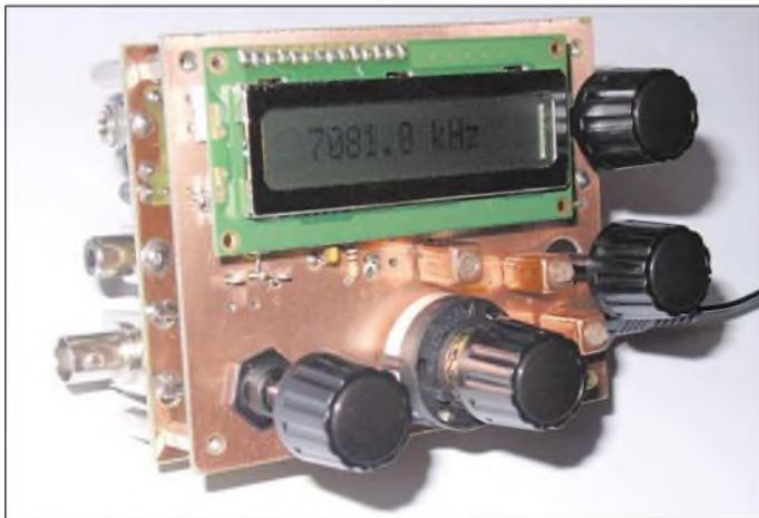
Bild 9: Ansicht der kompletten DRM-Baugruppe mit hinten liegender Empfängerplatine und davor montiertem Oszillator
