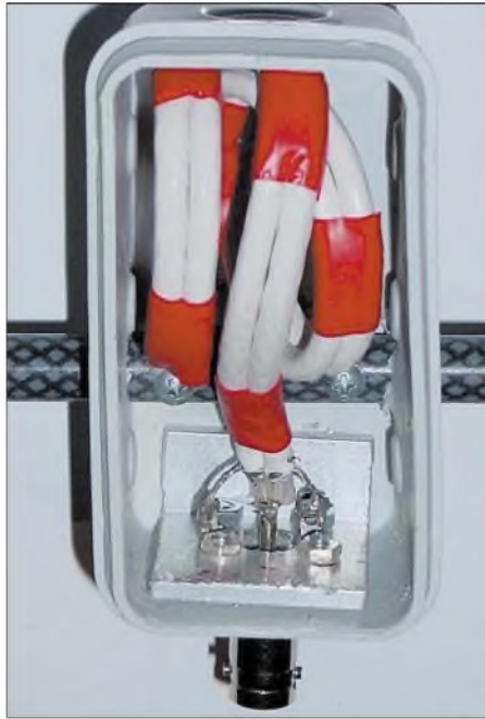
Bild 8: Dose der 28-Ω-Yagi mit 2 x 75-Ω-PE-Kabel
