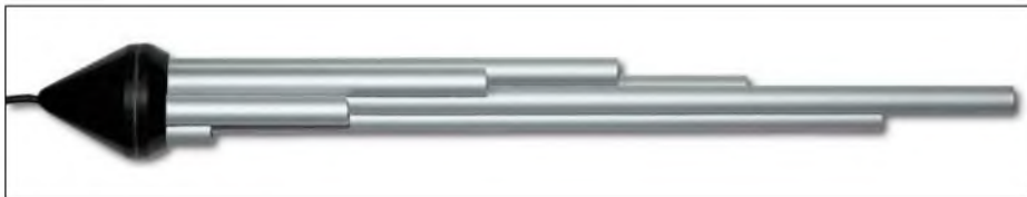
Bild 1: Die Richtwirkung von Mikrofonen lässt sich auch auf rein mechanischem Weg erreichen. Dafür nutzbare Interferenzrohr-Richtmikrofone lassen sich aus dünnen Aluminiumrohren selbst herstellen. Foto: DK3RED
