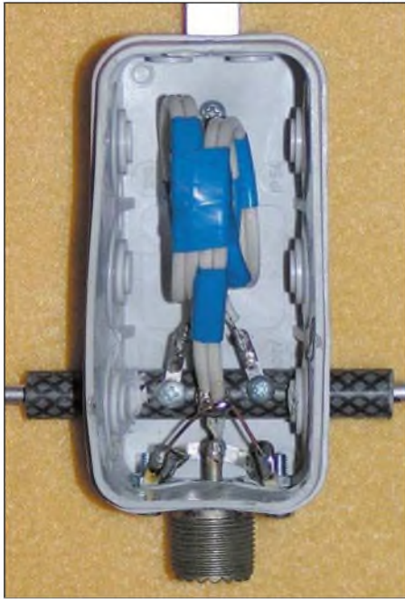
Bild 7: Dose der 12,5-Ω-Yagi mit 2 x 50-Ω-Teflon-Kabel
