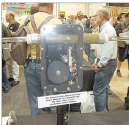
Die Antennen von SteppIR haben Elemente, deren Länge von \mu C-gesteuerten Schrittmotoren angepasst wird, sodass die Einzelstrahler bzw. Yagis zwischen 13 und 54 MHz arbeiten.
