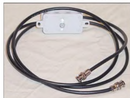
Bild 12: Das Aufstock-Kabel mit zweimal 103,5 cm RG59B/U Fotos: DK7ZB
