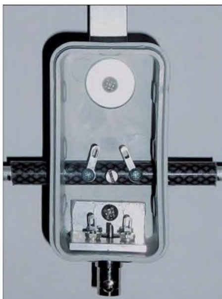
Bild 11: Dose vor Einbau der Transformationsleitungen
