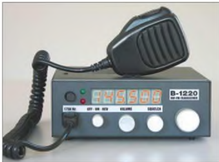
Bild 1: Das schlichte, aber fertig bearbeitete Gehäuse ist 167 mm x 148 mm x 61 mm groß.
