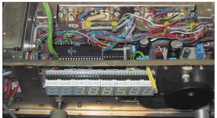
Bild 2: Nach der Modifikation befinden sich rechts oben am Display der Fototransistor und daneben der Drehgeber.
