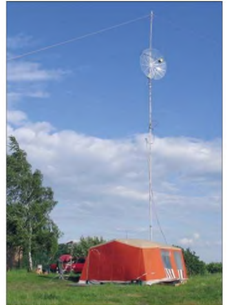
DF0YY: Der Monoband-23-cm-Gitterspiegel nach PA4FP. Der Durchmesser beträgt 1,90 m. Damit gelangen 64 QSOs im Juni-Contest bei einem ODX (im Regen) mit G3XDY. Foto: DL7AKX
