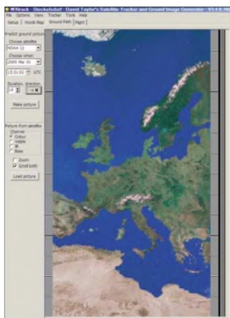
Bild 2: Um zu sehen, ob der ausgewählte Satellit bei seinem Überflug auch den erhofften Ausschnitt aufnehmen kann, ist in WXTrack anhand der eingegebenen Standort- und der Kepler-Daten eine Kartenansicht erstellbar.
