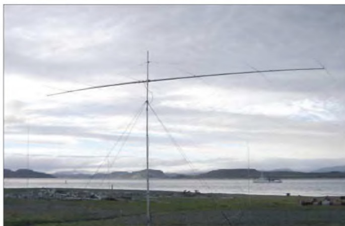
Die 6-m-Langyagi, mit der einige EME-QSOs gelangen. Im Hintergrund weitere Vertikalantennen für Kurzwelle sowie die in der Bucht vor Anker liegende „Braveheart“
