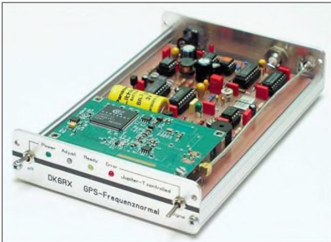
**Bild 1:** Die letzte Version einer der vielen Prototypen, die bei der Entwicklung für Tests und für die Optimierung des Frequenznormals aufgebaut wurde.
