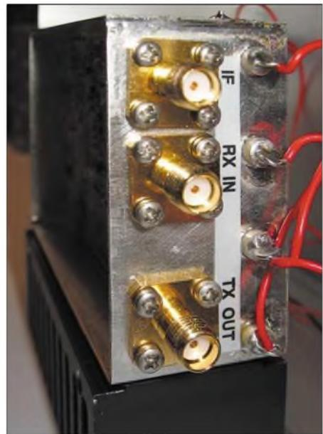
**Bild 14: SMA-Buchsen und Durchführungskondensatoren an der Außenseite**
