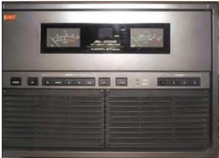
**Bild 1:** Die JRL 2000-F vor dem Umbau – in der oberen Hälfte der Frontplatte befindet sich das Display-/Switchpanel.
