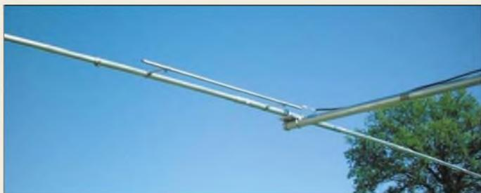
**Schnellen DX-Erfolg auf 20 m verspricht diese leicht aufzubauende HB9CV.**
