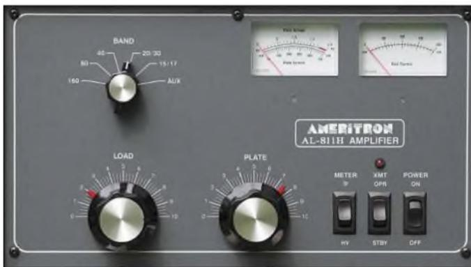
Bild 1: Frontansicht der AL-811HXCE – oben rechts das Instrument für Gitterstrom, links daneben jenes für Anodenstrom/-spannung; links oben der Bandschalter, darunter die Regler für den Anodenkreis
