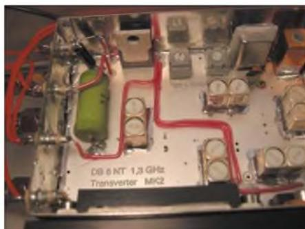
**Bild 10: Transvertermodul mit eingelöteten Durchführungskondensatoren**
