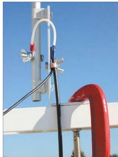
**Bild 1:** Montage und Einspeisung; das Radial geht schräg nach links unten weg. Mit der Schraubzwinge wird die Antenne befestigt.
