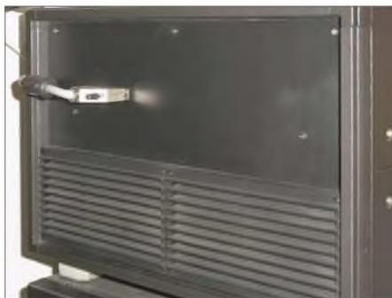
**Bild 2:** Ein lackiertes Blech mit Sub-D25-Buchse deckt die Frontseite nach dem Umbau ab.
