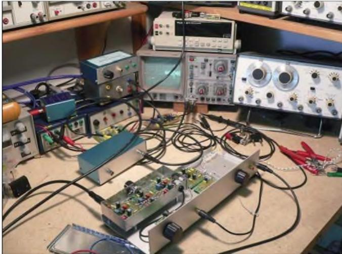
Der Versuchsaufbau der Schaltungsapplikation wurde auf einem Winkelblech realisiert. Die drei in Reihe geschalteten selektiven Filter finden dabei in einem aufmontierten abgeschirmten Weißblechgehäuse Platz (hier Deckel geöffnet). Vorn erkennt man die Einstellknöpfe für die Ausgänge „Träger“ und „NF“. Rückseitig befindet sich das Pegel-Potenzio-meter für die Filter.
