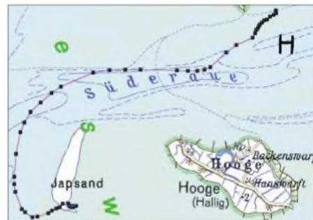
Auf dieser Route driftete die Boje von ihrem Aussetzungspunkt südlich der Insel Langeneß bis zum Auflanden auf dem Japsand nach nur siebeneinhalb Stunden. Alle Systeme an Bord funktionierten einwandfrei, sodass die Boje bis zum Zusammenbrechen der Akkumulatorspannung nach zehn Tagen verstummte. Karte: AATiS
