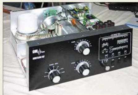
**Power von OM-Power aus der Slowakei: Die KW-PA OM2500 HF wiegt komplett mit Netzteil 38 kg und leistet mit einer GU-84 2,5 kW – weit oberhalb des hierzulande Zulässigen.**
