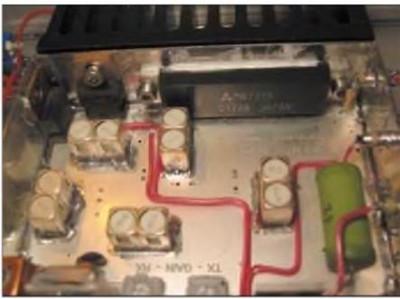
**Bild 12: Bestückungsseite der Platine, oben das montierte Endstufenmodul**
