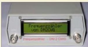
Die zugeführten Frequenzen zweier Kanäle lassen sich mit diesem auf einem AVR-Mikrocontroller basierenden Zähler messen, mit einem Offset verrechnen und komfortabel via LC-Display anzeigen. Foto: DM2CWG
