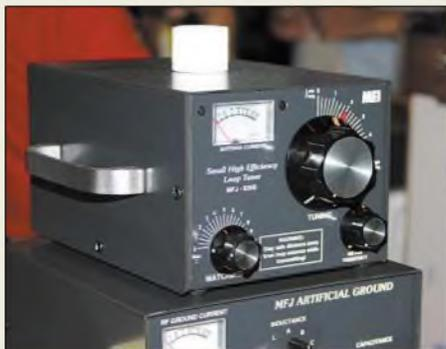
**Antennenkoppler von MFJ, vom kleinen Loop-Tuner MFJ-935, bis hin zum vollsymmetrisch aufgebauten 1,5-kW-Boliden MFJ-976, waren bei Classic International zu bekommen.**
