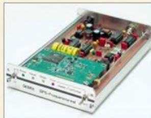
Eine hochgenaue Frequenzreferenz ist besonders für Eigenentwicklungen und Funkbetrieb im VHF-, UHF- bzw. SHF-Bereich notwendig, aber auch für den KW-Amateur gewinnbringend einsetzbar. In dieser Bauanleitung gelangt ein kommerzielles GPS-Modul zum Einsatz.
