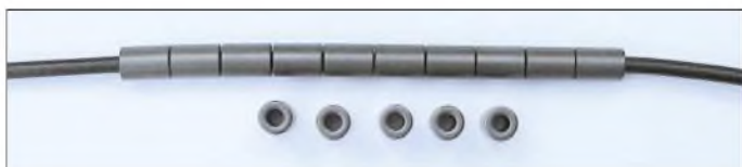
Bild 2: Ferroxcube-Ferritkerne auf RG58CU aufgezogen
