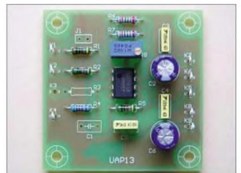
Bild 14: Platine UAP13 als Zweifach-Summierverstärker beschaltet
