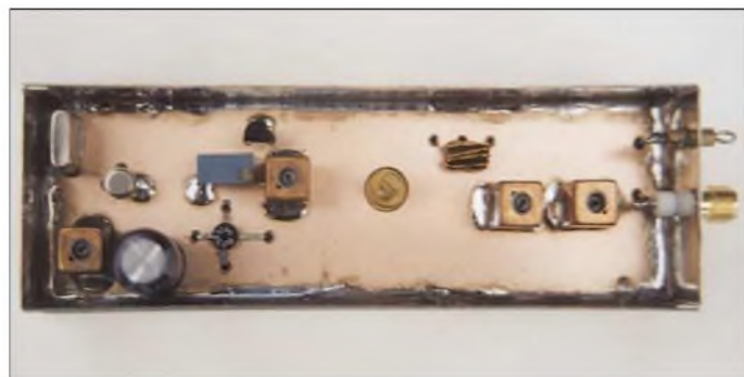
Bild 10: Quarzoszillator 116 MHz für 2-m-Transverter mit High-Level- Ringmischer [10]
