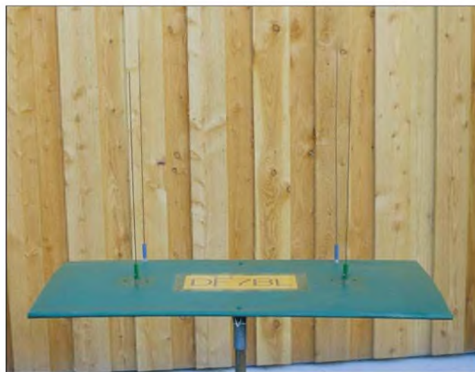
Bild 1: Ansicht der aufgebauten Peileinrichtung für das 2-m-Band
