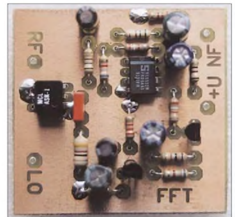
Bild 3: Eine betriebsbereite Baugruppe Basisbandkonverter (ohne Gehäuse)
