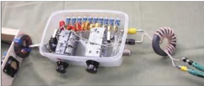
Bild 8: L-Antennenkoppler in Tiefpassschaltung, asymmetrische Ausführung, mit Stromdetektor im Eingang und Strombalun im Ausgang Fotos: DL3AO
