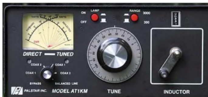
Bild 1: Vorderseite des Tuners, man beachte die Übersichtlichkeit des Geräts und den großen Einstellknopf mit Vernierskala.
