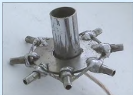
Bild 4: Der Halter für die Dachkapazität besteht aus Gewindenippeln und einer großen Unterlegscheibe. Fotos: DC1ZD (5)
