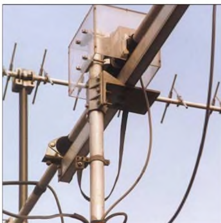
Bild 13: Vertikalrotor mit Schutzgehäuse und Masseband gegen statische Aufladung
