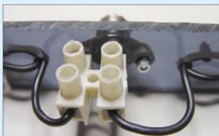
Bild 8: Die Lüsterklemme dient zur Kontaktierung der beiden Dipolschenkel.
