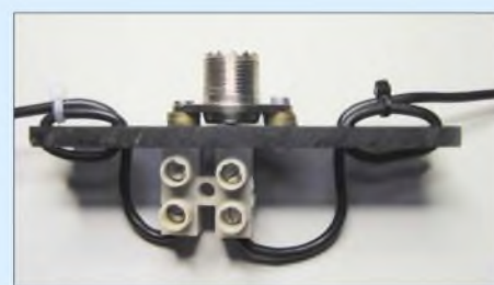
Bild 10: Mit Kabelbindern gesicherte Drahtschlaufen dienen der Zugentlastung des Dipols am Speisepunkt. Fotos: DG4VX (5)
