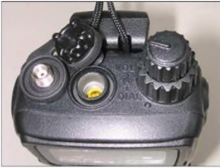
Auf der Oberseite fällt insbesondere die mittels Schraubverschluss abgedichtete, tief versenkte NF-Anschlussbuchse auf.
