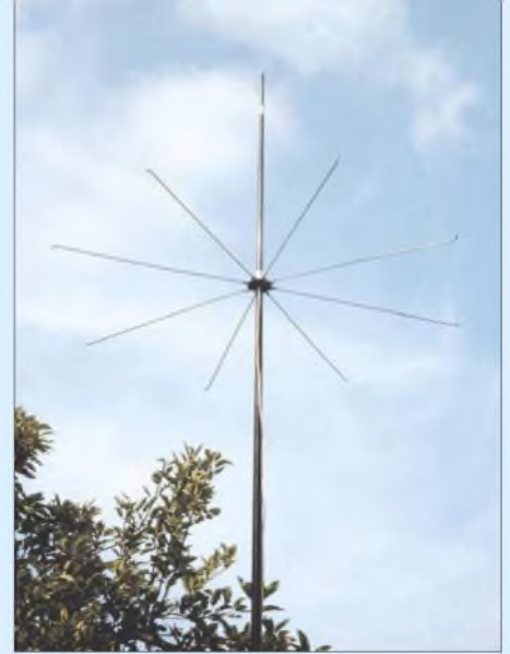
Bild 2: Die Dachkapazität ist eine sternförmige Anordnung aus Fahrradspeichen.
