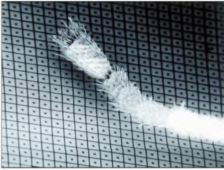
Größenvergleich der Spiegel eines DLP-Chips mit einem Ameisenbein
