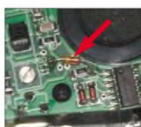
Bild 2: Über die Trennstelle lötet man anschließend eine beliebige Siliziumdiode.
