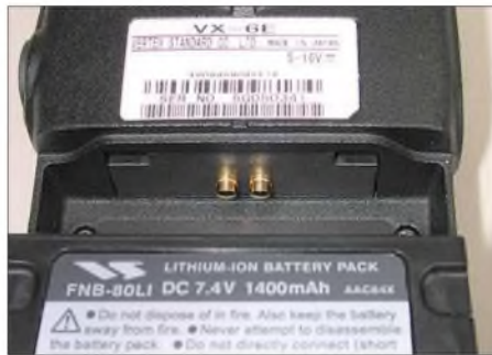
Massive Stiftkontakte verkräften die bis zu 1,8 A Stromaufnahme beim Senden problemlos.
