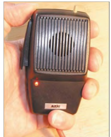
Bild 2: Modifiziertes CB-Mikrofon, rechts oben der Taster zum Start des Aktivsuchlaufes; deutlich zu sehen ist die rote LED zur Funktionsanzeige.
