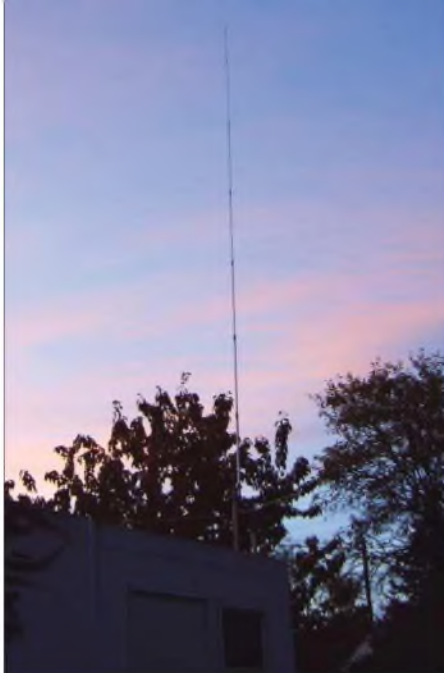
Die „Wunderantenne“, eine knapp 7 m lange Vertikalantenne, mit Radials sogar auf 80 m brauchbar
