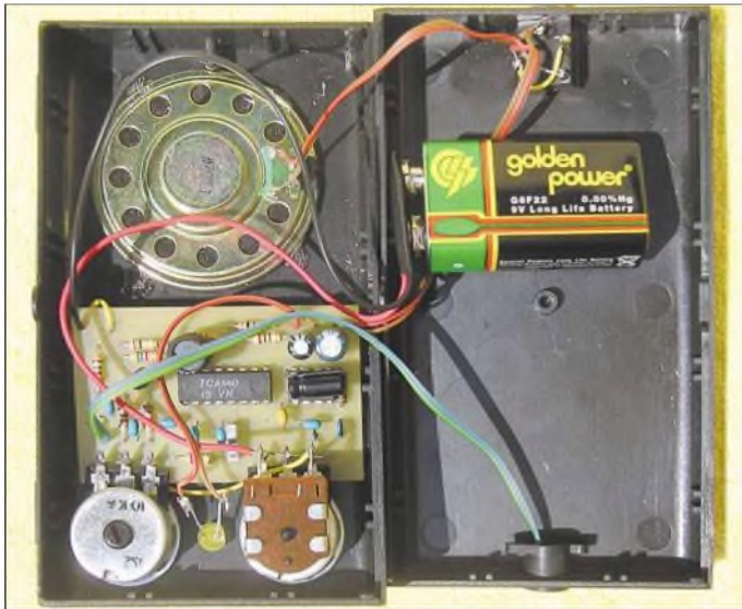
Bild 1: Innenansicht des Direktüberlagerungsempfängers; die Ultraschall-Mikrofonkapsel klebt man in der Stirnseite des Gehäuses fest.
