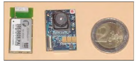
Bild 9: Das in der Mitte zu sehende Kamera-Modul C328 liefert Bilder und Videos im JPG-Format über eine serielle Schnittstelle. Links das fast gleich große ZEBRA-Modul
