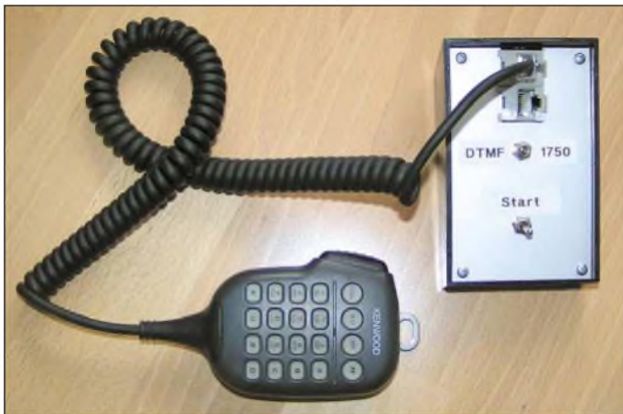
Bild 3: Aufbauvariante als externes Gerät zum Einschleifen in die Mikrofonleitung; alle Mikrofonfunktionen bleiben erhalten.
