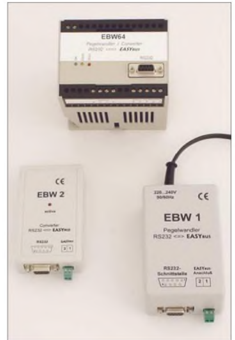
Bild 7: Pegelwandler für das Loggersystem Easy Log der Fa. Greisinger; Sie stellen die Schnittstelle zum PC dar, über die sich die Logger konfigurieren und auslesen lassen.
