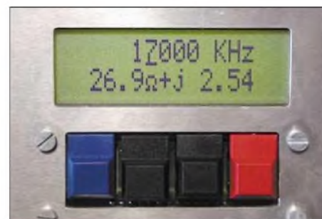
Bild 9: Messergebnis mit aktueller Frequenz, Real- und Imaginärteil
