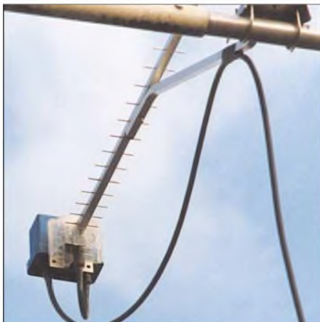
Bild 8: 13-cm-Antenne mit dem direkt dahinter befestigten 2400/144-MHz-Umsetzer
