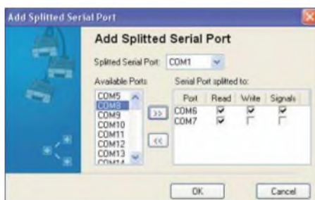
Bild 3: Über den Serial Port Splitter lassen sich alle RS232-Schnittstellen hinzufügen, einstellen und entfernen.
