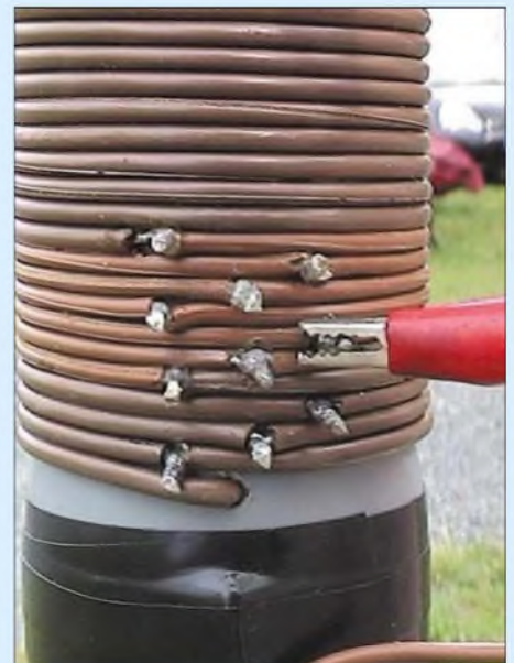
Bild 3: Anzapfungen an der Spule bestimmen die Resonanzfrequenz und ermöglichen auf allen Frequenzen ein SWV von nahezu s = 1 .
