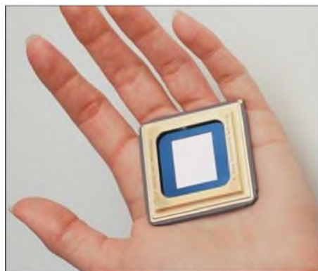
DLP-Chip als bilderzeugendes Bauteil
