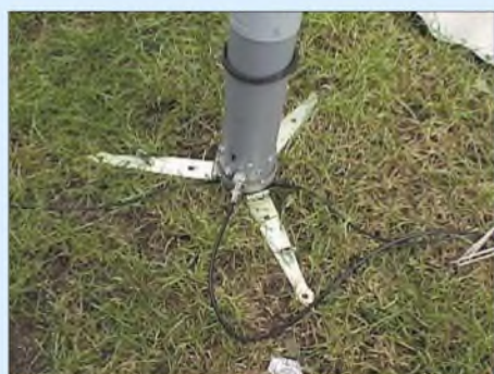
Bild 5: Der Antennenfuß besteht aus HT-Abflussrohren und Türscharnieren aus dem Baumarkt. Er fixiert die Angelrute mithilfe von Zeltnägeln fest am Boden.
