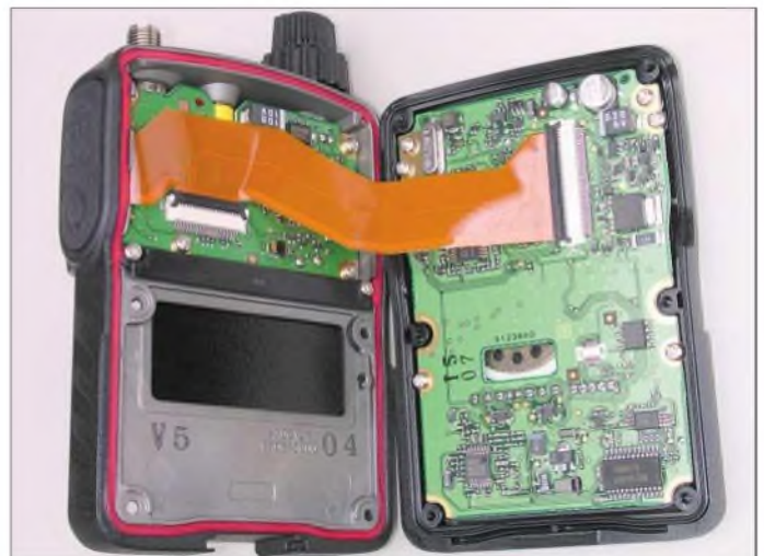
Ein verblüffend energiebiger Einblick: Im sehr aufgeräumten Innenleben findet nahezu der gesamte Analogteil links oben Raum in der Größenordnung einer Streichholzschachtel. Fotos: DG1NEJ
