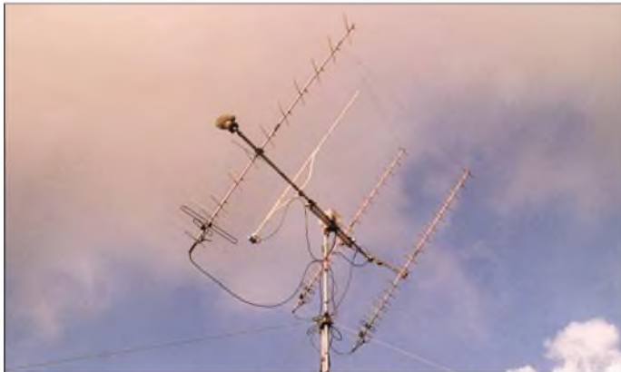
Bild 2: Entlastungsunterzug des Elevationsrotors mit zwei Pendelkugellagern
