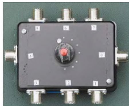
Bild 3: Labormuster mit sieben Schaltstellungen; das Kunststoffgehäuse ist vorn und hinten durch Aufkleben je einer Leiterplatte 10 x 8 cm 2 versteift worden. Fotos: DC9ZP
