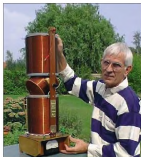
Werner, ON6ND, mit der selbst gebauten Anpassspule seiner Langwellenantenne Foto: ON6ND, mit freundlicher Genehmigung von G3YXM
