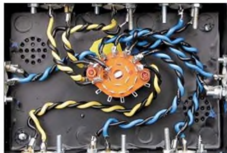
Bild 1: Innenleben des Schalters von Bild 3, geeignet bis 200 W PEP; die verdrehten Drähte haben annähernd 50 bis 70 Ω Impedanz.
