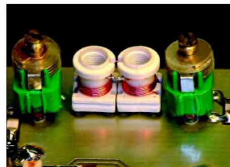
Bild 2: Bandfilter L11/C41, L12/C42 am Eingang des DDS-Nachverstärkers
