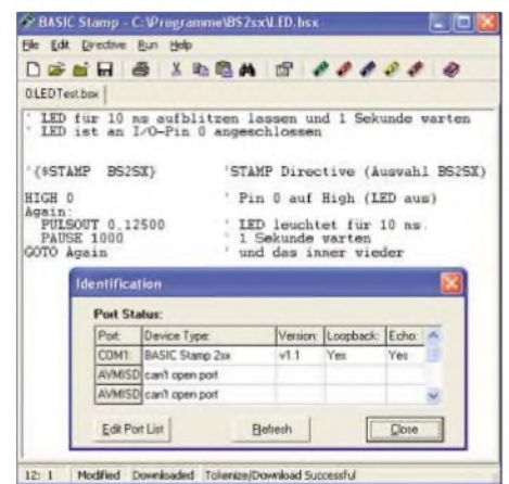
Bild 5: Mit einem einfachen Demo-Programm ist die Funktionsprüfung der selbst gebauten BASIC Stamps möglich.
