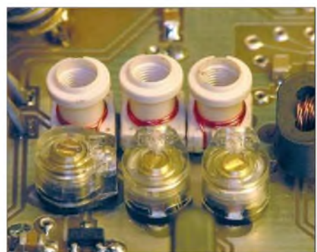
Bild 4: Dreikreisiges Filter L5/C28 ... L7/ C30 am Ausgang des Taktoszillators
