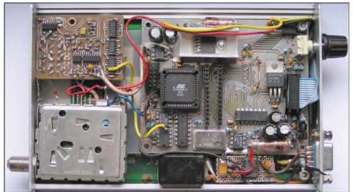
Bild 1: Der Panoramaempfänger für 850 bis 2250 MHz zeigt neben der Belegung des 23-cm-Bands auch das D/E-Netz, L-Band und die UMTS-Frequenz an. Der hohe Grundrauschpegel lässt auf unzureichende Entstörung und Abschirmung schließen.
