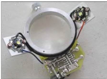
Bild 1: Die beiden auf geeignet angebrachten Aluminiumprofilen befestigten LEDs leuchten das eingespannte Objekt blend- und schattenfrei aus.
