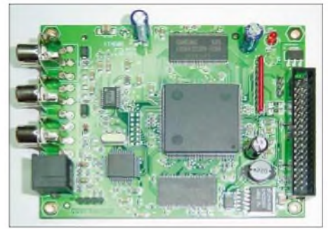
Bild 4: Kernstück des Platinensystems [4] – Video-/Audio-MPEG-Encoder
