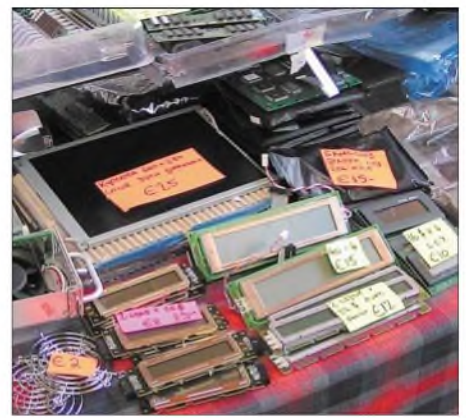
Bild 3: Anblick auf vielen Flohmärkten – das Samsung-QVGA-Display mit 320 × 240 Bildpunkten dient als Grundlage dieser Baugruppe. Viele andere Anzeigen sind aber auch einsetzbar. Fotos: DB1UQ
