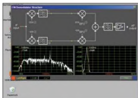
Bild 4: Zeitzeichenempfang und Blockdiagramm des Demodulators
