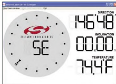
Bild 5: Der kalibrierte Kompass liegt parallel zur Erdoberfläche. Dadurch ist die angezeigte Richtung korrekt.
