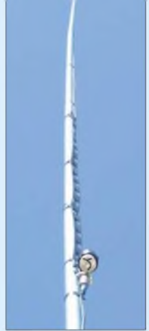
Bild 6: Diese J-Antenne für das 6-m-Band, an einer Glasfibrer-Angelrute befestigt, tat bei DK7ZB in der E S -Saison 2005 als Empfangsantenne ihren Dienst. Fotos: DK7ZB
