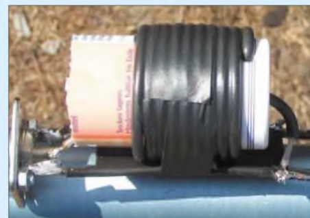
Bild 10: Ausführung der Speisedrossel bei einer 6-m-J-Antenne
