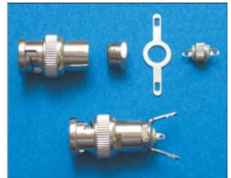
Bild 5: Umbau von BNC-Steckern zu Messadaptern Foto: HB90J
