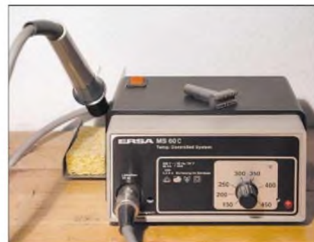
Bild 2: Mit einer elektronisch geregelten Lötstation hat man keine Umstellungsprobleme von bleihaltigem auf bleifreies Lötzinn.
