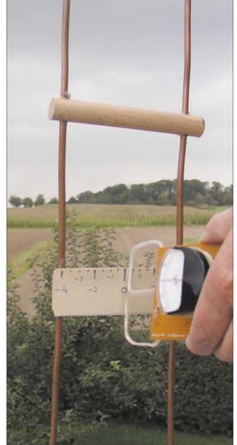
Bild 3: Messsegment mit Papierskala, welches zur präziseren Messung bei Verwendung schmaler Parallelleitung als Zwischenstück eingesetzt werden kann.
