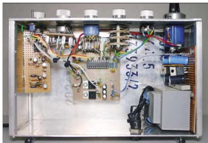
Bild 4: Blick in das geöffnete Gerät; in der Mitte ist die Platine des ELV-Bausatzes zu erkennen, links der Sägezahngenerator, rechts das Netzteil.
