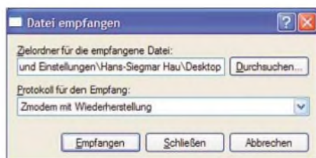
Bild 7: Auf dem Zielrechner ist in Hyper Terminal vor der Übertragung der Ablageort für die zu empfangende Datei auszuwählen.
