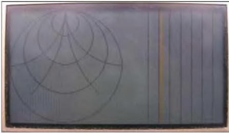
Bild 16: Eine mögliche Anwendung der Hauptplatine bietet die Vektoranalyse mit dem MAX2102. Das Smith-Diagramm mittels Bresenham's Algorithmus gezeichnet funktioniert schon – auch ohne LCD-Controller.
