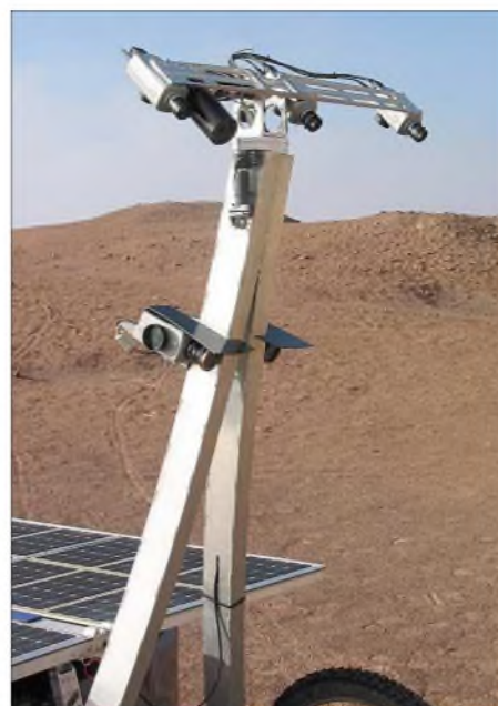
Bild 2: Auf einer dreh- und schwenkbaren Plattform sind die Kameras zur Orientierung des Roboters und für Geländeaufnahmen montiert. Fotos: Carnegie Mellon University
