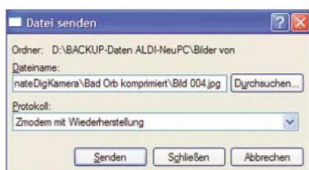
Bild 6: Nach dem Anklicken des Buttons Durchsuchen ist die zu übertragende Datei auszuwählen.
