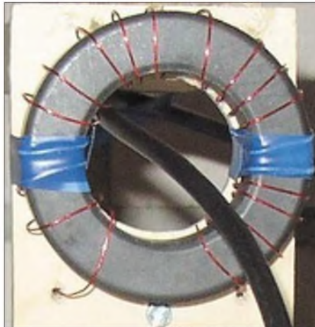
Bild 5: Twinlead mit 300 Ω Wellenwiderstand, das als Ganzes durch den Ringkern einer Stromzange durchgeführt wird. Die Stromzange zeigt hier den gleichphasigen (common-mode) Anteil des Stroms auf der Speiseleitung an. Fotos: DL3AO
