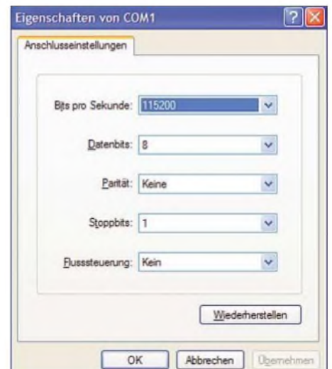
Bild 4: Im zweiten Schritt folgt die Festlegung der Übertragungsparameter, die an beiden Rechnern identisch sein müssen.
