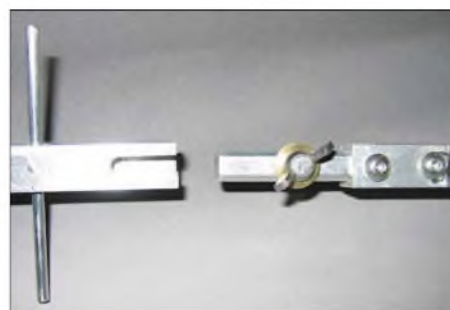
Bild 10: Einzelheit des Boom-Stecksystems von DJ9YW, das ein Zerlegen der Yagi in vier Einzelstücke erlaubt.
