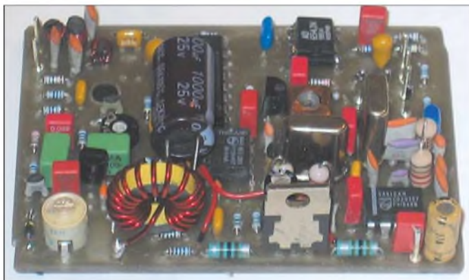
Bild 1: Fertig aufgebauter PLL-VFO, hier noch ohne Gehäuse
