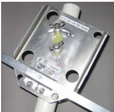
Bild 9: Eigenbau-Elevationsschelle für EME-Betrieb
