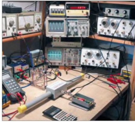
Bild 4: Test des Ferritmoduls; hier wird die reale Abbildung bei gedämpften Betrieb überprüft.
