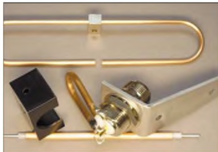
Bild 2: Bauteile des Dipols; unten im Bild ein Stück UT141-CU, wie für den Balun verwendet
