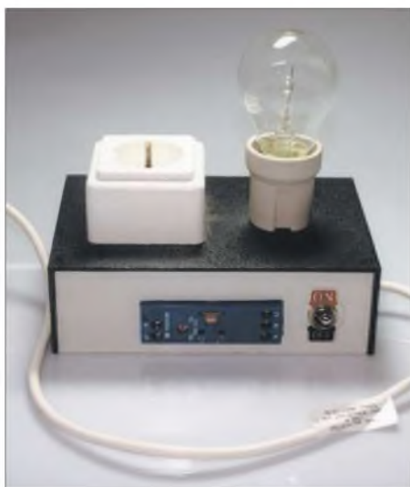
Bild 1: Die Ansprechzeit des im Gehäuse eingebauten anzugsverzögerten Relais ist von außen einstellbar. Foto: DL1NFF
