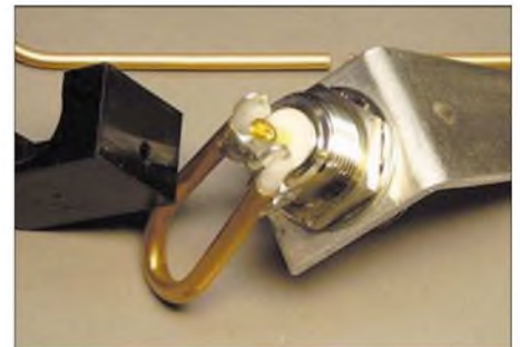
Bild 3: Montage des Baluns an der Dipolanschlussbuchse
