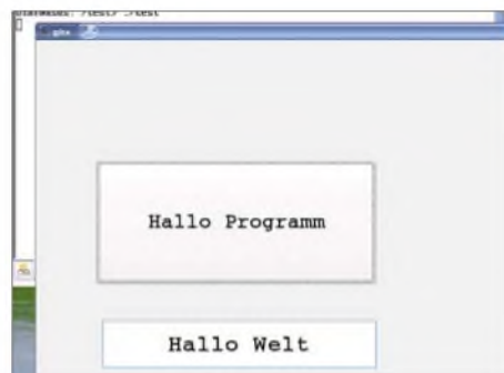
Bild 8: Nach einem Klick auf den Button meldet sich das Programm mit „Hallo Welt“.
