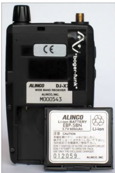
Bild 4: Lange Empfangsdauer dank Energiesparschaltung. Der Akkumulator hält etwa 500 Ladezyklen. Fotos: DL1ABJ
