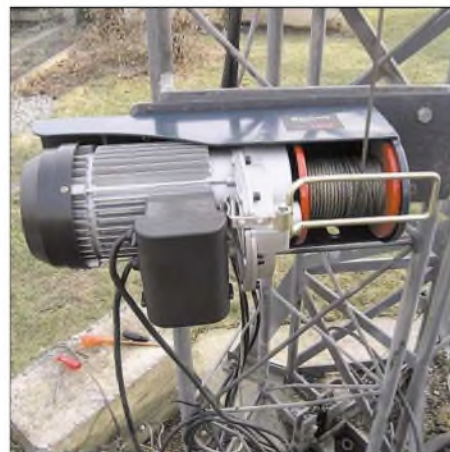
Fertig montierte Elektrowinde am Versa-Tower Fotos: DJ3QX
