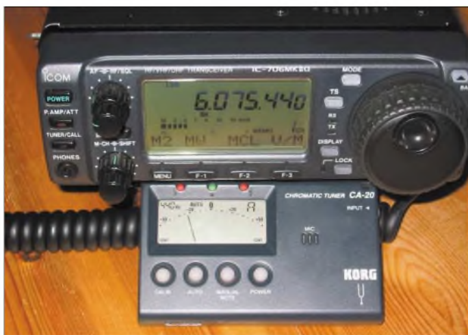
Bild 2: Differenzfrequenzmessung zwischen der Deutschen Welle als Referenzsender und dem Kammermerton A
