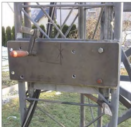
Fertig montierte Elektrowinde am Versa-Tower Fotos: DJ3QX
