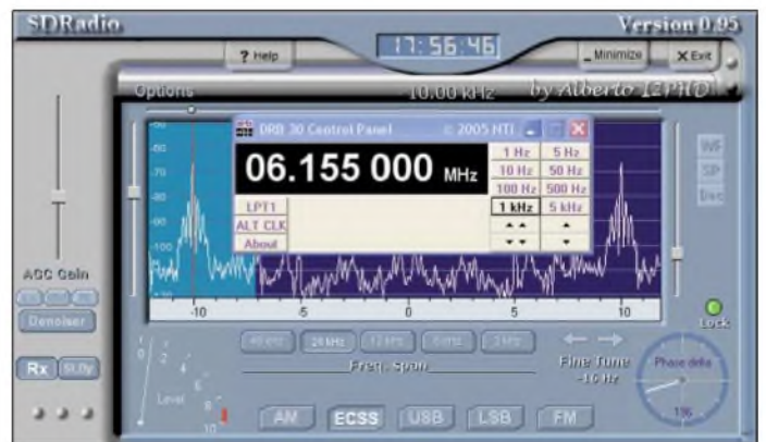
Bild 2: Steuer- und Demodulatorprogramm G8JCFSDR
