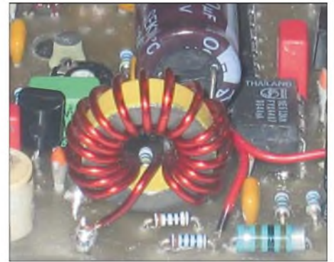
Bild 5: Schaltungsdetail Ringkernspule L3
