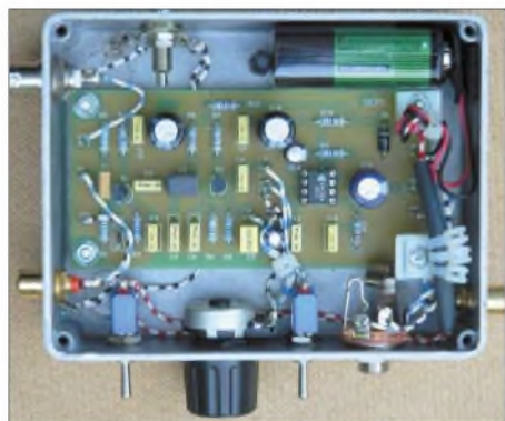
Bild 13: Innenaufbau des für die Messungen verwendeten Sfericsempfängers
