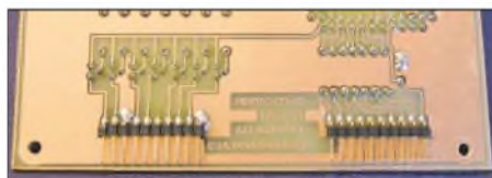
Bild 2: Unter die Hauptplatine werden abgewinkelte Steckerleisten gelötet.
