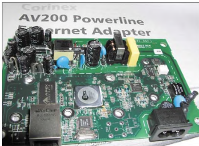
Bild 4: DS2 plant Übertragungsraten bis 200 Mbit/s mit über tausend OFDM-Trägern. Bei diesem Verfahren sind die Träger permanent eingeschaltet und werden separat moduliert.
