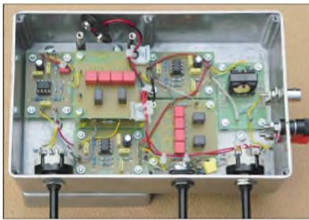
Bild 15: Als frequenzbestimmende Bauelemente kommen in den Filtern des Breitbandortungsgeräts geschirmte Neosid-Drosseln und WIMA-FKP-Kondensatoren zum Einsatz.
