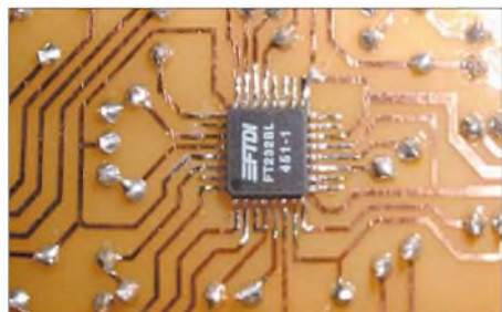
Bild 8: Einziger Wermutstropfen ist der SMD-IC FT232BL; ab Februar gibt es über den FA-Leserservice Platinen, wo dieser bereits bestückt ist. Fotos: DK4MX
