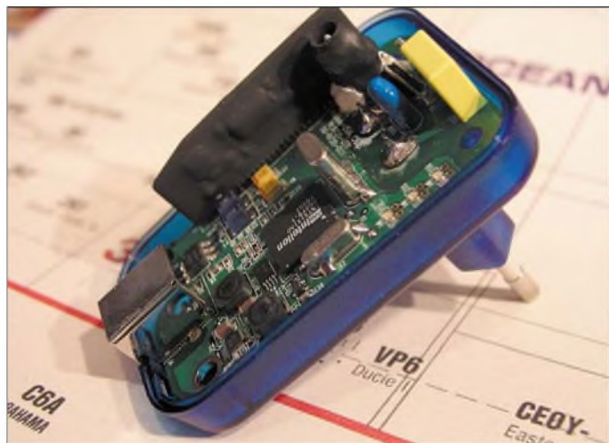
Bild 3: Störsender aus dem Supermarkt? Blick in ein PLC-Modem zur einfachen Vernetzung von Computern oder Musikanlagen per Steckdose und Stromleitung.
