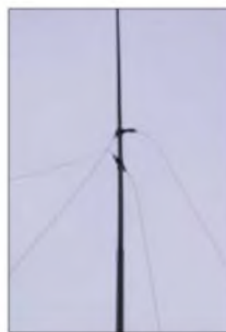
Bild 2: Die Spitzen der Dreiecke werden mit Isolierband am Mast befestigt. Gut geeignet ist Temflex-Band von 3M.
