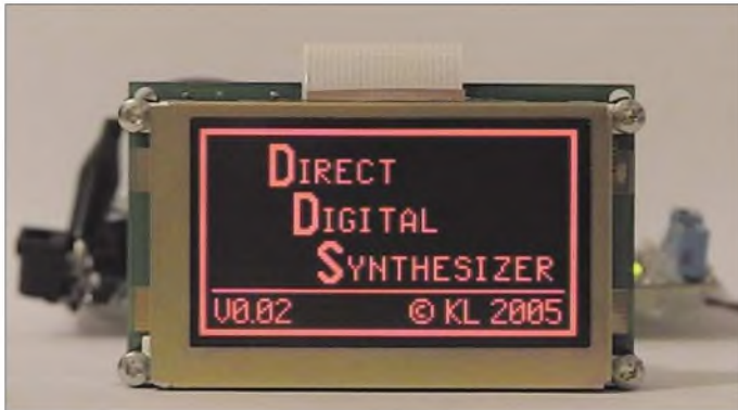
Bild 1: Die Platine für die Frequenzzeugung und Transceiversteuerung wurde nur unwesentlich größer als das grafikfähige LC-Display gewählt, sodass sich beide als kompakte Einheit in einen Transceiver integrieren lassen.
