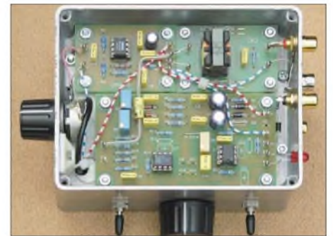
Bild 18: Ansicht des fertigen Kombinationsgeräts für die Tonfrequenz- und Sfericsortung mit der Impulsauswertung und Analogausgabe im Aluminiumgehäuse
