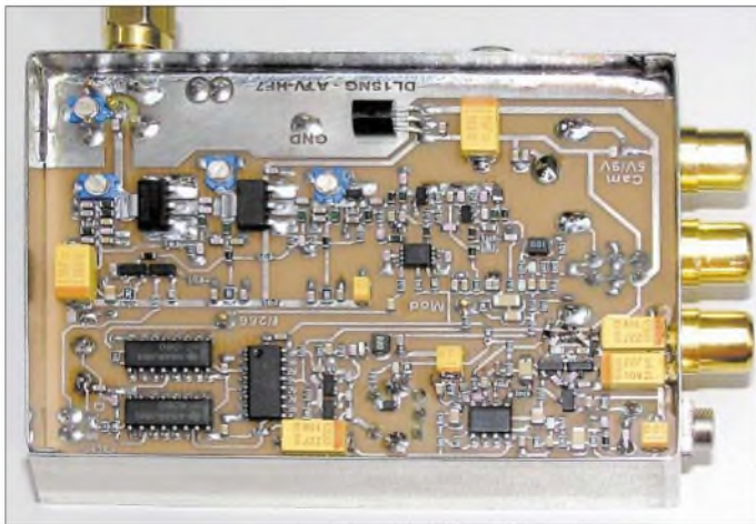
Bild 1: Die komplett bestückte Platine des ATV-Senders findet in einem Weißblechgehäuse Platz.
