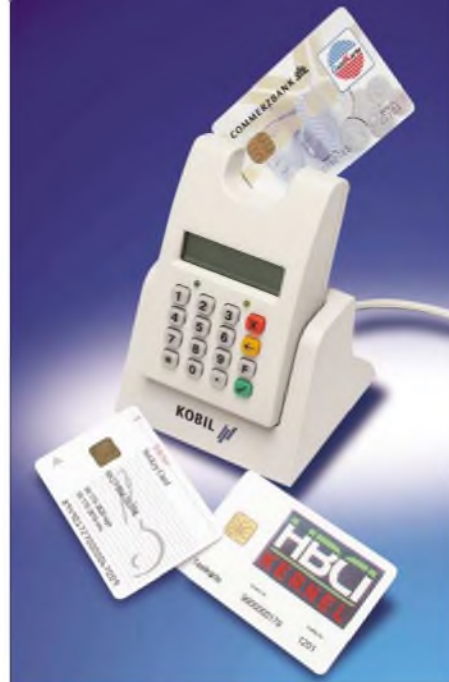
Bild 2: Display und Tastatur des KAAN Professional (Sicherheitsklasse 3) machen die authentische Darstellung von Texten möglich – und unterstützen eine sichere Eingabe der PIN. Quelle: Kobil
