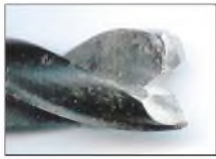
Bild 2: Ein Holzbohrer mit herausgebrochenem Zentrierdorn dient als Fräser für die Lötstützpunkte.
