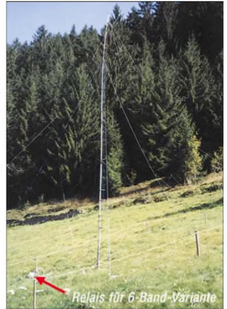
Bild 3: Gesamtansicht der 5-Band-Antenne inklusive der am Schluss des Beitrags beschriebenen Erweiterung für 40-m-Betrieb
