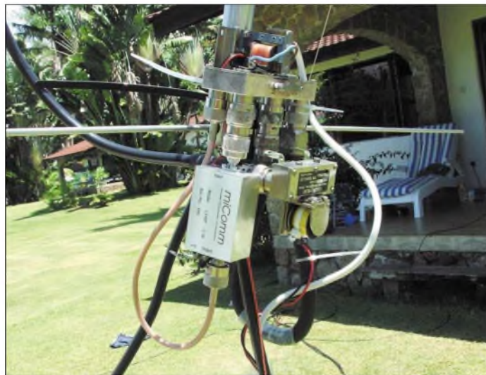
Wenn man mit nur einer einzigen Yagi-Antenne via EME arbeitet, fällt jede Kleinigkeit ins Gewicht: Antennenumschaltung und Vorverstärker befanden sich direkt an den Dipolen. Und die PA dürfte auch nicht weit davon entfernt gewesen sein. Foto: S79HP
