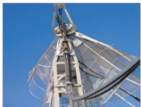
Am 20.1.06 büßte SK7MW den 4,5-m-Spiegel nach starkem Eisregen ein – somit ist NAC-Betrieb auf 13 cm nur eingeschränkt möglich. Foto: SM7EYW
