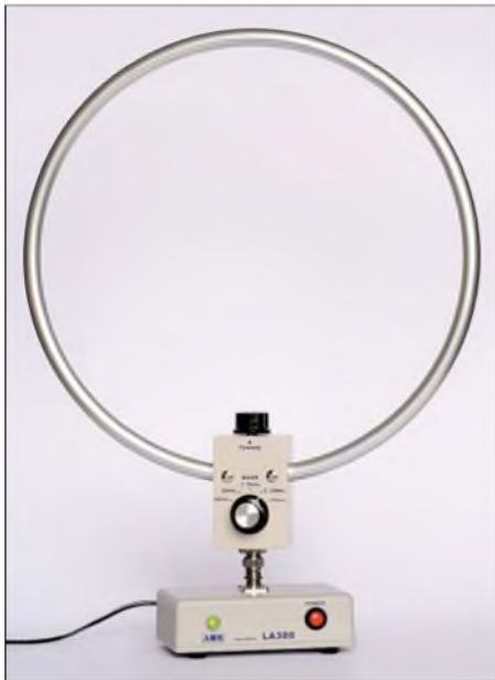
Bild 1: Die LA380 ist eine aktive Magnetantenne für 40 kHz bis 500 MHz.
