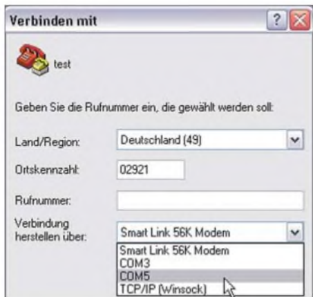
Bild 10: Im Hyperterminal wählt man den virtuellen COM-Port.
