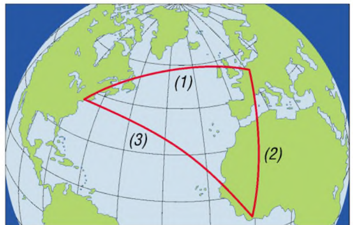
Bild 2: Auf der direkten Linie Berlin – New York (1) wird die MUF überschritten. Über den Umweg Afrika und der dortigen höheren MUF (2) kann die Welle seitengestreu (3) ihr Ziel erreichen.
