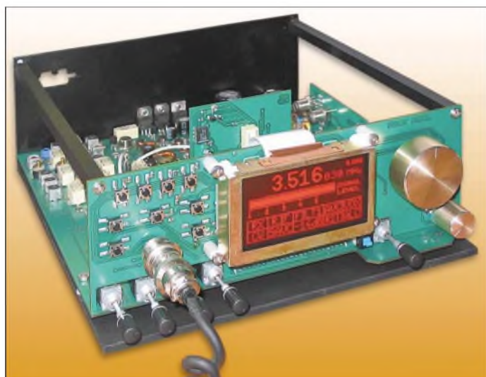
Bild 5: Die Platine ist hauptsächlich mit SMD-Bauteilen bestückt. Fotos: OK1NOF (1) Rykl (8)
