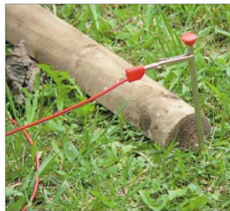
Bild 3: Um den Transport und Aufbau so einfach wie möglich zu halten, ist die Anschlussleitung mit Krokodilsklemmen befestigt.
