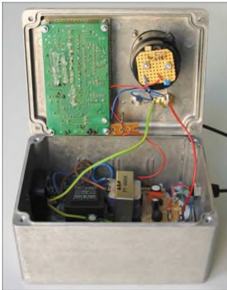
Bild 3: Anzeigeeinheit inklusive Stromversorgung in geöffnetem Zustand Fotos: DK3RED
