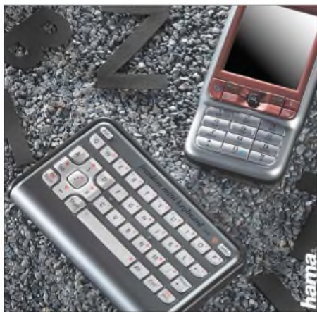
Diese Tastatur von Hama hat die Größe einer Scheckkarte und funkt per Bluetooth mit elektronischen Notizbüchern. Sie erleichtert die Eingabe längerer Texte.
