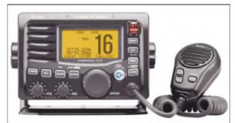
Moderne VHF-Seefunktransceiver, wie der Icom IC-M504, senden auf Knopfdruck ein DSC-Notsignal mit den Schiffsdaten.
