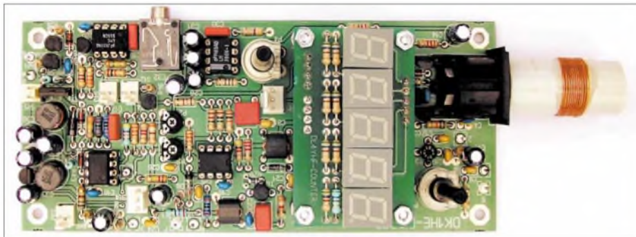
Bild 1: Fertig aufgebautes Dipmeter; der Frequenzzähler ist als separates Modul ausgeführt. Rechts im Bild ist eine Steckspule zu erkennen. Foto: DK1HE
