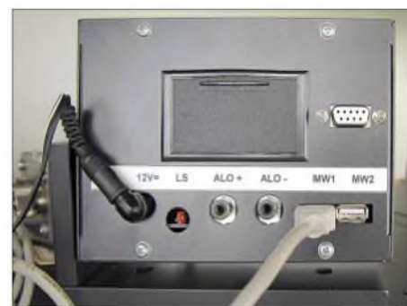
Bild 9: Alle Anschlüsse für die Anzeigeeinheit befinden sich auf der Rückseite: RS232-Schnittstelle, 12-V-Versorgungsspannung, Ladestecker für Akkumulatorbetrieb, ALO-Steueranschluss sowie zwei Anschlüsse für die Messwandler. Fotos: Autor
