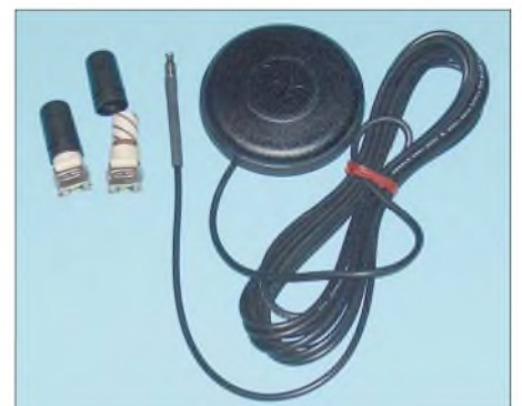
Bild 2: Als Antennen eignen sich aktive oder passive Geohelix- oder Patchtypen.
