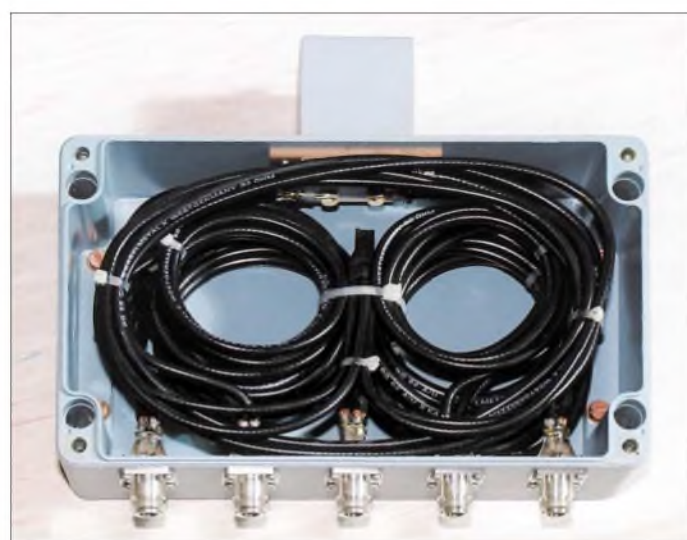
Bild 5: Blick in einen geöffneten Splitter/Kombinierer
