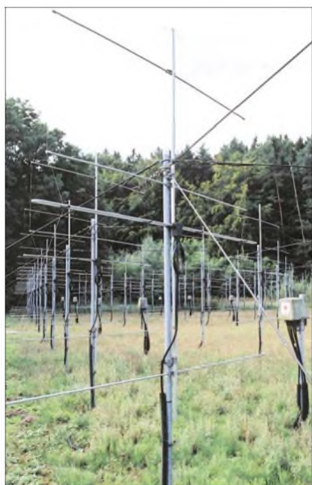
Bild 3: Die Yagis sind festgezurt, um mechanische Schwingungen durch Wind zu vermeiden, die Messergebnisse verfälschen können.
