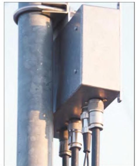
Bild 2: Der beschriebene Empfangsvorverstärker im praktischen Einsatz Fotos: DH7FB
