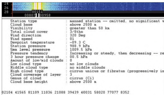
Bild 5: Im Synop-Modus wandelt SkySweeper decodierte Wettertelegramme von Bodenstationen in Klartext.
