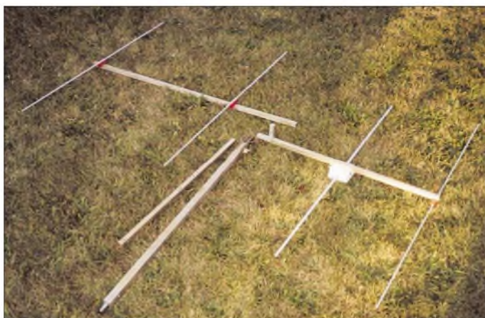
Bild 1: Die zerlegte 4-Element-Yagi nach DK7ZB
