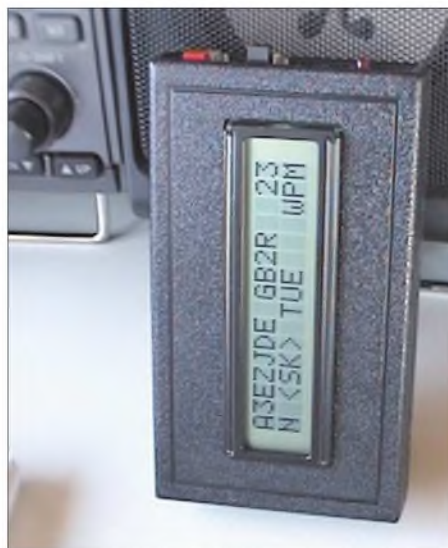
Bild 2: Einfacher gehts kaum: MFJ-461 direkt vor den Empfängerlautsprecher stellen und die Telegrafiesignale auf dem Display mitlesen!
