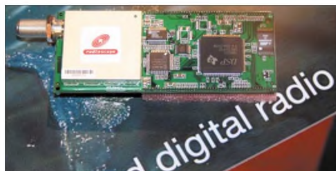
Bild 3: Dieses Kombimodul empfängt und demoduliert DRM, DAB, AM und FM und war auf der IFA 2005 zu sehen. Die für Weihnachten 2005 versprochenen DRM-Kofferradios lassen allerdings weiter auf sich warten.
