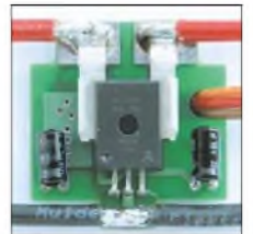
Bild 3: Die zur Sensorplatine führenden Leitungen sind großflächig aufzulöten, wobei die Masseleitung nicht zu unterbrechen ist.
