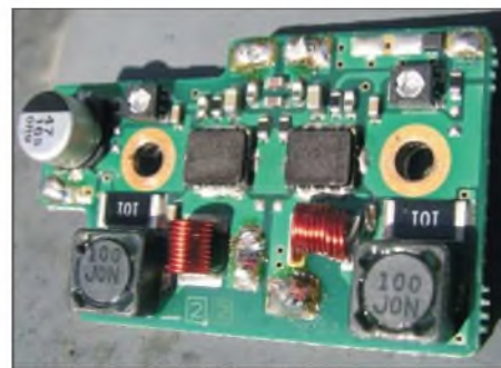
Bild 2: Die gesamte FT-817-Endstufenplatine final unit misst nur 2 cm x 4 cm. Fotos: OE3MZC
