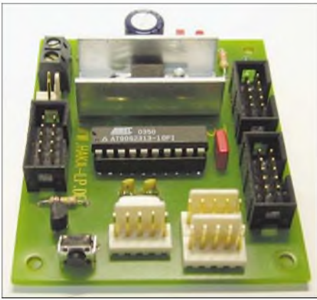
Bild 12: Basismodul mit eingesetztem AVR-Controller
