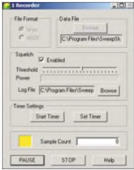
Bild 7: Der integrierte Digitalrecorder lässt sich inklusive Datum für automatische Aufnahmen programmieren. Im Squelch-Modus startet der Recorder, sobald ein NF-Signal anliegt.
