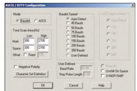
Bild 3: Im Konfigurationsmenü des RTTY-Decoders lassen sich die Baudrate und der Bereich für die automatische Tonfrequenzsuche festlegen.
