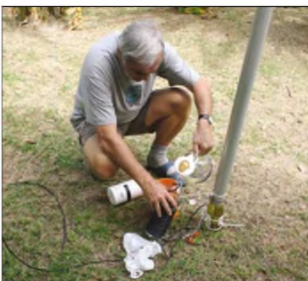
Sigi, DL7DF, beim Abstimmen der Resonanzfrequenz der 160-m-Antenne durch Änderung des Füllstandes des Wassers in der Flasche
