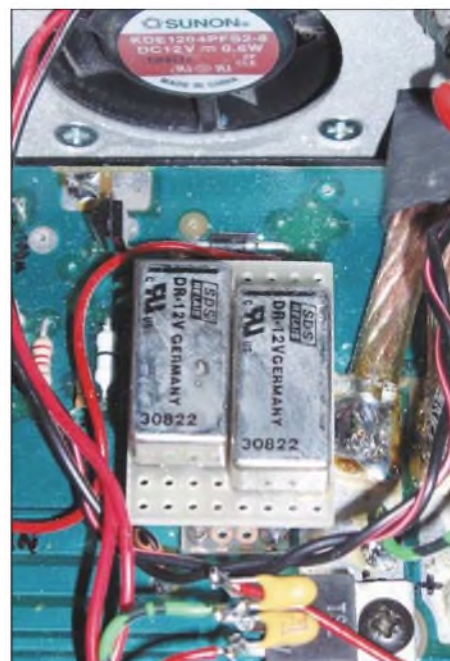
Bild 2: KL500 mit eingebauten SDS-Relais Fotos: DL3MCO
