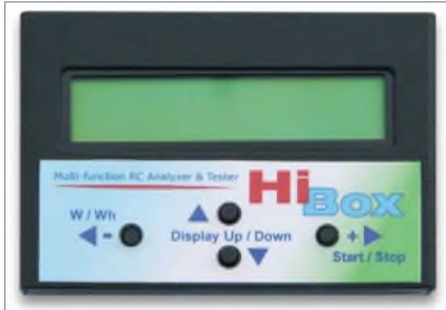
Bild 1: Die universelle Baugruppe lässt sich über nur vier Taster bedienen.
