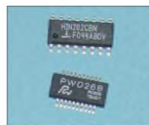
Bild 3: Der PW0268 im Vergleich zu einem normalen SMD-Schaltkreis.
