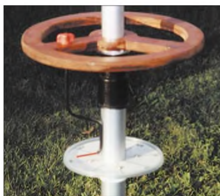
Bild 5: Blick aufs Eigenbauhandrad mit Richtungsanzeige zum Tragen und Drehen der Antenne
