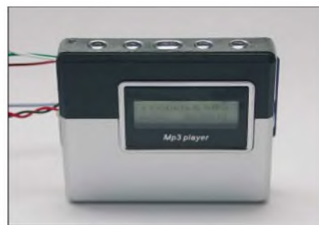
Bild 6: Mit etwas Geschick lassen sich die Verbindungsdrähte so aus dem MP3-Player herausführen, dass er nicht mit in das Gehäuse der Steuerung eingebaut werden muss.
