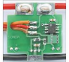
Bild 4: Zur Zugentlastung ist das Verbindungskabel zur HiBox durch einen Durchbruch zu führen.
