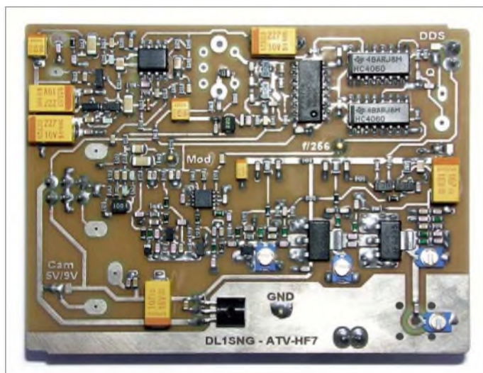
Bild 12: Die fertig bestückte und gereinigte Platine ist bereit für den Einbau in ein Weißblechgehäuse.
