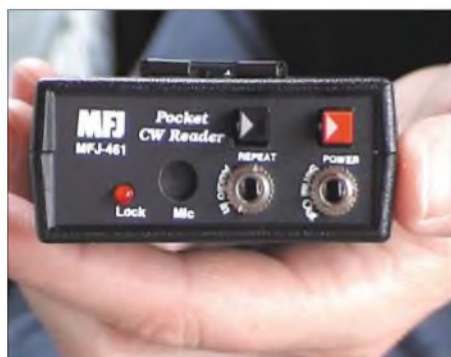
Bild 4: An der Gerätestirnseite befinden sich der Ein-/Ausrichter für das Gerät sowie der Taster REPEAT; ferner die Klinkenbuchse für den externen NF-Signaleingang und eine zur Textanzeige auf einem Computer.
