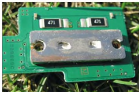
Bild 1: Detailaufnahme des Kühlblocks mit den eingelöteten Transistoren
