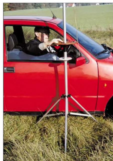
Bild 8: Die Bedienung der Drehvorrichtung durch das Fenster des Pkw. Ohne den Kopf zu heben, kann man auf der Skala die Hauptempfangsrichtung der Antenne ablesen.
