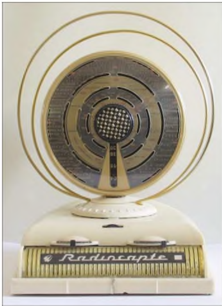
Der Radiocaple ist ein Superhet zum Empfang der Kurz-, Mittel- und Langwelle und wurde Mitte der 50er Jahre in Frankreich gebaut.
