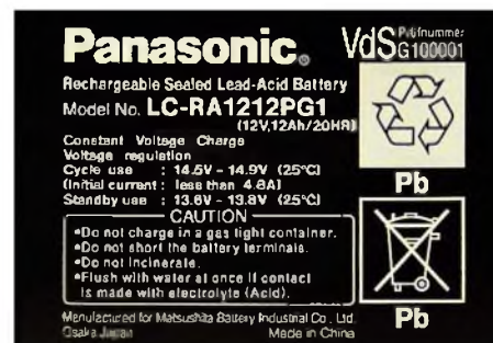
Bild 2: Neben Warnhinweisen und Umweltvorschriften sind auch Parameter für die korrekte Ladung auf dem Gehäuse aufgedruckt.
