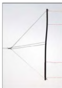
Bild 3: Seitliche Spreizer bringen die Antenne in Form. Die WFL benötigt stabile Aufhängepunkte, damit das Mittelteil samt Antennenkabel nicht durchhängt.
