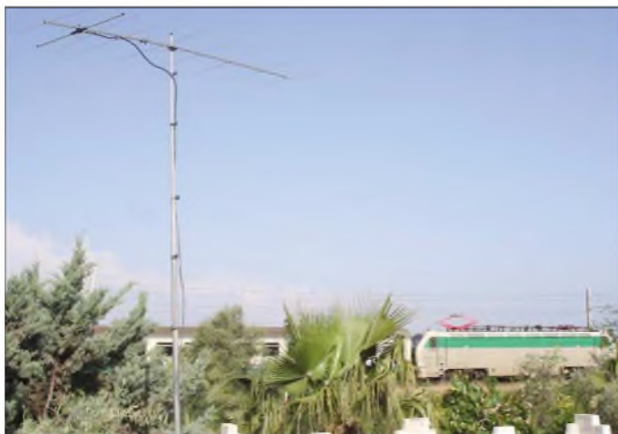
I8/DH7FB und I8/DF2ZC waren vom 29.4. bis 2.5.06 in JM79VQ via Meteorscatter QRV. Mit einer 9-Element-Yagi und 300 W glückten 87 QSOs, sodass JM79 auf der Most-Wanted-Liste nun weit nach hinten rutschen dürfte. Der quer zur Antennenrichtung verkehrende Zug war auch regelmäßig für kräftige Bursts gut. Foto: DF2ZC
