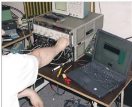
Bild 6: Die beiden Signalgeneratoren zur Messung des Großsignalverhaltens
