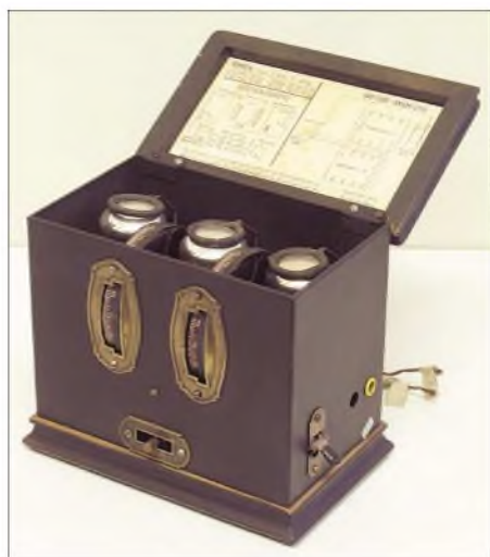
Telefunken Arcolette III W, ein Einkreiser für Mittel- und Langwelle aus dem Jahr 1928
