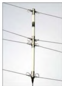
Bild 2: Im Mittelteil sorgt ein Übertrager für ein niedriges SWR im gesamten Arbeitsbereich. Vor der Antennenbuchse (SO 239) verhindert eine integrierte Mantelwellensperre HF auf dem Antennenkabel.
