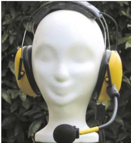
Bild 6: Ein Eigenbau-Headset mit Gehörschutzkappen von Peltor, Telefonhörkapseln von der ehemaligen Bundespost und HC4-Kapsel von Heil. Als Mikrofonträger dient ein Stück Koaxialkabel vom Typ Aircell.
