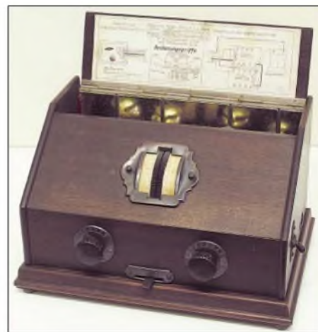
Der Telefunken T4, ein Zweikreisempfänger für Mittel- und Langwelle aus dem Jahr 1927
