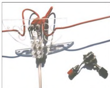
Bild 2: Symmetrische und unsymmetrische Einspeisung
