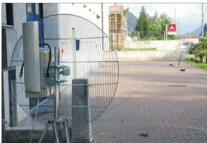
Bild 2: Konventionelle Geräte dienen als Basis für die Hotspots. In den Plastikkästen sind die Module für die Spannungversorgung via Ethernet untergebracht.
