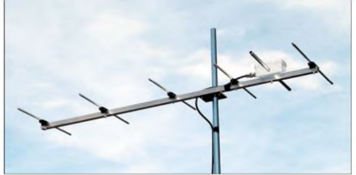
Bild 4: 6-Element-70-cm-Yagi beim Portabeinsatz
