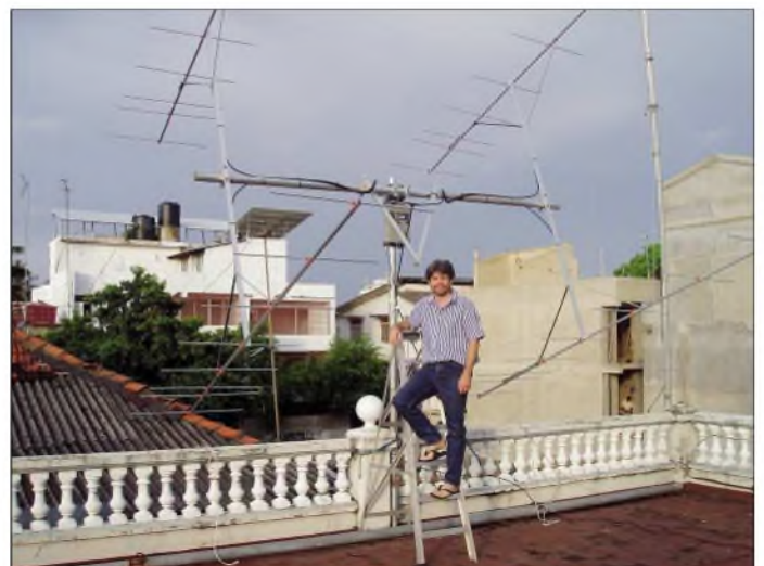
Bob, 4S7CCG, an seiner Vierergruppe für EME-Betrieb auf 144 MHz Foto: 4S7CCG
