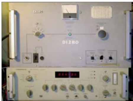
Der 130-W-Seefunksender DEBEG-7121 (oben), der bei DI2BO wieder in Dienst gestellt wurde.
