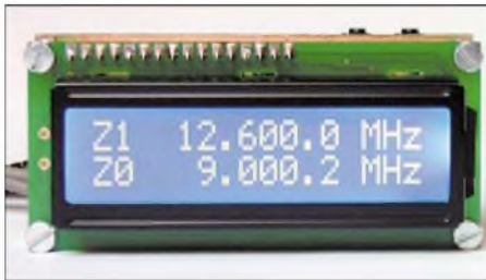
Bild 1: LC-Display mit Anzeige der beiden gemessenen Einzelfrequenzen Fotos: DM2CWG
