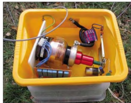
Was hier so aussieht wie ein Teil der Küchenausstattung des Urlaubs-QTHs von Dave ist in Wirklichkeit die Antennenanpassung der Loop.
