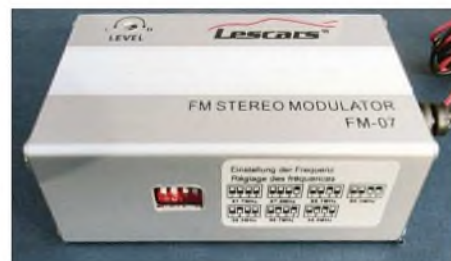
Die Frequenzwahl geschieht am Lescars FM 07 per DIP-Schalter, die nach dem Einbau nicht mehr zugänglich sind.
