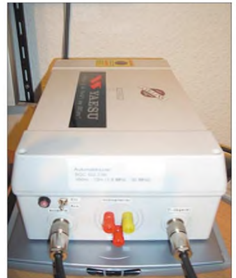
Bild 2: Ausgestattet mit den benötigten Anschlussbuchsen und einer integrierten 12-V-Stromversorgung lässt sich der geschützte SG-239 flexibel einsetzen. Fotos: DD9HK
