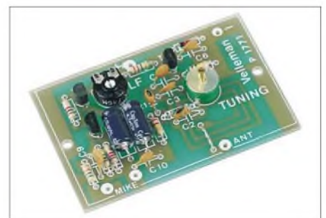
UKW-Messsender, wie hier ein Bausatz von Velleman , sind nicht für den Betrieb an einer Antenne vorgesehen und sollten in einem abgeschirmten Gehäuse untergebracht werden.
