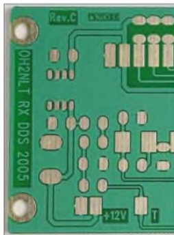
Bild 7: Die industriell hergestellten Leiterplatten des Bausatzes, hier ein Ausschnitt der DDS-Platine, mit großen Löt-pads und Löt-stopmmaske, erleichtern die Bestückung sehr.
