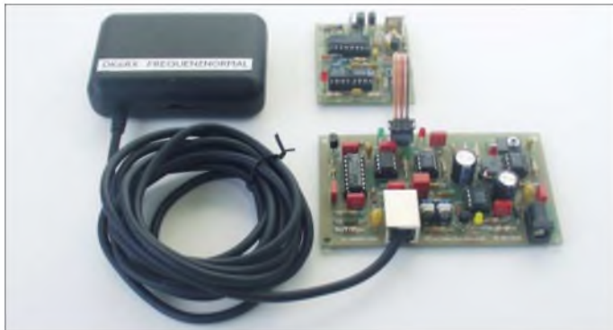
Bild 1: Komplettes System mit GPS-Empfänger nebst integrierter Patch-Antenne links, Original-Videofrequenznormal oben und 10-/15,625-kHz-Konverter unten
