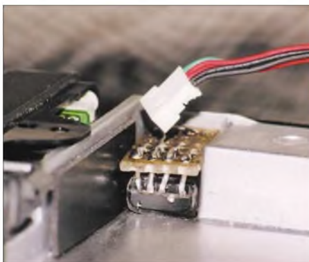
Bild 1: Die Unterspannungsschutzschaltung lässt sich selbst in kompakt aufgebauten Geräten unterbringen – hier zwischen dem zeitweise herausgenommenen Batteriefach des FT-817 und dem Gehäuse. Foto: DC8RI
