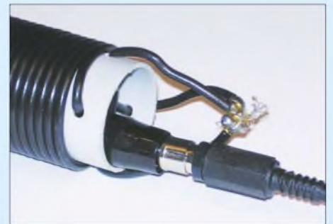
Bild 2: Dank der Messleitung lässt sich die Dipmeter-Spule auch in einen Spulenkörper mit geringem Durchmesser einführen.
