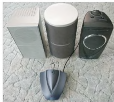
Drei untereinander kompatible Funklautsprechermodelle von Tevion (bei Aldi erhältlich), die oberhalb 863 MHz in FM empfangen und davor ein dazu passender Sender; die lange Leitung am Sender ist die Stromversorgung, die Antenne ist der kurze Drahtstaken oberhalb. Bei den Empfängern ist die Antenne im Inneren der Lautsprecher versteckt und von außen nicht sichtbar.
