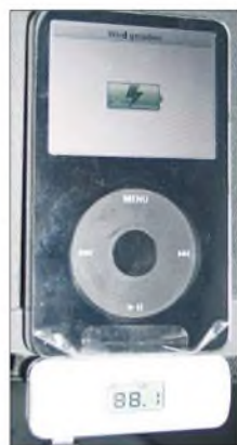
Über die Mini-USB-Buchse kann der iTrip auch von einem Netzteil versorgt werden und lädt dann den iPod mit auf.
