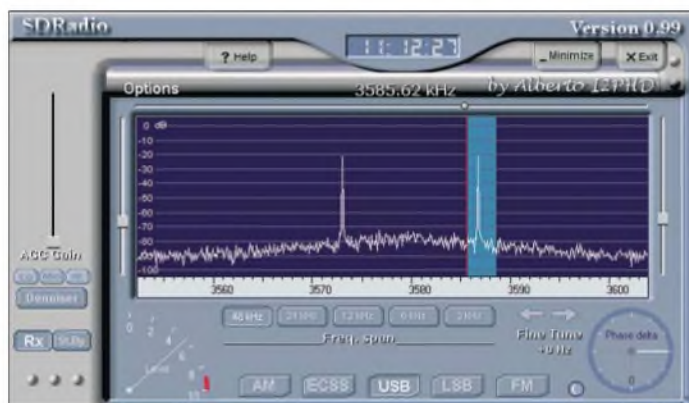
Bild 4: SDRadio arbeitet in diesem Fall einkanalig; bei einem schlecht eingestellten IQ-Mischer ist eines der beiden Signale mehr oder weniger gut unterdrückt.
