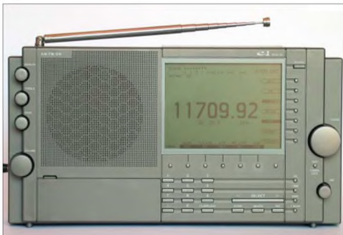
Bild 1: Auf der rechten Hälfte der Gehäusefront umrahmen 35 Tasten und ein Wippschalter das mit einem Format von 116 x 85 mm 2 für einen tragbaren Weltempfänger ungewöhnlich große Punktmatrix-LC-Display mit abschaltbarer Hintergrundbeleuchtung, das sich am besten direkt von vorne ablesen lässt.
