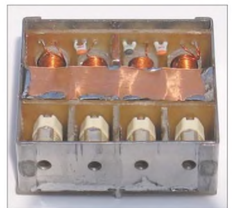
Bild 10: Fertig montiertes Filter mit Kupferstreifen, Rückansicht Fotos: DK3SP
