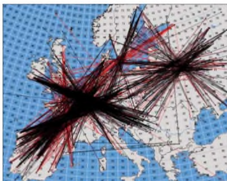
Mehrere großflächige E s -Wolken ermöglichten am 18.6.06 DX-QSOs nach EA, CT sowie Richtung Norden und Osten. Grafiken: G7RAU
