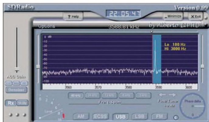
Bild 7: SDRadio- Empfangsbeispiel für einen unmodulierten Träger
