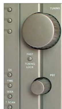
Bild 3: Unter dem leichtgängigen VFO-Knopf liegt der Steller fürs Passband Tuning (PBT).
