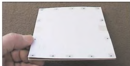
Bild 2: Das markierte Papier mit den Klebestreifen ist vorsichtig vom Gehäuse zu lösen und passgenau als Bohrschablone auf den neuen Deckel zu kleben. Fotos: Mittelstedt
