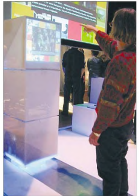
Nach der einfachen Kalibrierung über das Verfolgen eines Punktes mit der Hand steht das System für Steueraufgaben bereit.
