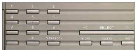
Bild 4: Frequenzen lassen sich per Zehner-tastatur direkt eingeben.
