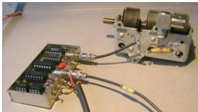
Bild 2: Testaufbau bei DL7LA; direkt am Drehkondensator ist eine 5-µH-Festinduktivität älterer Bauart zu erkennen.
