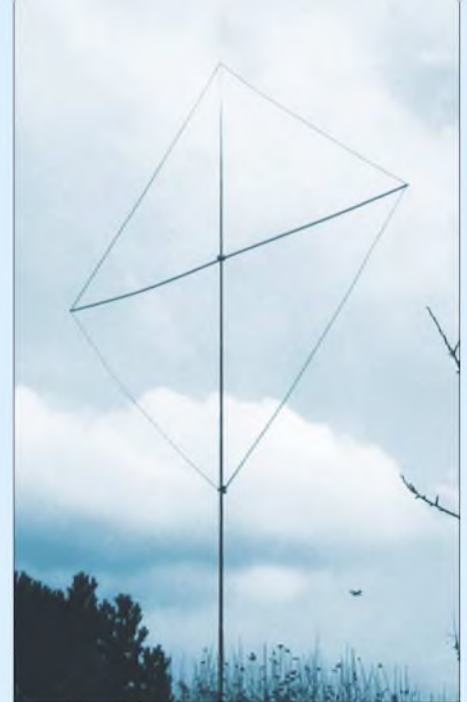
Bild 2: Quad-Loop für 15 m, aufgebaut mit einem Glasfitermast und Elektroinstallationsrohr aus Kunststoff als Querträger
