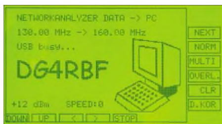
Bild 27: Displayanzeige während des Wobbels mit PC-Unterstützung
