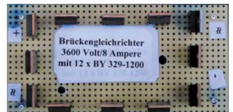
Bild 5: Brückengleichrichter mit zwölf Dioden des Typs BY329, die für Ströme bis 8 A und Sperrspannungen bis 3600 V geeignet sind
