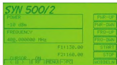
Bild 30: Der SYN 500/2 ist ohne Detektor auch als Synthesizer verwendbar.
