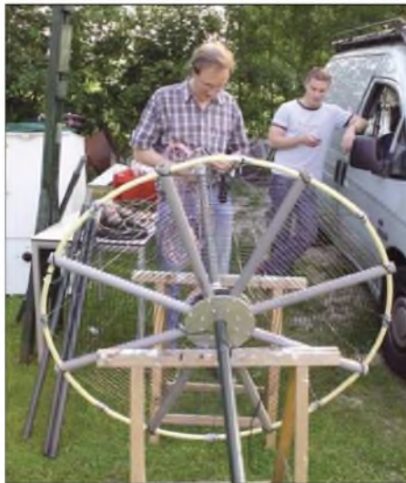
Die kapazitive Dachlast der Langwellenantenne von PA4VHF/p
