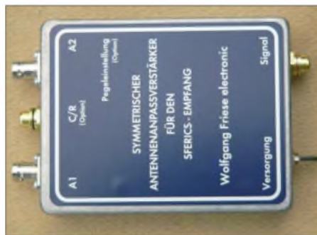
Bild 9: Symmetrischer Antennenanpassverstärker mit UAP INAw als Fertiggerät
