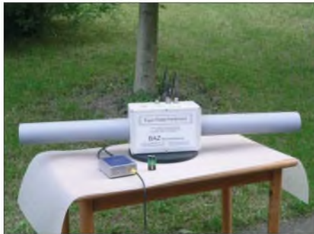
Bild 4: Antennenanpassverstärker mit UAP INAw kombiniert mit dem Super-Power-Ferritmodul der Firma BAZ; das 1 m lange, als Sonderfertigung mit einem Rohrdurchmesser von 7,5 cm und einem speziellen Wickelverfahren hergestellte Modul ist das bisher größte von BAZ gefertigte.
