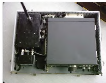
Ansicht von oben: links das Antennenanpassgerät, rechts der FT-747
