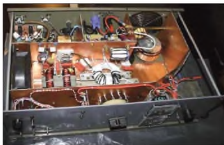
Blick in den Langwellensender von PA4VHF
