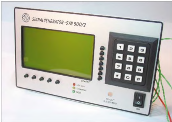
Bild 25: Die Hauptfunktionen des SYN 500/2 sind auch vom PC aus steuerbar.
