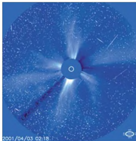
Bild 2: Koronagraph LASCO C3: kleiner Ring Mitte: Sonnengröße; kleine Kreisfläche: Abdeckscheibe; dunkler Streifen nach links unten: Halterung für Abdeckscheibe; helle Blase horizontal nach links: zu messendes CME, das inzwischen eine Entfernung von 6,4 Millionen km erreicht hat; ringsum Sterne. Quelle: SOHO, SEC Boulder
