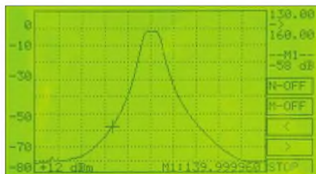
Bild 28: Die Funktionen beim Wobbeln ohne PC lassen sich über Softkeys aufrufen.
