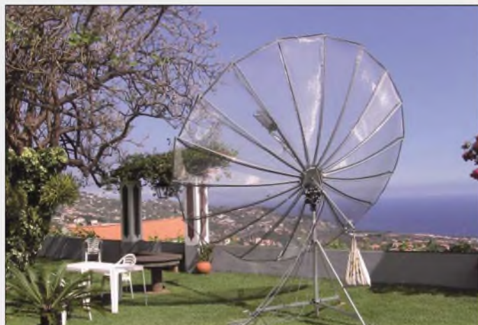
Der portable 4,1-m-Antennenspiegel auf Madeira: Direkt am Affenbrotbaum vorbei ging es in Richtung VK3UM
