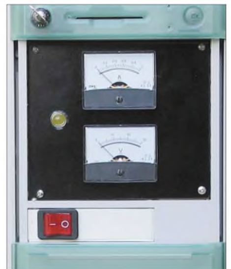
Bild 3: PC-Gehäuse Scenic Tower von Siemens als Hochspannungsnetzteil verwendet; die unten teilweise erkennbare grüne Schutzklappe lässt sich zum Verdecken des Einschalters und der Anzeigeelemente hochschieben und das Netzteil mit dem oben links zu sehenden Schlüssel gegen unbefugte Benutzung sichern.
