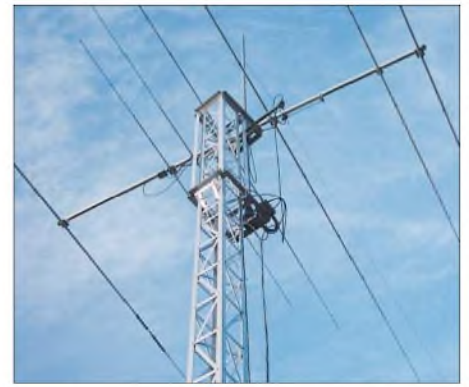
Bild 4: Einspeisung der FD5 mit 1:6-Balun Fotos: DL7PP
