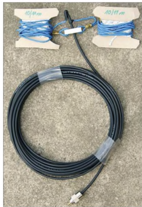
Der Dierking-Dipol ist eine komplette 11-m-Antenne fürs Reisegepäck. Fotos: DL1ABJ
