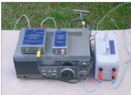
Bild 8: Beim Betrieb mit einer großen Schleifenantenne lassen sich durch die Erdung des Anpassverstärkers Schwingungen vermeiden. Der verwendete Einsteckerder ist hinter dem Tisch zu erkennen. Fotos: DG9WF
