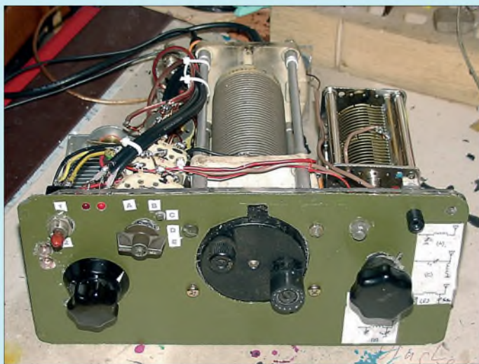
Bild 2: Blick in das Z-Match mit dem SWV-Meter aus einem konventionellen Richtkoppler Fotos: DL8OL
