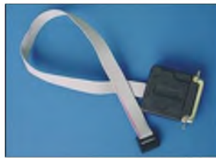
Bild 8: Programmieradapter im Sub-D25-Steckergehäuse
