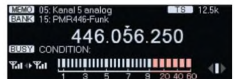
Diversity-Empfang ist in dieser Geräteklasse eine Neuheit. Die Symbole links neben der Anzeige der relativen Signalstärke kennzeichnen die gerade aktive Antenne.
