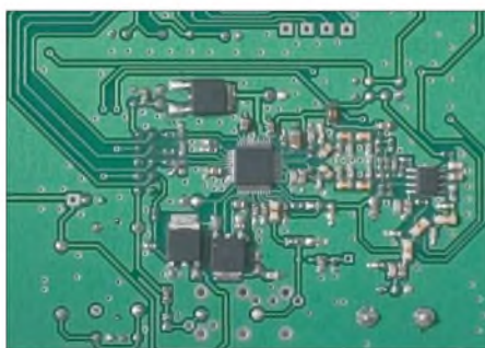
Bild 2: Detailansicht der werkseitig bestückten Platinenunterseite, etwa in der Mitte der 48-polige DDS-IC, rechts daneben die Aliasfilter, ganz rechts Endverstärker-IC, darunter Ausgangstiefpass
