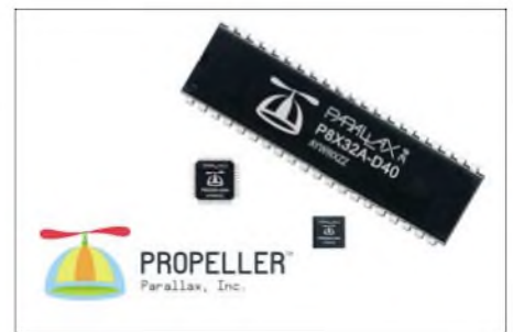
Bild 3: Den Propeller -Chip gibt es im 40-poligen DIP-Gehäuse und als jeweils 44-polige LQFP- bzw. QFN-Version.
