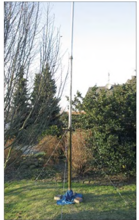
Bild 2: \lambda/4 -Vertikal für 40 m mit NVA-Mast
