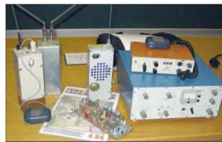
Teil der Geräteausstellung zur Festveranstaltung: hinten links der legendäre S23-Handfunksprecher mit „Geweih“ (FA 2+4/80), daneben 2-m-Geräte mit 600-kHz-ZF (FA 12/83 ... 4/84), rechts unten 150-W-FA zum 10-Band-KW-TRX ML-77 (FA 11/78 ... 4/82). Fotos: DL2RD, DL3VL
