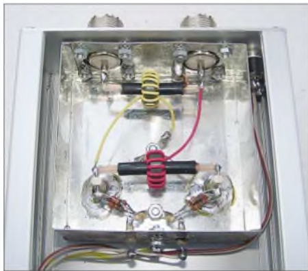
Bild 1: Für den direkt an den beiden Buchsen des Messgeräts anzubringenden Hybrid-Richtkoppler kann, wie hier, ein selbst gebautes oder ein kommerziell hergestelltes Exemplar dienen.
