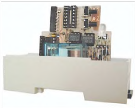
Bild 1: Um den Berührungsschutz zu gewährleisten, sollte ein Leergehäuse verwendet werden, in das sich Grund- und Modulplatte sowie das 230-V-Relais einbauen lassen.
