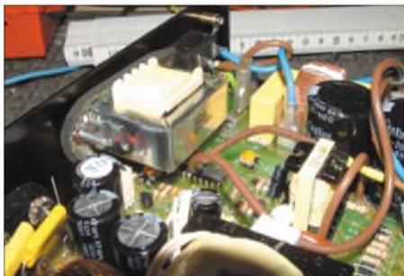
Bild 3: Um Platz im Schaltnetzteil zu schaffen, wurde die Netzdrossel an die Rückwand des Gehäuses verlegt.
