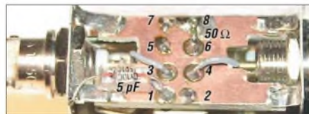
Bild 9: Platine mit quer liegendem PDC-20-1BD und 50-Ω-Referenzwiderstand vom Anschluss 6 gegen Masse. Für höchste Richtschärfe ist ein Kapazität von etwa 5 pF von Stift 1 nach Masse erforderlich.
