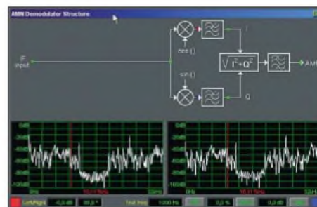
Bild 3: Der (optionale) Profi-Demodulator zeigt die Arbeitsweise eines Quadraturmischers
