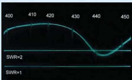
Bild 9: Anpassverhalten der zuvor am Standort Fensterbank optimierten Sperrtopf-antenne, dargestellter Frequenzbereich von 400 MHz bis 450 MHz mit 10-MHz-Frequenzmarken; die untere Horizontallinie zeigt SWV s = 1 , die obere s = 2 . Fotos: Autor
