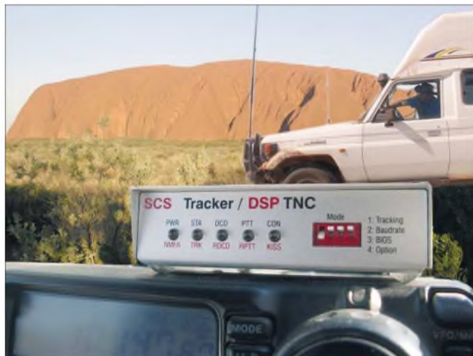
SCS-APRS-Tracker und Kurzwellen ermöglichen die Live-Übertragung der Fahrtroute durch Australien – ideal mit Robust Packet Radio.
