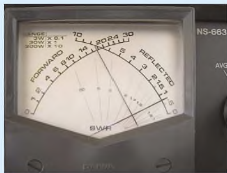
Bild 8: Nach geduldigem Abgleich war das Stehwellenverhältnis mit knapp unter s = 1,5 abzulesen.
