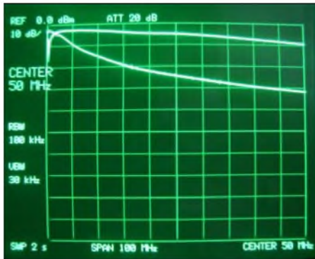
Bild 4: Verstärkung des Testaufbaus 0 bis 10 MHz (oben) und 0 bis 100 MHz (unten) mit REF = 50 dB Gain
