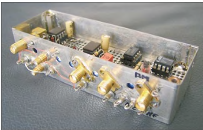
Bild 1: Ansicht eines Musteraufbaus des ZF-Verstärkers auf einer HF-Europlatine Fotos: DL7LA
