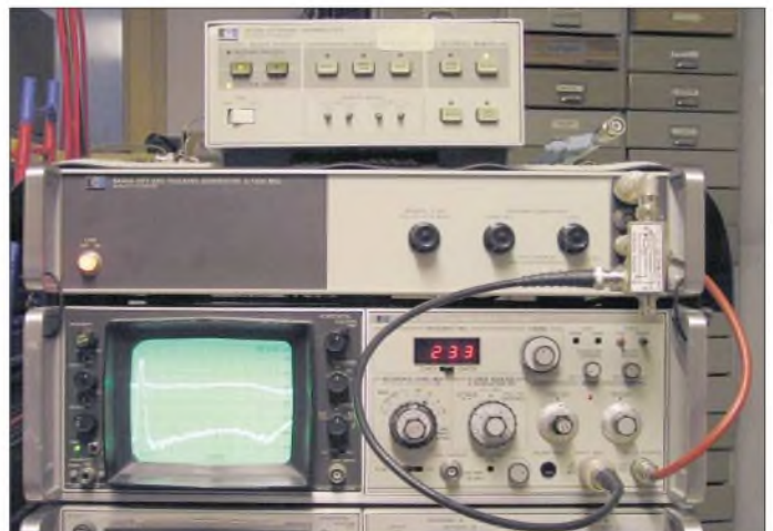
Bild 3: Messaufbau bei DG1UGA; oben Speicherzusatzzur gleichzeitigen Darstellung von Vor- und Rücklauf; in der Mitte Trackinggenerator, eingestellt 100 kHz bis 1 GHz. Der Prüfling steckt direkt am Ausgang. Unten Analysator mit Darstellung der frequenzabhängigen Richtschärfe als Abstand der beiden Kurven (obere Verlauf, untere Reflexionsfaktorverlauf).
