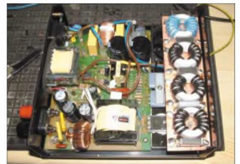
Bild 4: Blick auf das ins Netzteilgehäuse montierte Filter mit liegend montierten Ringkernen
