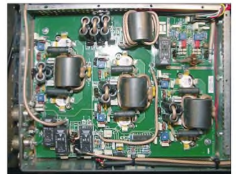
Bild 2: Unter der Haube: Der eigentliche HF-Teil besteht aus drei parallelgeschalteten Gegentaktendstufen.
