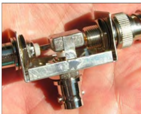
Bild 14: Eine Hand voll Koppler... Der breite Kupferstreifen bildet die Masseverbindung.
