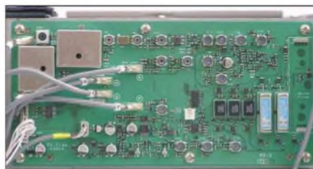
Bild 4: An der rechten Geräteseite ist separat der analoge Sub-Empfänger montiert. Rechts der Steckplatz für ein optionales schmaleres CW-Filter.
