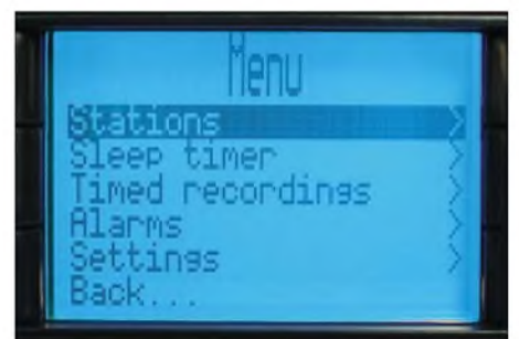
Bild 4: Über das Einstellmenü lassen sich auch Weck- und Abschaltzeiten programmieren.
