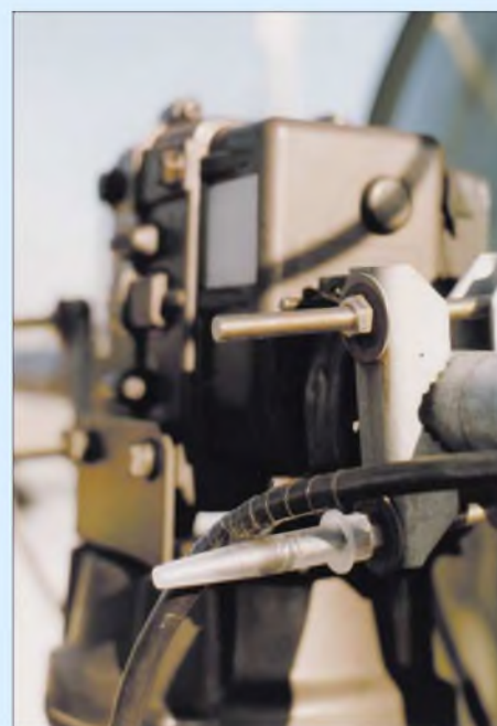
Die Plastikhülse schützt auch eine etwas zu kurz geratene Koaxialleitung vor dem Durchscheuern. Foto: Autor
