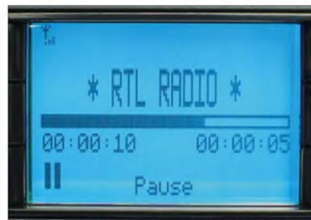
Bild 7: DAB- und DRM-Programme lassen sich im Empfänger zwischenspeichern und mit Zeitversatz wiedergeben.
