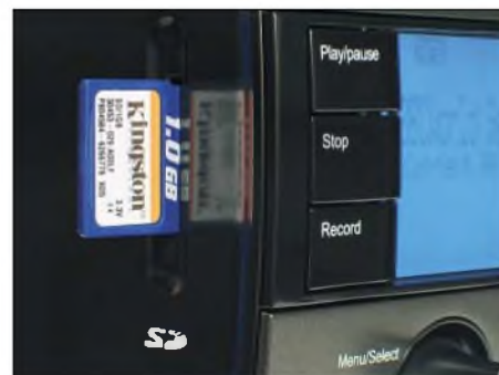
Bild 8: Der digitale Radiorecorder speichert DAB- und DRM-Hörfunksendungen auf SD- oder MMC-Karten.
