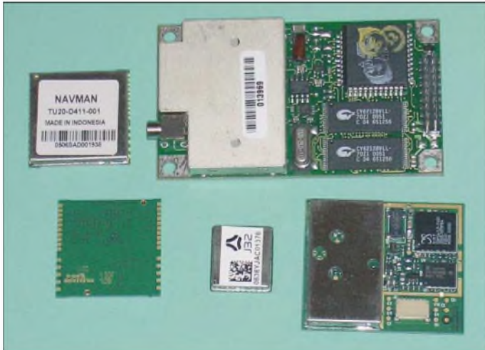
Bild 1: GPS-Module gibt es in verschiedenen Ausführungen, doch nicht alle können durch die notwendige Löttechnologie im Amateurbereich verarbeitet werden.
