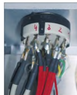
Bild 8: Relativ eng geht es am Drehschalter zu. Doch die abgeschirmten Kabel lassen sich mit etwas Geschick trotzdem gut anlöten. Fotos: DL3MCO
