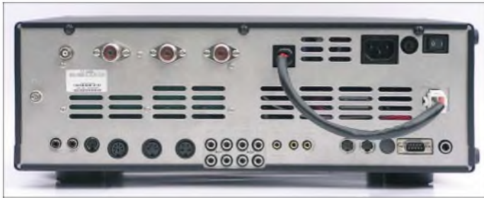
Bild 2: Die Rückfront offenbart neben diversen Anschlussmöglichkeiten vier Antennenbuchsen, zwei für den Sender und je eine für separaten Empfang und das Einschleifen eines externen Empfangsfilters.
