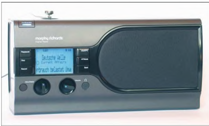
Bild 1: Morphy Richards bringt mit seinem Digital Radio den ersten Multistandard-Empfänger für alle terrestrischen Hörfunksysteme auf den Markt. Beim DRM-Empfang hilft ein zusätzlicher Empfangsdraht.
