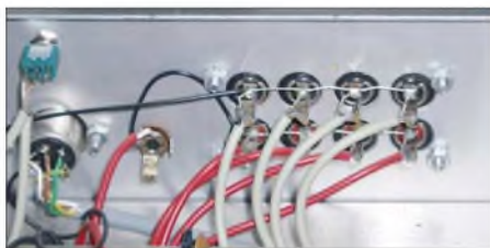
Bild 2: Verdrahtung der Cinchbuchsen in der Steuereinheit
