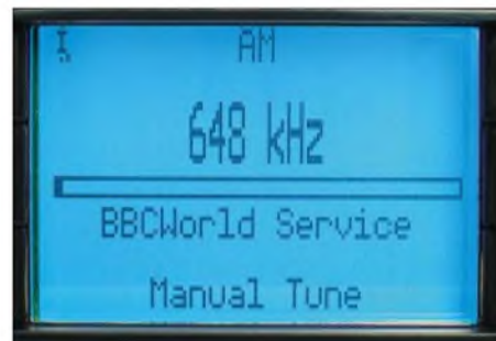
Bild 11: Auch eine manuelle Frequenzabstimmung ist möglich, wenn auch wenig komfortabel. Beim Empfang von AM-Stationen mit AMSS-Datenkanal zeigt der Empfänger unter anderem den Stationsnamen.
