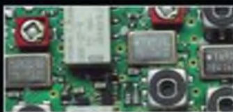
1. ZF: Drei Roofing-Filter bei 69,45 MHz
