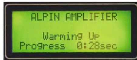
Bild 3: Der Countdown läuft – die Alpin 100 schützt die Röhre nach dem Einschalten.
