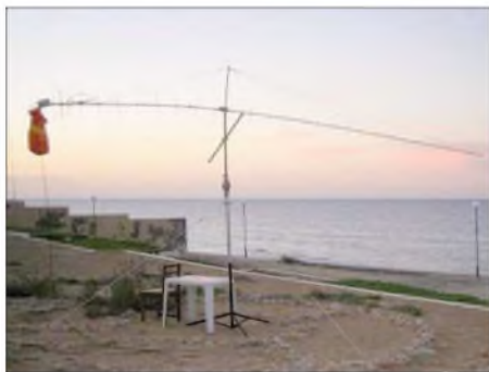
Direkt am Mittelmeer: die Spezial-Yagi von 5A7A. Man beachte den Sack am Ende des Booms für die Gewichte bei Elevationsbetrieb. Fotos: DL8YHR
