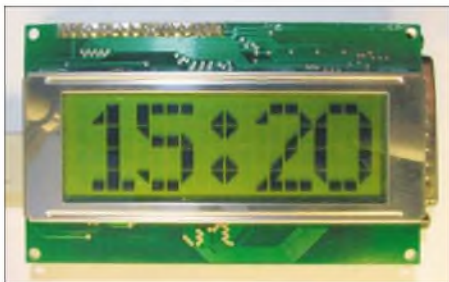
Bild 1: Mit mehrzeiligen alphanumerischen Displays lassen sich besser lesbare Grafikanzeigen aufbauen. Foto: Köhler
