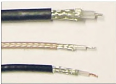
Bild 4: Übersicht verschiedener 50-Ω-Koaxialkabel, v. o. n. u. RG58C/U, RG316/U, RG174U
