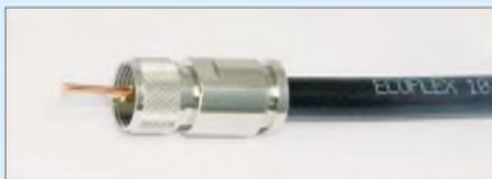
Bild 9: Ragt der Innenleiter aus der Hülse hervor, hat man gewonnen.
