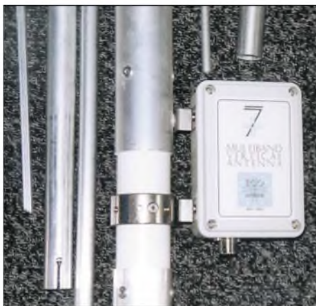
Bild 3: Der Anschlusskasten beinhaltet einen 1:4-Balun. Die Masse des Koaxialkabels ist mit dem isoliert angebrachten Metallring verbunden, der die Drahtspeichen aufnimmt. Der Strahler ist galvanisch mit dem Koaxialmantel und dem Speichenkranz verbunden.
