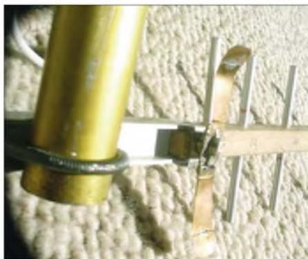
Bild 2: Detailansicht von Antennenhalterung (Doppel-T-Profil), Mastschelle, Boom (Vierkantholz) und Dipol (Kupferblech) mit Symmetrierung
