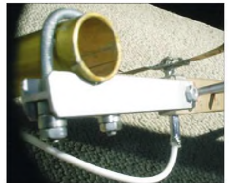
Bild 3: Detailansicht von Antennenhalterung, Mastschelle, Dipol mit Symmetrierung und Koaxialkabel sowie Ende des Booms aus anderer Perspektive Fotos: DJ1UR
