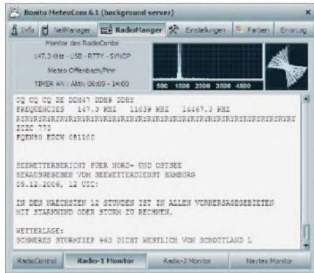
Bild 5: Der DWD sendet auf Langwelle solche Seewetterberichte. Das Abstimmkreuz oben rechts unterstützt die korrekte Frequenzeinstellung.
