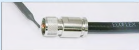
Bild 10: Nach dem Kürzen sind der Innenleiter und die Hülse zu verlöten.
