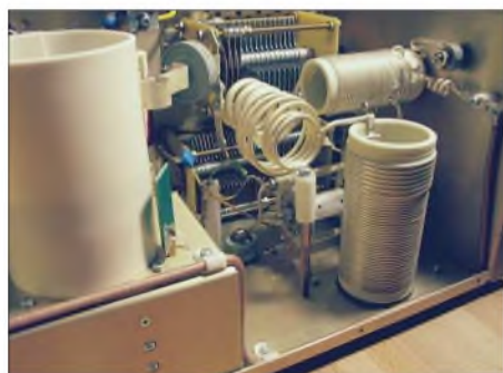
Bild 2: Der eigentliche HF-Verstärker, im Vordergrund links die Röhre mit Kamin
