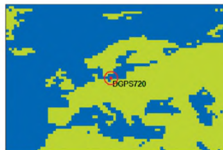
Bild 5: Auf Mausklick zeigt DSCdecoder den Ursprung eines decodierten DGPS-Signals auf einer Landkarte.
