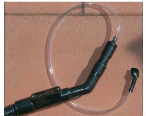
Erweiterung des normalen Haushaltstaubsaugers zu einem vollwertigen PC-Staubsauger – besser als jedes Exemplar für den USB-Port
