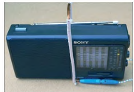
Bild 7: Legt man ein paar Windungen um einen Weltempfänger mit seiner Ferritantenne im Innern, lassen sich beliebige Schleifen- und Erdantennen ankopplern.
