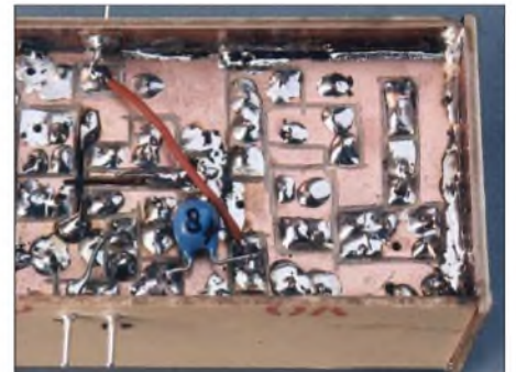
Bild 3: Detailansicht der Unterseite des Konverters mit gefrästen Leiterzügen
