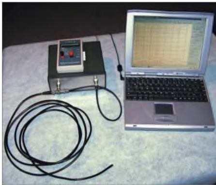
Bild 1: Messaufbau mit NWT und LC-Meter sowie Laptop
