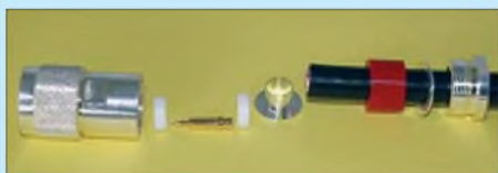
Bild 18: Mutter, Druckscheibe und Dichtung sind zuerst aufzufädeln.
