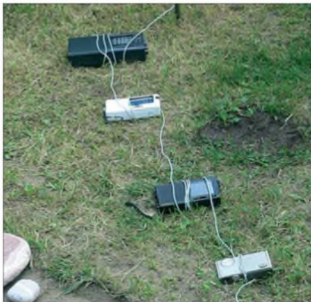
Bild 4: Während eines Versuches wurden mehrere Empfänger gleichzeitig über Kopplerwicklungen in eine große Schleifenantenne eingebunden. Die Empfangssignalerhöhung war beträchtlich.
