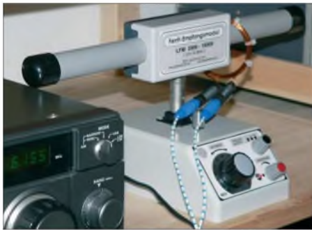
Bild 1: Der kleine Schleifenkoppler lässt sich durch Verschieben optimal an die Antenne, hier ein System von BAZ, anpassen.
