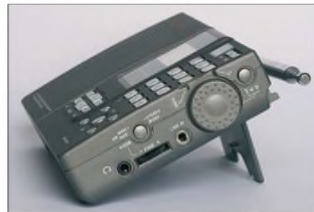
Bild 3: Über ein VFO-Rad auf der rechten Gehäuseseite lassen sich Frequenzen bequem manuell einstellen. Dort liegt auch die SSB-Feinabstimmung.
