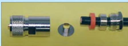
Bild 11: Reihenfolge der fünf Teile des Steckers PL-7 Clamp auf dem Aircell 7
