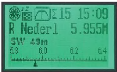
Bild 2: Das zweite LC-Display auf der Recordereinheit zeigt ständig Frequenz, Band, Uhrzeit und programmierte Stationsnamen.
