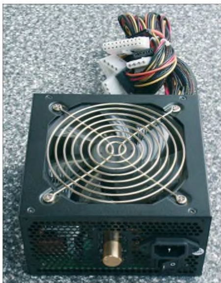
Höherwertige PC-Netzteile, wie dieses von SSM, besitzen einen leicht mit einem Lautstärkeregler zu verwechselnden Knopf für die Lüfterleistung. Fotos: DL2MCD
