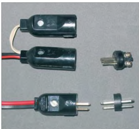
Bild 2: Stecker, Kupplung und Adapter Stecker/Stecker des alten Lautsprecherstecksystems; links oben Y-Verteiler
