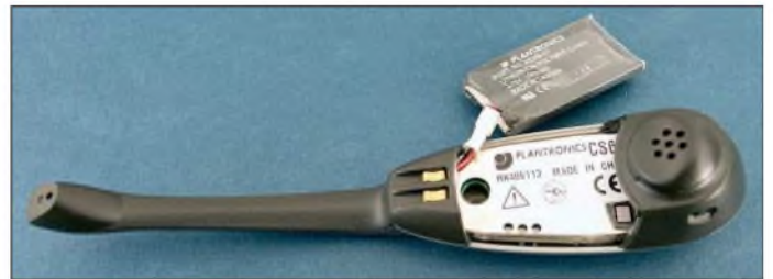
Blick ins Freetec-DECT-Headset: rechts die Mikrofonkapsel. Der goldbraune Draht (Pfeil) ist die Antenne.
