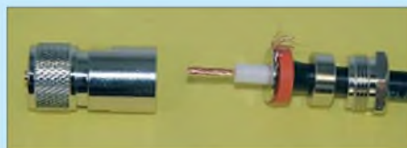
Bild 14: 7 mm der Innenisolation müssen bestehen bleiben.
