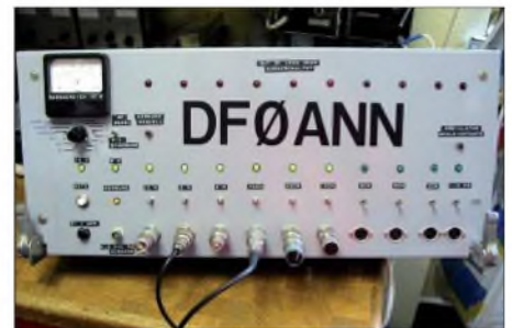
Basisstation der Bake, die Koaxialkabel ab 9 cm sind im Dachboden des Turmes nahe am Antennenfuß untergebracht, um die Leitungsdämpfung zu minimieren. Alle Frequenzen sind an einen Quarzthermostaten mit sehr hoher Genauigkeit über eine PLL angebunden. Fotos: DL8ZX
