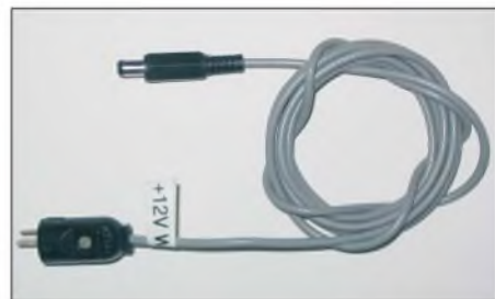
Bild 4: Beschriftung mittels Labelprinter für gerätespezifische Kabel
