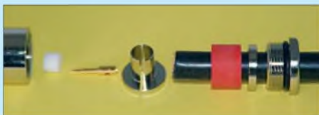
Bild 25: Wie gehabt sind Mutter, Druckring und Dichtung aufzuschieben.
