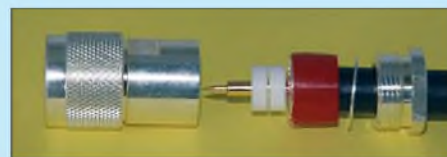
Bild 22: Vor dem letzten Schritt noch die zweite Isolations-scheibe aufstecken.
