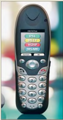
Das Handgerät des Fritz!Fon 7150 ist gleichzeitig ein DECT/VoIP-Telefon.
