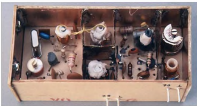
Bild 2: Draufsicht auf den vereinfachten Kammerbauweise ausgeführten Konverter
