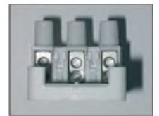
Bild 8: Die Draufsicht zeigt den Doppelanschluss. Fotos: DL3VL
