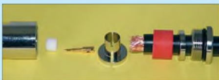
Bild 26: Der Mantel muss auf 6 mm entfernt werden.
