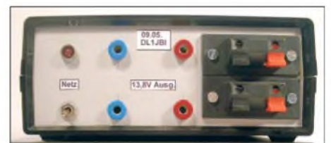
Bild 2: Stromversorgung mit zwei zusätz-lichen Doppelklemmen Fotos: DL1JBI
