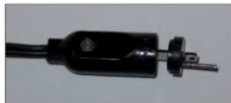
Bild 3: Innenleben eines minderwertigen Lautsprechersteckers – der Lötvorgang hat den Stift gelockert.
