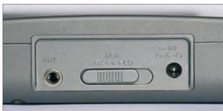
Bild 4: Ein dreifach schaltbarer Eingangsschwächer mindert Übersteuerungen beim Empfang mit Außenantennen.
