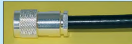
Bild 23: Die Mutter sollte man nicht bis zum Anschlag festdrehen – handfest reicht.
