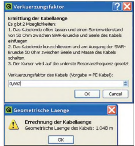
Bild 4: WinNWT berechnet entweder aus VF die mechanische Kabellänge oder aus dieser den Verkürzungsfaktor.
