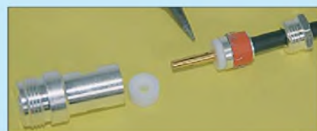
Bild 46: Zur Buchse gehören zwei Isolationsscheiben.
