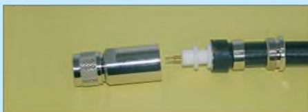
Bild 36: Das scheibenförmige Ende des Teflon-Isolators sollte zum Kabel zeigen.
