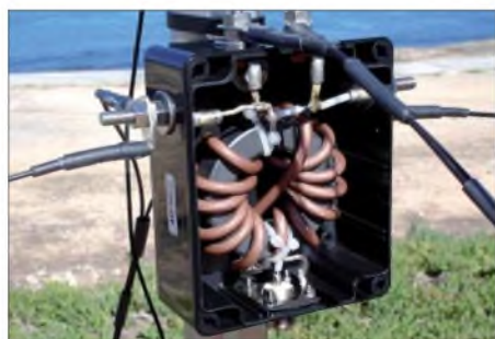
Die Einspeisebox des großen Spiderbeams
