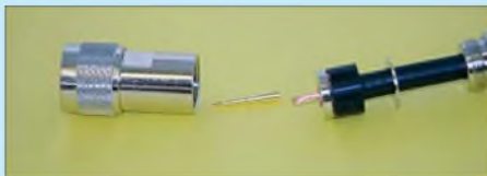
Bild 43: Beim Entfernen der Folie und des Dielektrikums bitte Vorsicht walten lassen.
