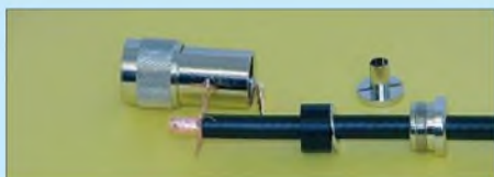
Bild 40: Im nächsten Schritt den Mantel auf 8 mm entfernen.
