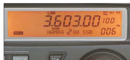
Bild 8: Das Display des IC-R8500 zeigt neben der Frequenz alle wichtigen Empfangsparameter. Speicherbänke sind mit fünf, Speicherplätze mit acht Stellen benennbar.
