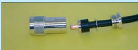
Bild 42: Das Geflecht wird sicher zwischen Kegel und Dichtung festgehalten.
