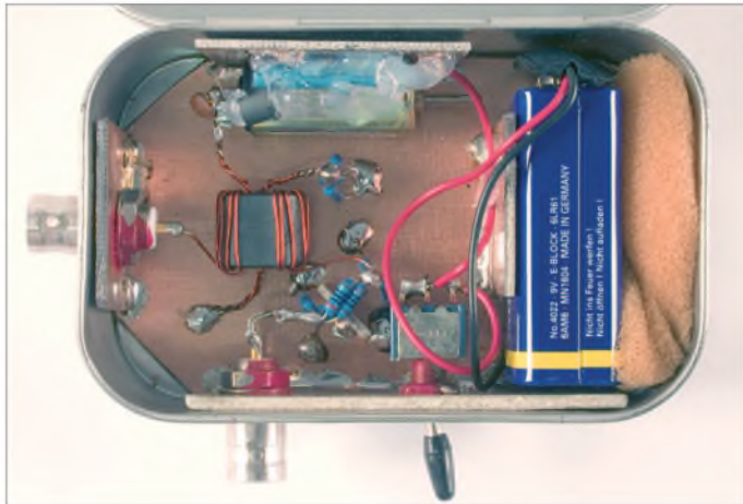
Bild 1: Der Gleichstrommotor als Rauschgenerator findet neben dem Richtkoppler, einer Batterie und einigen Kleinteilen problemlos in einer Blechdose Platz.
