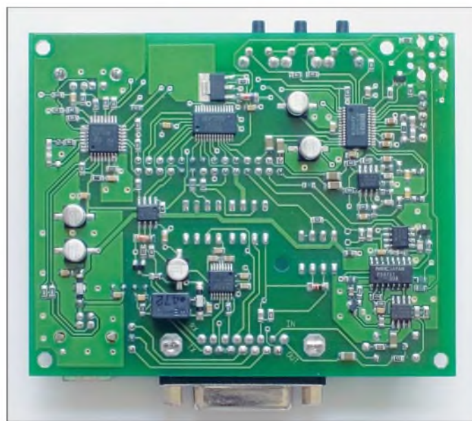
Bild 2: SMD-Seite der bestückten Platine – im FA-Bausatz industriell vorbestückt Fotos: Red. FA
