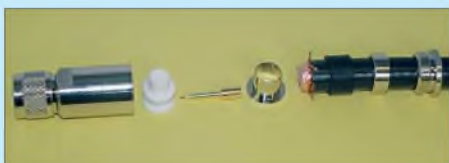
Bild 32: Der Mantel des Ecoflex muss auf 7 mm entfernt werden. Fotos: Fa. Kusch
