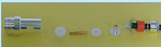
Bild 47: Nach dem Aufstecken der ersten Scheibe den Innenstift festlöten.
