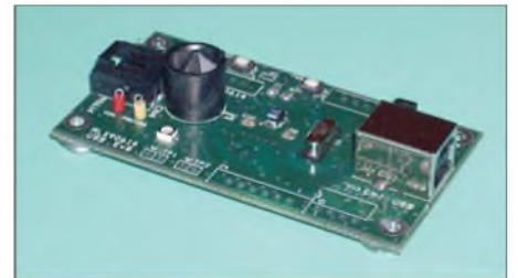
Bild 2: Mit dem Evaluationboard ist eine Neukalibrierung möglich. Der MLX90614 ist dafür in die runde Fassung zu stecken.
