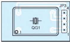
Bild 11: Bestückung der Platine des Quarz- oszillators
