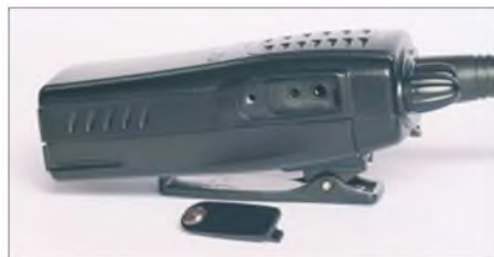
Bild 3: Die beiden Buchsen zum Anschluss einer Hörsprechgarnitur verstecken sich hinter einer Klappe, die vor eindringender Feuchtigkeit schützt. Fotos: DL1ABJ
