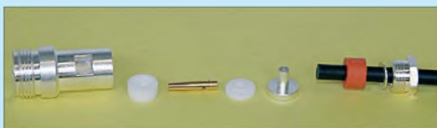
Bild 46: Zur Buchse gehören zwei Isolationsscheiben.
