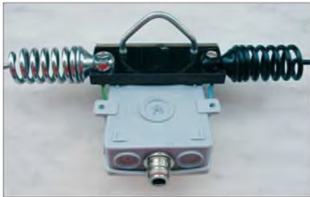
Bild 1: Eine Pertinaxplatte trägt beide Mobilstrahler, Mastschelle und Anschlusskasten.
