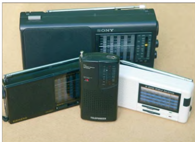
Bild 1: Ein Teil der ausgetesteten Empfangsgeräte; selbst mit dem einfachsten Modell (Bildmitte) war die behelfsmäßige Ortung möglich. Allerdings ist die Durchführung mit den AM-Empfängern mühevoll, da man sich stark konzentrieren und das Gerät möglichst dicht über den Boden führen muss. Daher ist die Anwendung nur für das Absuchen kleinerer Flächen ratsam.
