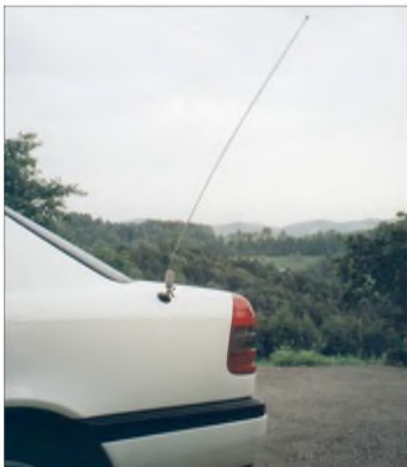
Bild 3: Mobilbetrieb auf 2 m und 6 m mit ein und demselben Strahler; 6-m-Mobilbetrieb in Deutschland nicht erlaubt! Foto: HB9QQ
