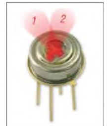
Bild 7: Der MLX90614ESF-ABA kann Wärmequellen aus zwei Richtungen feststellen, die hier nachträglich zugefügt wurden.
