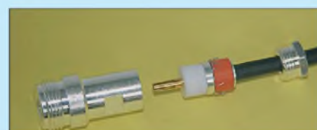
Bild 47: Nach dem Aufstecken der ersten Scheibe den Innenstift festlöten.
