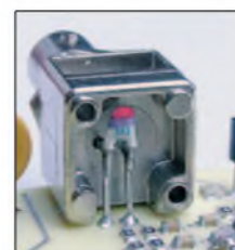
Bild 14: Kompensation der Induktivität der BNC-Buchse mithilfe eines bedrahteten 3,3-pF-Kondensators
