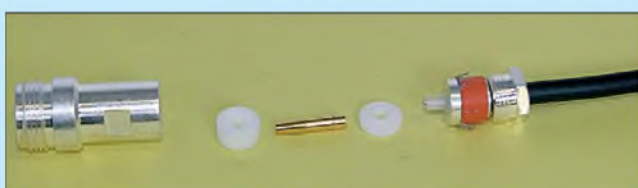
Bild 48: Nach dem Entfernen des Mantels das Geflecht entwirren.
