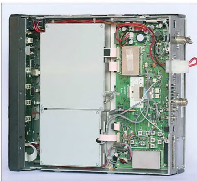
Bild 3: Der Innenaufbau orientiert sich an professioneller Empfangstechnik.
