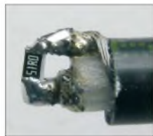
Bild 16: Anschluss der Referenz-Messobjekte an ein kurzes RG58-Kabel
