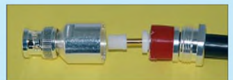
Bild 57: Den zweiten Isolator nicht vergessen.
