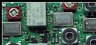
1. ZF: Drei Roofing-Filter bei 69,45 MHz
