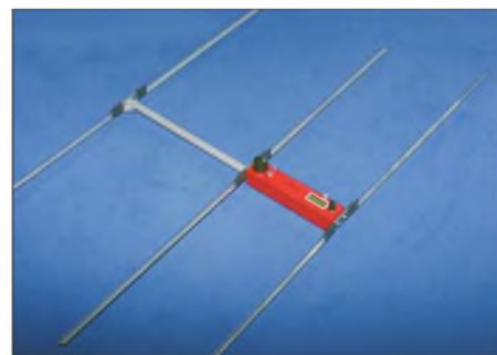
Bild 6: Die Elemente dieses Peilempfängers bestehen aus Abschnitten eines Stahl-Bandmaßes, die im Unterholz ohne Schaden zu nehmen nach hinten wegnickten.
