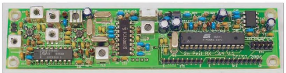
Bild 8: Ansicht der Langversion der Peiler-Platine
