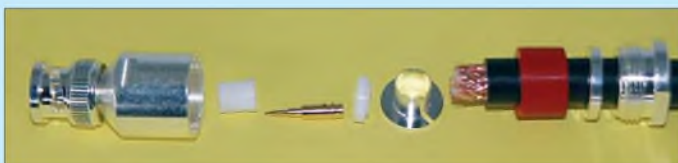
Bild 52: Der Mantel ist auf 6 mm zu entfernen.
