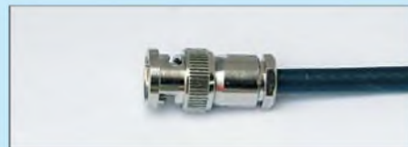
Bild 65: Ein kleiner Spalt ist zwischen Gehäuse und Mutter stehen zu lassen.
