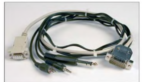
Bild 24: Ein aus einseitig konfektionierten Leitungen (Sub-D9, Cinch, Klinkenstecker), Sub-D15-Steckverbinder und Griffschalen aufgebautes Anschlusskabel für den Yaesu FT-847 Foto: Red. FA
