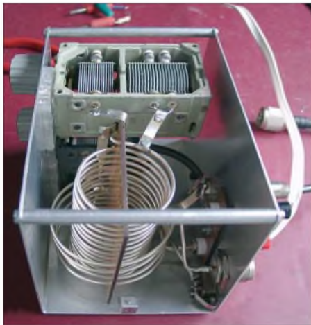
Bild 1: Z-Match von HB9BXE mit einer Spule aus 2 mm CuAg
