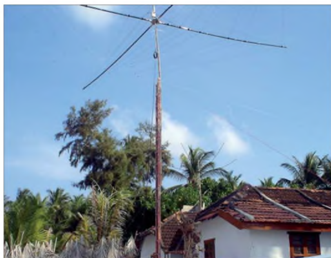
Einer von mehreren zum Einsatz gekommenen Spider-Beams auf Kadmat-Insel Fotos: DF2IC, DL4KQ, DL9GFB, JR3MVF
