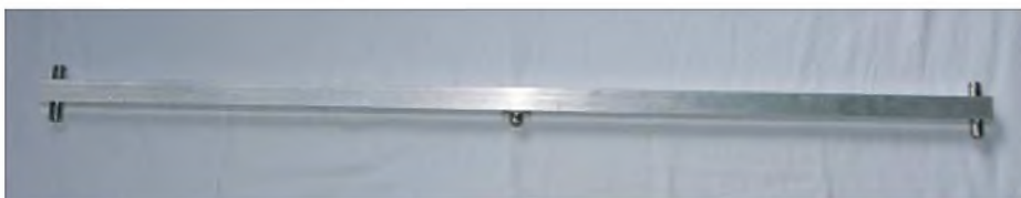
Bild 12: 2-m-Anpasstopf für vier Antennen nach dem Halbwellenprinzip
