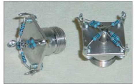
Bild 13: Selbstgebaute 50\text{-}\Omega -Abschlusswiderstände mit N-Buchse
