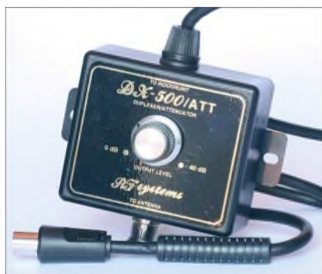
Bild 3: Bei Übersteuerungsproblemen auf Kurzwelle hilft dieses stufenlos einstellbare Dämpfungsglied.
