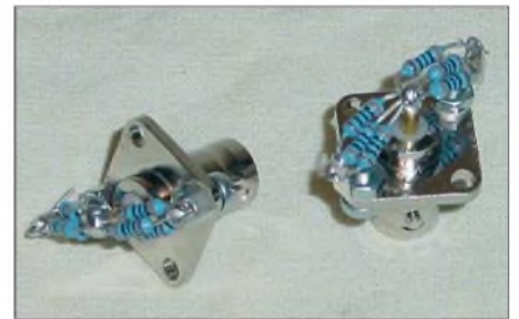
Bild 14: Abschlusswiderstände auf BNC-Basis Fotos und Screenshot: DK7ZB
