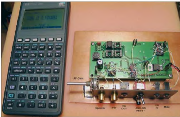
Bild 1: Erster Laboraufbau eines TRX-Moduls auf einer modifizierten Leiterplatte Alesis-RX2c; als Lokaloszillator kommt die DDS-Baugruppe nach [10] zum Einsatz.
