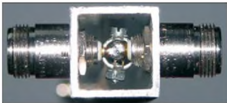
Bild 11: Anschluss eines Aluminium-Innenrohres an die Koaxialbuchsen
