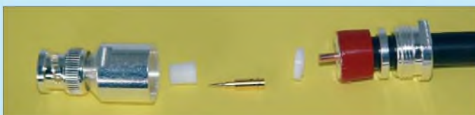
Bild 54: Entfernen von Folie und Dielektrikum
