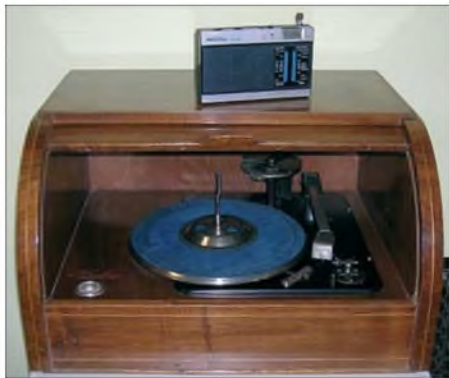
Das Transistorradio „Florida“ und die „Brottrommel“ - der Plattenspieler war das erste Kuba-Produkt überhaupt und hatte eine Nadelaufgabe von 0,5 N.
