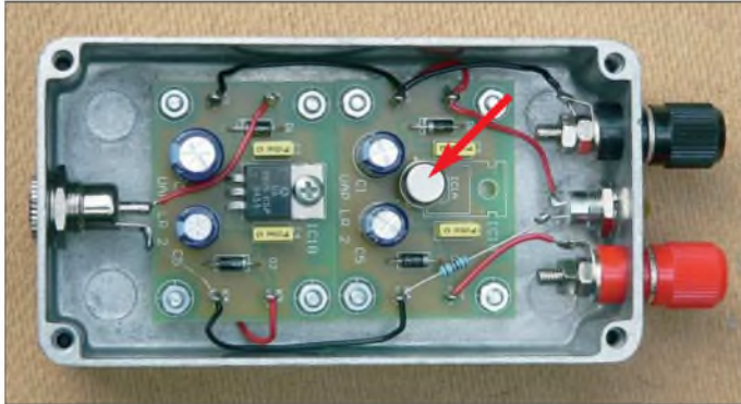
Bild 1: 10-V-Referenzgerät mit einem LH0070-2H als Spannungsreferenz. Die Platine UAP LR2 links dient zur Vorstabilisierung. Fotos: DG9WF
