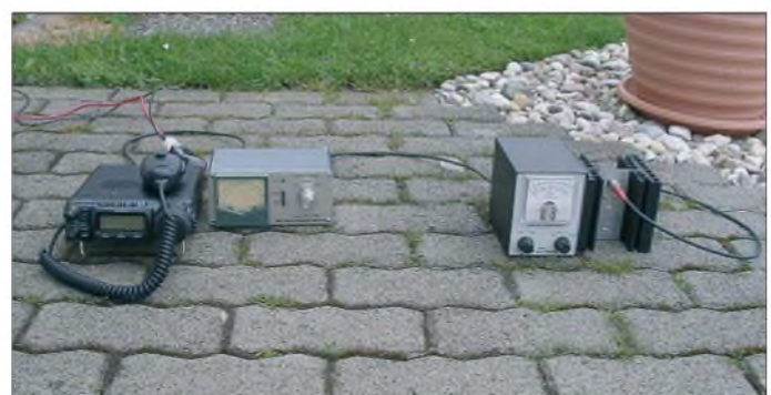
Bild 9: Verwendete Messtechnik, links FT-857 als Generator und Daiwa-Wattmeter CN-620, rechts OAK-Wattmeter WM1 und Abschlusswiderstand 100 W/2 GHz Fotos: HB9BXE
