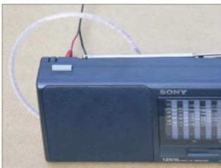
Bild 10: Beim Einsatz eines Antennenverstärkers lässt sich der Schleifenkoppler durch entsprechende Platzierung hinter dem Empfänger optimal an hohe Pegel anpassen.
