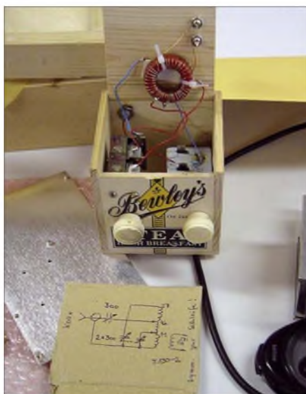
Präsentiert: QRP-Antennentuner von Tom, DL4NSE, in der Whiskey-Schachtel Foto: DL4NSE
