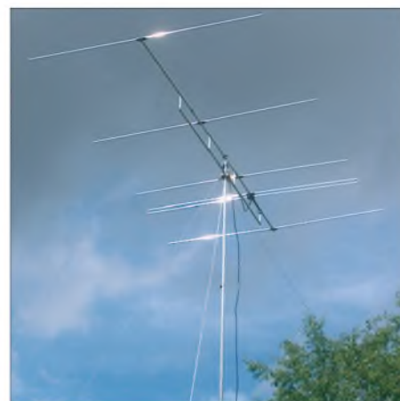
Antenne F6/5 an einem 10-m-Steckmast; zu anderen Antennen wäre genügend Abstand einzuhalten! Foto: DL2RD
