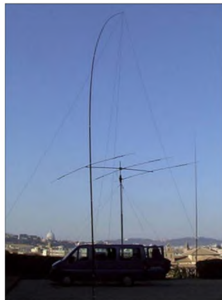
Die 40-m-Vertikalantenne sowie der A3S-Beam
