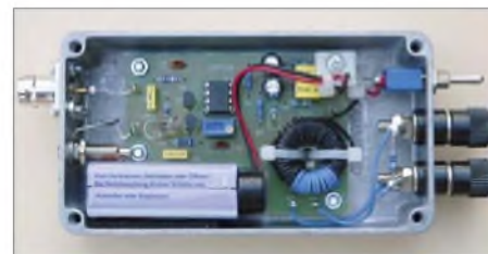
Bild 11: Der Einsatz eines Antennenverstärkers bietet sich bei langen Zuleitungen und Antennen mit geringen Ausgangspegeln an. Fotos, Screenshot: DG9WF
