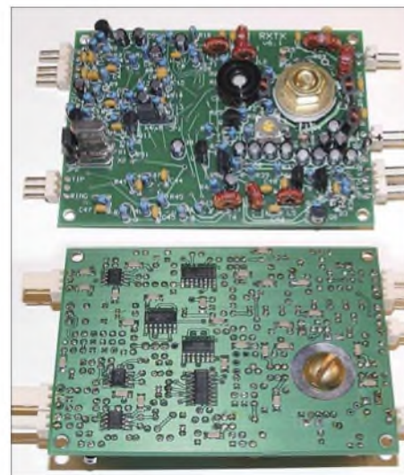
Bild 2: Ober- und Unterseite der bestückten Platine des SoftRock-Transceivers RXTXv6.1; der Kühlkörper für die beiden PA-Transistoren besteht aus einer dicken Messingschraube mit einer Unterlegscheibe von 18 mm Durchmesser.
