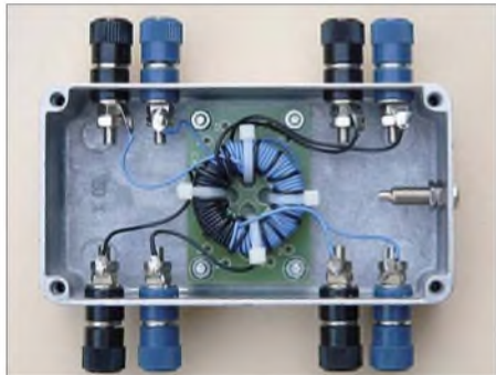
Bild 1: Durch das robuste Aluminium-Druckgussgehäuse und die Polklemmen, die auch Kabelschuhverbindungen zulassen, eignet sich der universelle Übertrager auch für den rauen Einsatz unterwegs.
