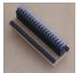
Bild 4: Die gewinkelte Stifteleiste auf einer Universalplatine dient als Adapter für Steckbrettaufbauten.
