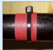
Bild 2: Sicherung der Elemente einer Angelrute mit Isolierband und Kabelbinder Fotos: DC1DV
