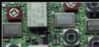
1. ZF: Drei Roofing-Filter bei 69,45 MHz
