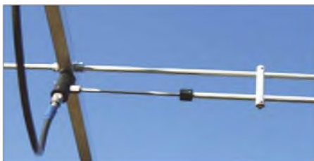
Bild 2: Gamma-Anpassung mit SO239-Buchse für hohe Leistungen
