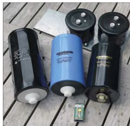
Bild 1: Hochvolt-Aluminiumkondensatoren mit hoher Kapazität besitzen eine beachtliche Größe. Als Vergleich erkennt man im unteren Teil eine 9-V-Blockbatterie, auf der ein Standard-MKT-Kondensator liegt.
