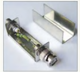
Das 30-dB-Leistungsdämpfungsglied BX-064 ist schnell aufgebaut und für 8,50 € erhältlich.
