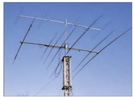
Bild 4: Fünfelement-Yagi 2,5 m (besser wären 3,5...4 m) über einer Cushcraft X7 in 14 m Höhe, 390 m ü. NN Fotos: DD7DX
