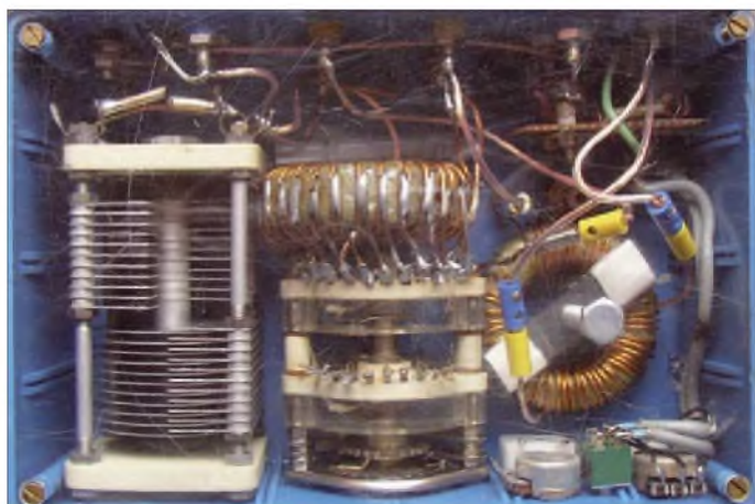
Bild 3: Drehkondensator, schaltbare Spule und Festinduktivität wurden in einem handlichen Gehäuse untergebracht. Die Plexiglasabdeckung auf der Unterseite hat durch den Einsatz ein paar Kratzer abbekommen.
