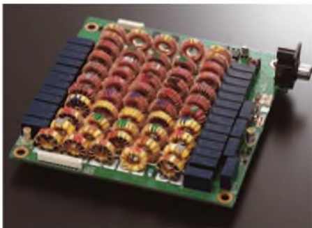
Bild 4: Mit Relais geschaltete Suboktav-Eingangsfiler für den KW-Bereich (links) Bild 5: Zwei 32-Bit-DSPs übernehmen die gesamte Signalverarbeitung und die Ansteuerung des Spektromskops. Fotos: Werkfotos
