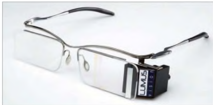
Bild 2: PD-21 (320 x 240 Pixel, QVGA, 22° Bildwinkel) oder PD-25 (640 x 480 Pixel, VGA, 27,5° Bildwinkel) – die einkoppelnden Segmente im Glas sind nur ganz aus der Nähe zu erkennen.
