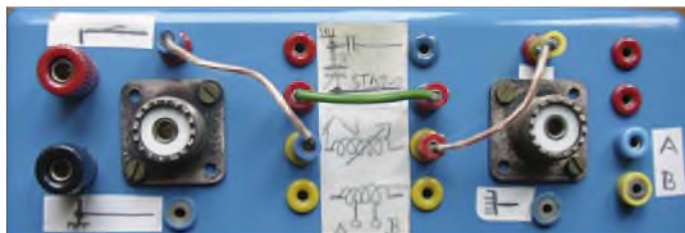
Bild 2: Die Konfiguration des L-Glieds lässt sich auf der Rückseite stecken.
