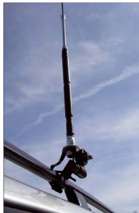
Antennenbefestigung an der Dachreling; links ist das Masseband zu erkennen.
