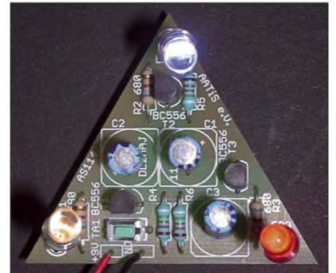
In der Variante AS114K ist das Blinkdreieck mit drei verschiedenfarbigen LEDs insbesondere für den Aufbau eines elektronischen Kaleidoskops geeignet. Fotos: AATiS
