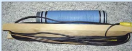
Bild 7: Portabelvariante der 80-m-Antenne mit Verlängerungsspule bei 1/3 der Länge
