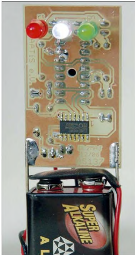
AS137: Die Draufsicht zeigt die Platine im Größenvergleich zu einer 9-V-Batterie sowie die Anordnung (oben) der LEDs für den Lichteffekt als „Leuchtturm“ mit scheinbar umlaufendem Lichtstrahl.
