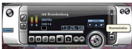
Bild 4: Bedienungsoberfläche „Modern Black Panel“, linke Skala Feldstärke, rechte vermutlich Bitfehlerrate (grün = optimal)
