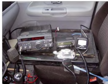
KW- und VHF-Station auf dem Beifahrersitz, außerhalb des direkten Blickfeldes; die Geräte sind auf einer Platte stabil befestigt. Im Fußraum des Beifahrers befindet sich in einem Holzkasten die zweite gepufferte Batterie. Fotos: DL9OBL
