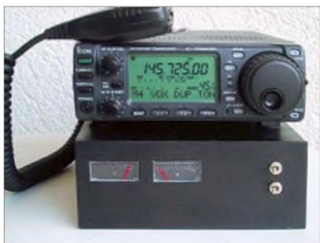
Bild 1: Ein wie füreinander geschaffenes Gesamtgerät aus dem IC-706 und dem 25-A-Netzteil
