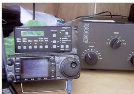
Blick auf eine Station in der „Felsen-Kiste“. Zum Einsatz gelangten IC-7000-Funkgeräte, Acom-1010-Endstufen und SteppIR- (10 bis 40 m) Vertikalantennen. Eine kompakte und verlässliche Ausrüstung, die uns in der un-wirtlichen Umgebung niemals im Stich ließ.
