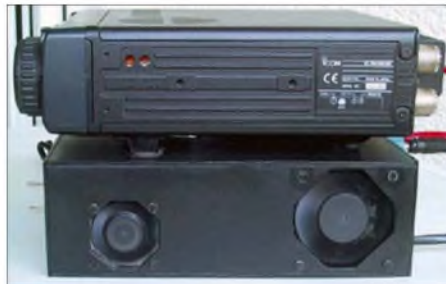
Bild 5: Seitenansicht des Netzteils; die größeren Ventilatoren sind dem Kühlkörper zugeordnet. Fotos: DL1AKE
