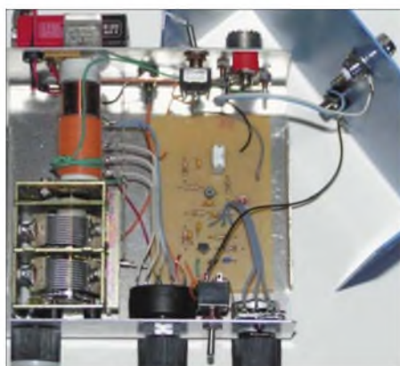
Bild 4: Innenleben des ADDX-Verstärkers, auch als Bausatz erhältlich
