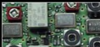
1. ZF: Drei Roofing-Filter bei 69,45 MHz
