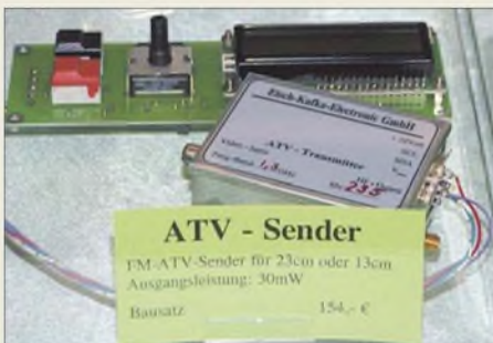
Eisch-Kafka-Electronic hatte u. a. diesen ATV-Sender für 23 bzw. 13 cm mitgebracht.
