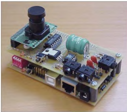
Bild 1: Ansicht des einsatzbereiten SSTV-Moduls inklusive des universellen PIC-Boards aus [1]; als Bildaufnehmer dient das links zu sehende, kompakte Kameramodul mit Digitalausgang. Foto, Screenshot: OE1RIB
