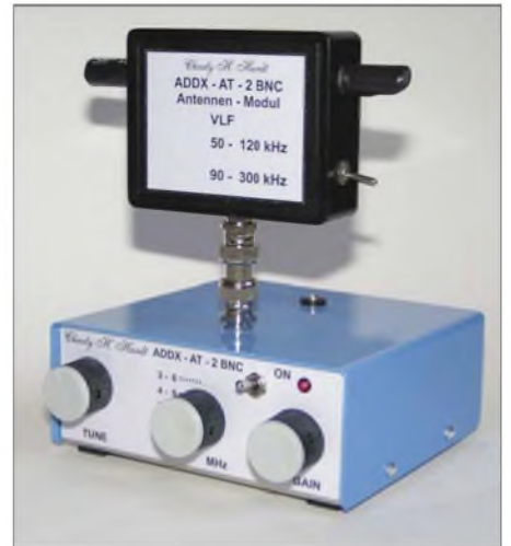
Bild 8: ADDX -Verstärkermodul mit VLF/LW-Ferritantenne
