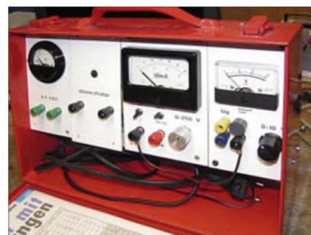
Bild 3: Das Röhrenprüfgerät in diesem Werkzeugkoffer ist modular aufgebaut. Reparaturen oder spätere Modifikationen an solchen Geräten sind deutlich einfacher.
