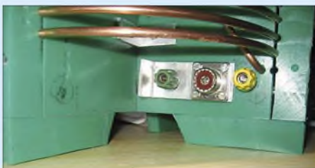
Bild 13: Stabile Montage der Anschlüsse für Koaxialkabel und Erdungsleitungen
