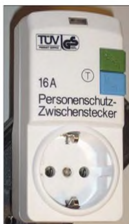
Bild 10: Als Alternative für den Festeinbau bieten sich gerade für kurze Messungen an netzbetriebenen Geräten Fehlerstromschutzschalter in Form von Zwischensteckern an. Der Auslösestrom ist bei ihnen oft auf der Rückseite vermerkt. Fotos: DJ3TZ
