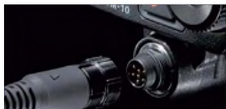
Bild 3: Optionale Handmikrofone werden wasserdicht angeschraubt, hier an die optionale Buchse an der Unterseite des Bedienteils.
