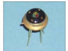
Bild 3: Bei den RGB-Farbsensoren der MCS3-Serie kann man die drei Farbbereichsfilter deutlich erkennen. Foto: Sander
