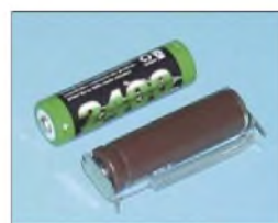
Bild 5: Der Sensor TGS5042 besitzt die Form und Größe einer Mignonzelle. Foto: Sander
