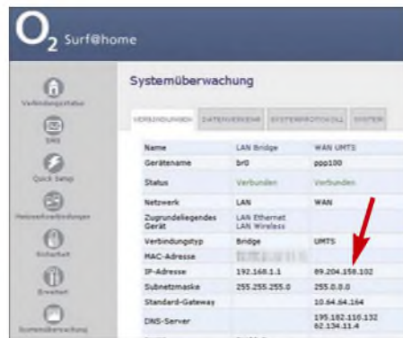
Bild 10: Beim UMTS-Router von O2 ist die aktuelle IP-Adresse in der Systemüberwachung nachzulesen. Screenshots: DD6AE
