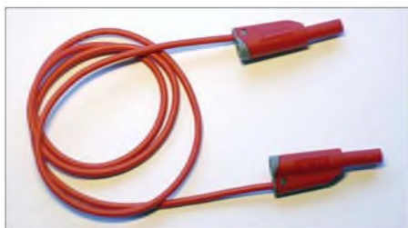
Bild 7: Bitte verwenden Sie im eigenen Interesse nur Messkabel mit berührungssicheren Steckern zum Anschluss eines Multimeters an den Messadapter.
