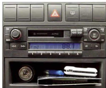
Bild 1: Original-Werksradio „VW Alpha“. Trotz Digitalanzeige kein Digitalradio, empfängt nur analog UKW und Mittelwelle.
