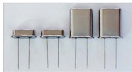
Bild 7: Quarze im HC-49US-Gehäuse sind für CW-Filter günstiger als die größeren HC-49U-Varianten.
