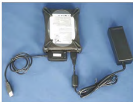
Bild 3: Anschluss einer Standard-3,5"-IDE-Festplatte mit übergezogenem Silikonummischutz an USB-Adapter und Netzteil: Fertig ist die preiswerte Speichererweiterung!
