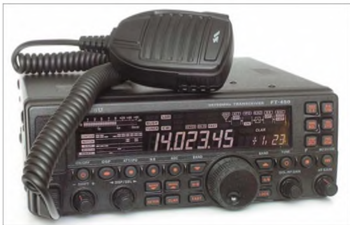
Bild 1: Frontansicht des FT-450 mit seinem voluminösen Mikrofon. Bestehend ist das große und übersichtliche Display in Negativ-Schwarz/Weiß. Das S-Meter-„Instrument“ zeigt beim Senden wahlweise die Ausgangsleistung, das SWV oder den ALC-Pegel an.
