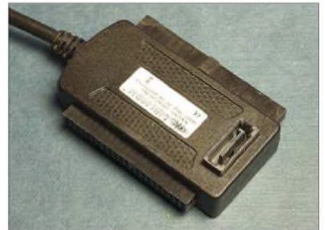
Bild 4: Unten IDE 2,5 Zoll, oben IDE 3,5 Zoll, rechts SATA: Am USB-Adapter sind alle üblichen Festplattenverbindungen vorhanden Fotos: DL2MCD
