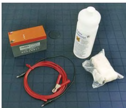
Bild 2: Das ist die komplette Ausstattung: Eine Flasche Elektrolyt, Elektroden und Tampons des Galvanosets. Nicht zu vergessen, eine ausreichend starke Stromquelle. Hier ein kleiner Blei-Gel-Akkumulator, es kann aber auch ein entsprechend belastbares 12-V-Netzteil sein.
