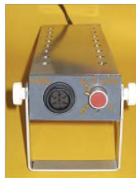
Bild 4: An der Frontseite des Reglers befinden sich die Anschlussbuchse des LötKolbens und der Einstellknopf für die Temperatur. Fotos: DC5ZM
