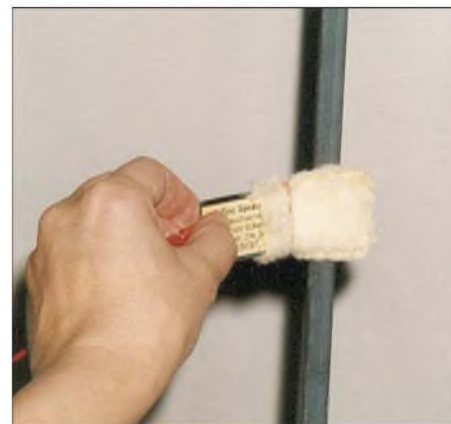
Bild 3: Galvanisieren leicht gemacht: Werkstück mit dem negativen Pol, Elektrode mit dem positiven Pol der Stromquelle verbinden. Tampon aufstecken, in den Elektrolyt tauchen und los gehts. Fotos: DL1MEH
