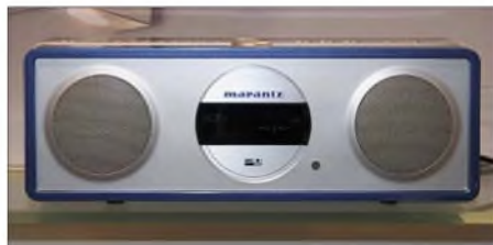
Bild 7: PLC durch die Hintertür: Marantz vernetzt per Stromleitung Audiospieler in der ganzen Wohnung. Loewe hat ein vergleichbares System für Fernseher eingeführt.
