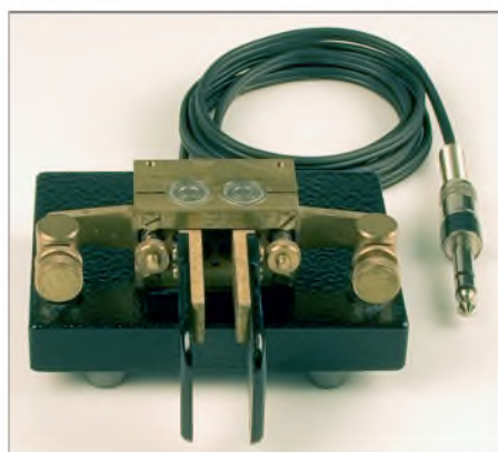
Bild 3: Elbug-Mechaniken wie diese von Kent Engineers sind heute sehr beliebt, weil die in modernen TRX integrierte Keyer-Funktion eine separate Elbug-Elektronik entbehrlich macht. Beim Parallelschalten der Key-Leitung vom PC kommt es dann zu Problemen, siehe Text und [9]. Fotos: Red. FA
