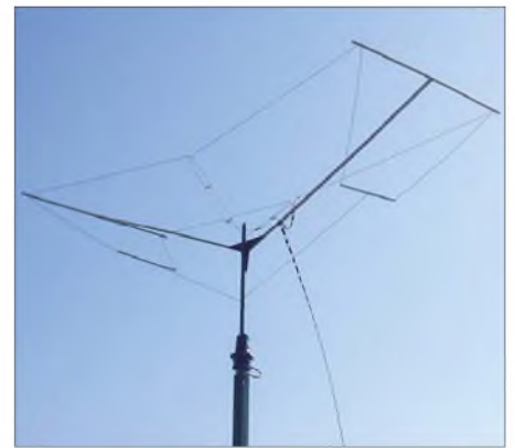
Bild 8: Diese Ansicht lässt Phasenleitung, Speiseleitung und Abstandshalter gut erkennen.
