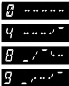
Bild 7: Der Sendefrequenzgang lässt sich durch einen im Menü sehr anschaulich dargestellten DSP-Equalizer optimieren. Bei 0 wird er umgangen. 4, 8 und 9 sind Frequenzgänge mit Höhenanhebung.
