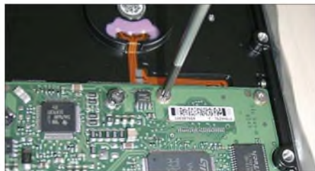
Bild 4: Ausbau der defekten Steuerplatine mit Torx-8-Schraubendreher.
