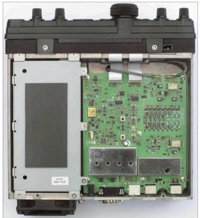
Bild 5: Innenansicht von unten, links im Bild die nachträglich eingebaute Antennenabstimmereinheit ATU-450, goldfarben daneben der TCXO
