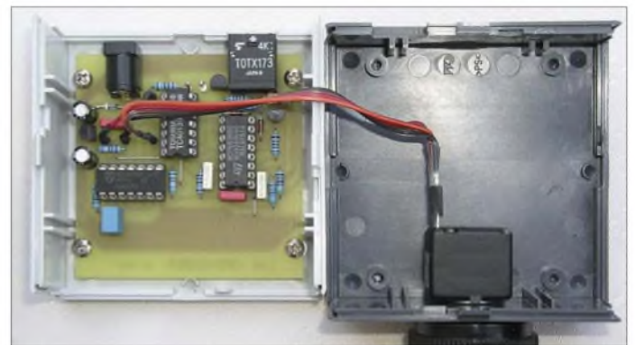
Bild 1: Die Empfängerbaugruppe ist in einem Aluminiumgehäuse einzubauen.
