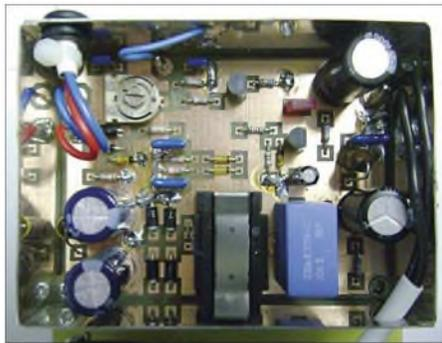
**Bild 1: Elektronische Anodenbatterie im Weißblechgehäuse** Foto: DB1NV
