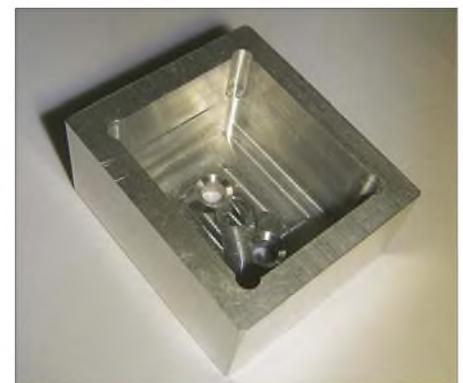
**Bild 8: Frästeil des Gehäuses**
