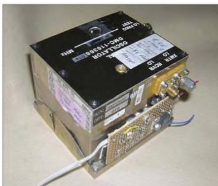
**Bild 5: Ansicht des Oszillators mit Spannungsversorgung**
