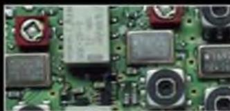
1. ZF: Drei Roofing-Filter bei 69,45 MHz
