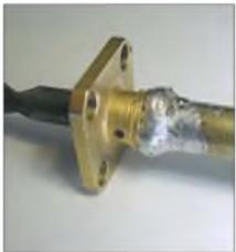
**Bild 10: SMA-Buchse als Hohlleiterflansch**
