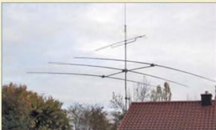
Seit einigen Jahren machen – nicht nur in DXpeditionsberichten – SteppIR-Antennen von sich reden, bei denen die Elementlänge mikrocontrollergesteuert dem jeweiligen Band angepasst wird. Wie funktioniert das und was gibt es beim Aufbau einer solchen Multibandantenne zu beachten? Foto: DC9AT
