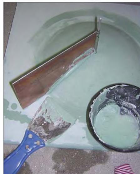
Bild 14: Herstellung der Gipsform für den Parabolspiegel
