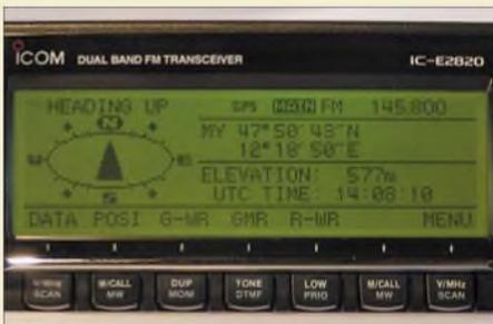
Icoms neuer 2-m-/70-cm-Mobiltransceiver IC-E2820 fällt zunächst durch ein großes Display auf, das bereits eine clevere Menüführung erahnen lässt. Weitere Neuheiten sind die D-Star- und GPS-Option – hier im Bild das GPS-Display – sowie das sehr nützliche Selection Diversity. Foto: DO3MT
