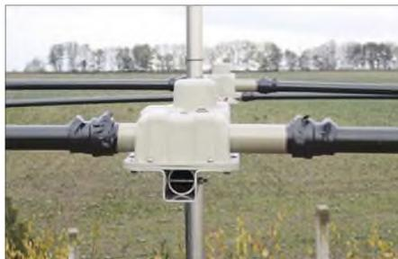
**Bild 16:** Eingesetzte Elemente mit zusätzlich unwickelten Muffen
