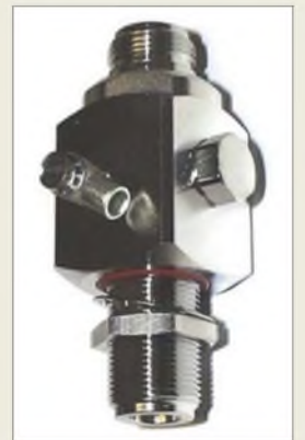
Die Ausführung LPN-BL eignet sich durch das verlängerte Gewinde der einen N-Buchse auch als Gehäusedurchführung.
