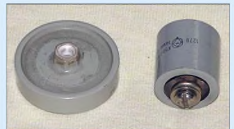
Bild 3: Spannungsfeste Kondensatoren aus russischer Militärtechnik
