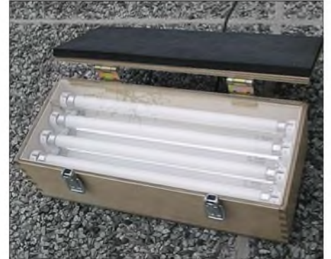
Bild 4: Beleuchtungsgerät im innen verspiegelten Sperrholzkasten
