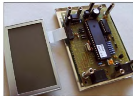
Dieser PSK31-Controller (Bausatzpreis 48 €) soll zunächst in AATiS-Workshops aufgebaut werden. Das relativ große grafische Display dient der Darstellung von Text und des NF-Spektrums.
