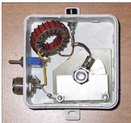
Bild 4: Fertig aufgebautes L-Glied nebst Bandumschaltung in einer Elektroinstallations-Feuchtraumdose
