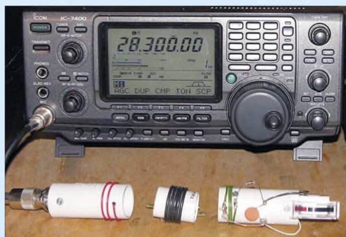
Bild 6: Praktisches Ausmessen eines Koaxialkabeltraps für 28,3 MHz
