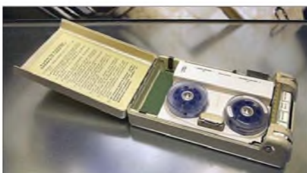
Bild 12: Tondraht-Diktiergerät „Minifon Attache“, Protone, gebaut 1958 bis 1962, vier Transistoren, auch für Spionage mit Mikrofon in Krawattennadel oder Uhr
