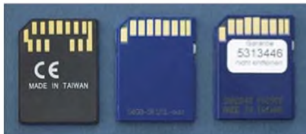
Bild 2: Neben geringfügig unterschiedlicher Dicke fallen bei Multimediacards (links) gegenüber SD (Mitte, rechts) lediglich mehr Anschlüsse und der fehlende Schreibe-Schieber auf.
