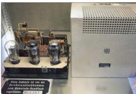
Bild 10: Telefunken-Ela-Verstärker von 1937 mit zwei AD1, 10 Watt Ausgangsleistung
