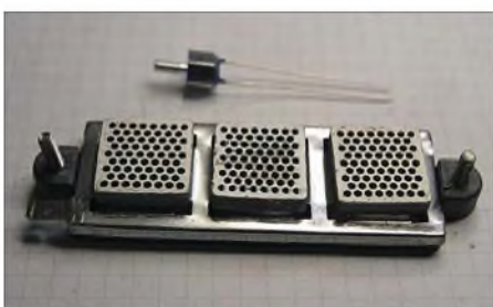
Bild 2: Ansicht des Keramikheizelements und des Heißleiters
