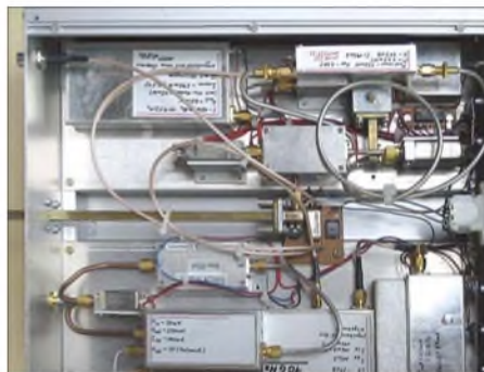
Blick in den Dualbandtransverter 10/24 GHz mit Kombispiegel von Dr. Wilfried Werkmeister, DK9WW
