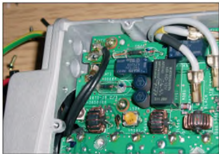
Bild 1: Die Pigtails wurden entfernt und dafür RG174-Kabel angelötet. Fotos: DL3MCO
