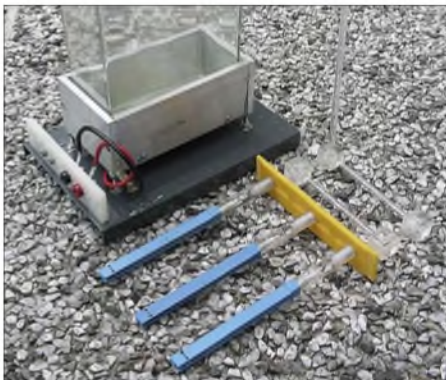
Bild 1: Das Glasgefäß steht in der beheizten Aluminiumwanne, während die Platine später beim Ätzen an Leiterplattenhaltern festhängt.
