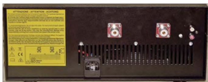
Bild 7: An der Rückseite sind neben den beiden HF-Buchsen PTT-Eingang und ALC-Ausgang in Cinch-Norm angebracht.
