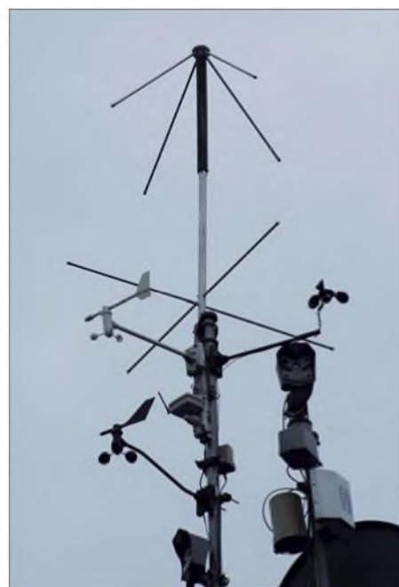
Bild 3: Blick auf den Mast mit Anemometer, Böenmesser und Wetterkameras
