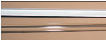
Bild 6: Die Faser erscheint zunächst einmal glasklar. Sie strahlt, wenn der Reflektor auf der Rückseite liegt, das seitlich eingetretene Licht durch Reflexion wieder ab.
