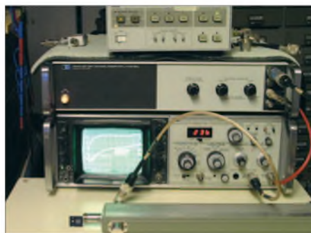
Bild 11: Messaufbau mit kommerziellem Spektrumanalysator und Richtkoppler
