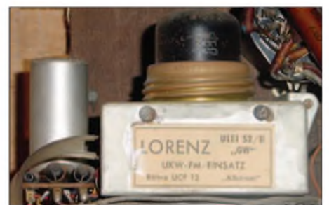
Bild 10: Einfacher Pendelaudion-Empfänger mit UCF12 (hier von Lorenz).
