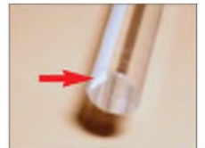
Bild 7: Bei dieser Faser ist links der weiße Reflektor zu erkennen. Fotos: Sander
