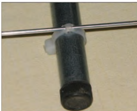
Bild 2: Befestigung von Elementen mit Kabelbindern an einem Angelruten-Boom
