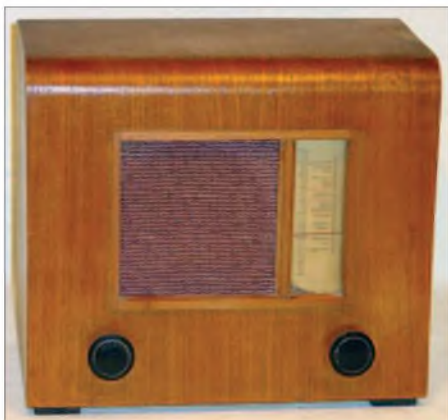
Bild 2: Notradio mit der RV12P2000: Schaub E47 von 1947
