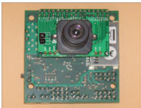
Bild 1: Die CMUCam3 wird betriebsfertig als geprüftes Modul geliefert.
