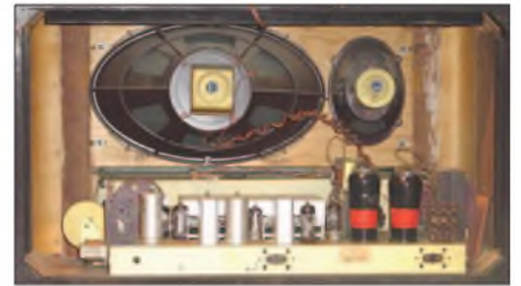
Bild 14: Innenansicht des Grundig 5010 mit den zweimal EL12-Endröhren
