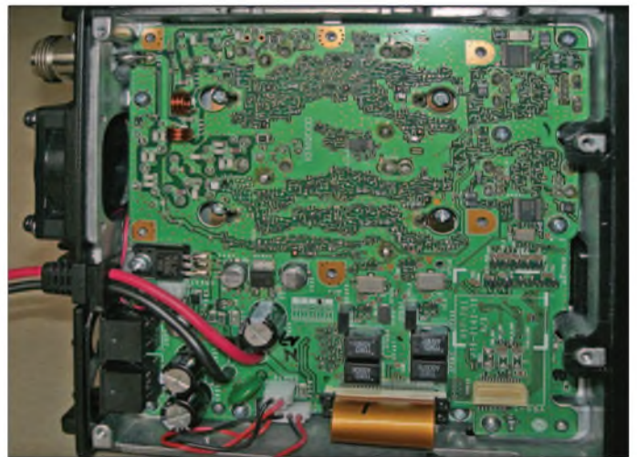
Bild 5: Kleinste SMD-Bauweise beherrscht das Innenleben, Bauteile sind kaum noch zu identifizieren.
