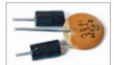
Bild 11: Dreipolkondensator mit Verdrosselung der Anschlussdrähte durch Ferritperlen
