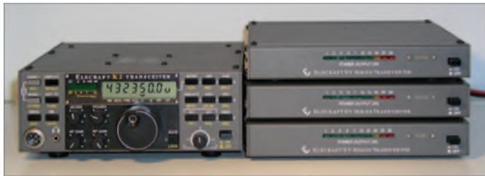
Bild 2: Anschluss der Transverter am K2 Fotos: DL7MAJ
