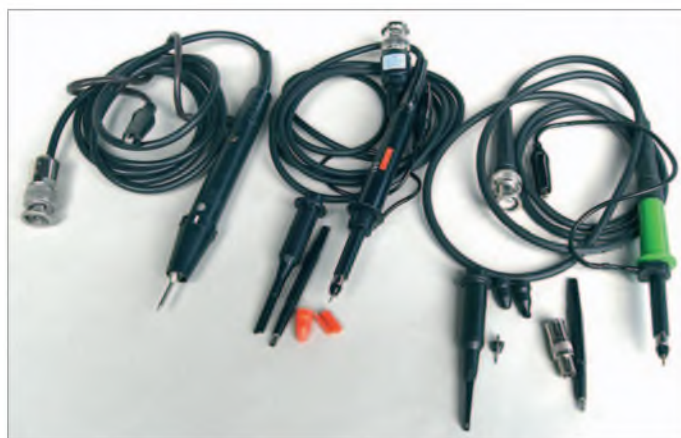
Bild 11: Wer am Tastkopf spart, spart am falschen Ende. Bereits die Mechanik entscheidet über Arbeitserleichterung oder Kontaktprobleme. Die minderwertige Krokodilleme des OP1M-Tastkopfs (links) sorgt z. B. eher für Verdruss als für eine ordentliche Masseverbindung.
