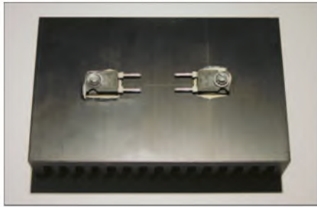
Bild 15: Aufbau der von KW bis 50 MHz geeigneten, kurzzeitig mit 200 W belastbaren Variante, erste Schritte
