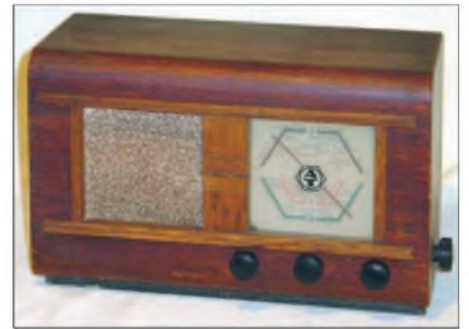
Bild 4: Notradio mit der RV12P2000: AT-217 GWK von 1947: Elektro-Apparate-Werke Berlin-Treptow
