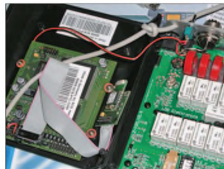
Bild 2: Das Bluetooth-Modul zur Steuerung des Modems durch den Rechner fand noch an den schrägen Seiten des Tunerdeckels Platz.
