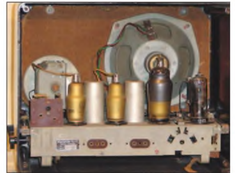
Bild 9: Innenansicht des Standard-Supers mit U-Topfröhren
