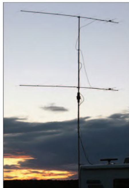
Bild 3: Gestockte Gruppe 8 über 8 für 2 m, 14,8 dBd Gewinn
