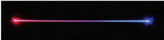
Bild 1: Nachtaufnahme; das Thermometer informiert durch die Farbmischung über die aktuelle Temperatur.
