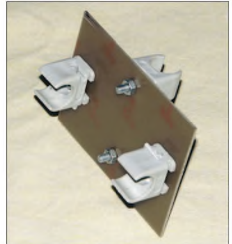
Bild 9: Halteplatte als Kreuzstück zur Befestigung des Booms an einer Angelrute
