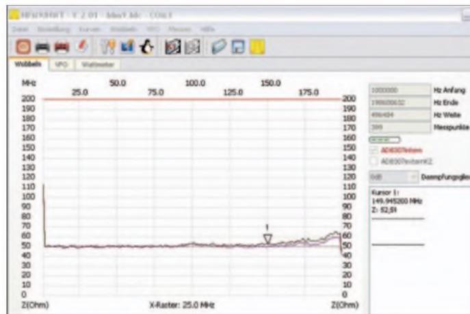
Bild 8: Messergebnis Reflexionsdämpfungsmessung an einzelnen Widerständen, rot 50 \Omega , schwarz 2 \times 100 \Omega parallel
