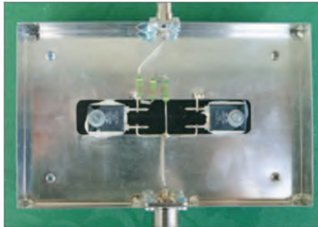
Bild 16: Fertiger Aufbau der 200-W-Version, erste Variante
