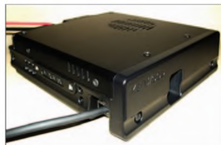
Bild 3: Das eigentliche Funkgerät; nicht verwechseln: Das Bedienteil wird vorne, das Mikrofon seitlich angeschlossen.
