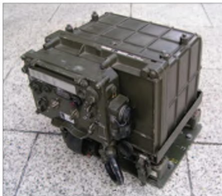
Das SEM-25 ist modular aufgebaut und besteht aus Stromversorgung, Transceiverblock und separatem Bedienteil.
