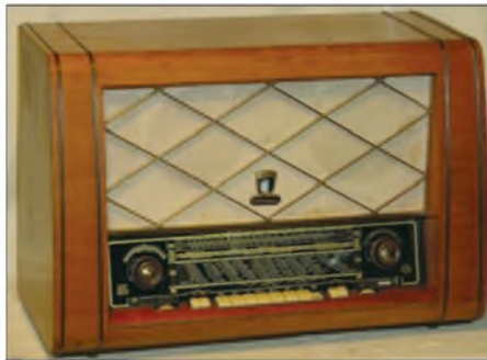
Bild 17: Neckermann Royal 111/21 mit UKW-Synchrodemodulator, gebaut von Körting
