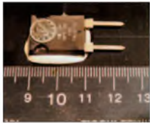
Bild 1: Widerstand 100 Ω / 100 W vor dem Anlöten
