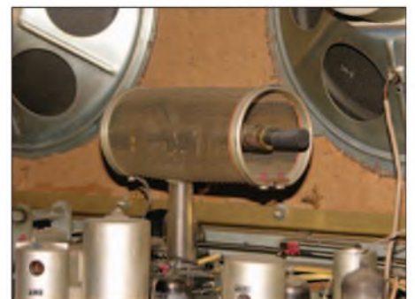
Bild 15: Drehbare, gegen elektrische Störungen abgeschirmte Ferritantenne
