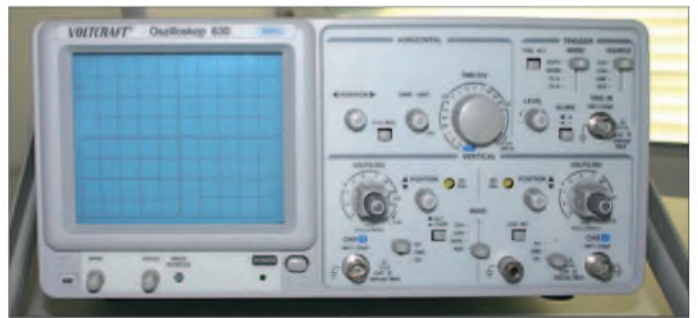
Bild 13: Das Voltcraft 630 ist ein gut ausgestattetes Analogoszilloskop für die Hobbypraxis.
