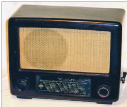
Bild 8: Standard-Super für Gleich- und Wechselstrom von WILAG
