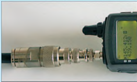
Bild 3: Bitte nicht nachahmen! Das starre, fast 11 mm dicke Koaxialkabel stellt eine viel zu starke Last für die winzige SMA-Buchse am Handfunkgerät dar.
