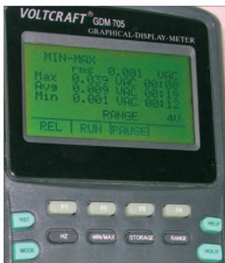
Bild 10: Digitale Oszilloskope können auch direkt Messwerte anzeigen und diese umrechnen. Selbst das GDM705 bietet bereits die Anzeige des True-RMS-Wertes.
