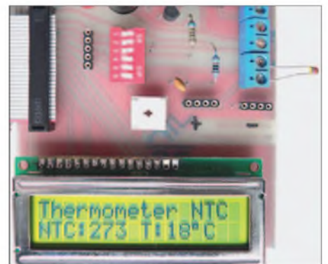
Bild 3: Die Zusatzaugruppe Experiment 2 ermöglicht auf Grundlage des MikroKid2 z. B. mit einem passenden Sensor den Aufbau eines Thermometers.
