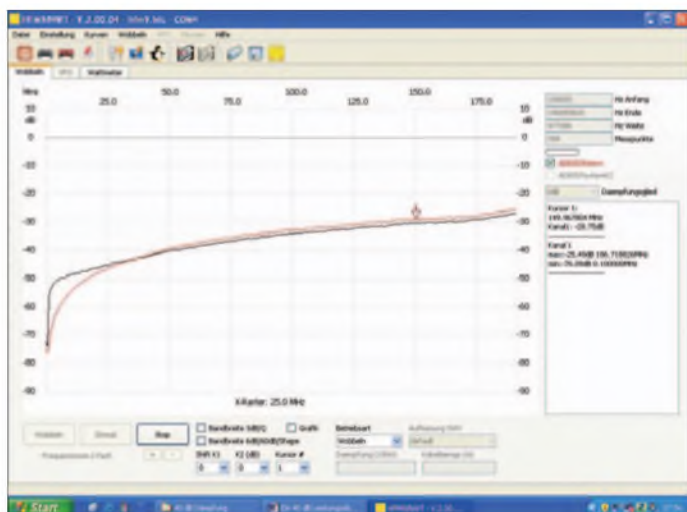
Bild 9: Messergebnis in der NWT-Betriebsart Z-Impedanz (schwarz 50 \Omega , violett 2 \times 100 \Omega )
