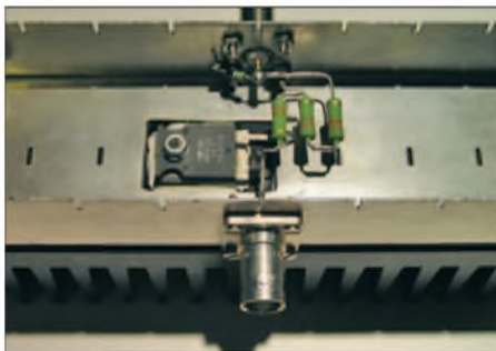
Bild 14: Die hier gezeigte Variante darf kurzzeitig mit maximal 100 W belastet werden.
