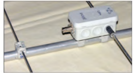
Bild 8: Mittelteil der 2-m-Yagi mit 6 Elementen
