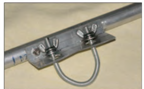
Bild 10: Selbstgefertigter Leichtbau-Haltebügel für Metallmasten
