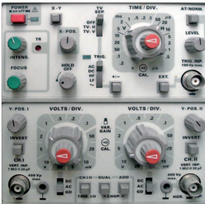
Bild 9: Geradezu klassisch ist das Bedienteil des Hameg HM203 gestaltet. Die klar gegliederten Bedienelemente helfen beim Zurechtfinden ungemein.
