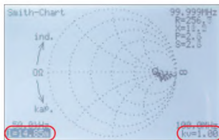
Bild 3: Der Längenabgleich funktioniert sogar mit falschem Verkürzungsfaktor: kv = 1,00 führt dabei zur elektrischen Länge l_{el} = 9,80 \text{ m} / 0,66 = 14,85 \text{ m} , vgl. Bild 1.
