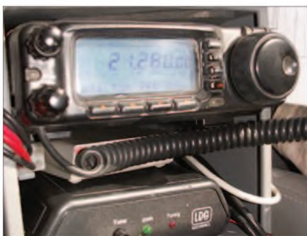
Bild 4: Ein gutes Gespann bildeten der Yaesu FT-100 und der Antennentuner Z-100 mit dem darin eingebauten PACTOR-Modem von SCS. Fotos: OE3MZC
