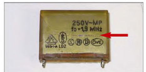
Zum Teil weisen die Kondensatoren sogar schon mit bloßem Auge sichtbare Risse in den Gehäusen auf. Fotos: DB1NV
