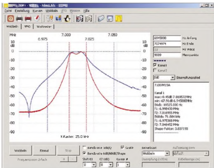
Bild 4: Durchlassdämpfung eines einzelnen Filters (blau) und zweier kaskadierter Quarzfilter (rot) des Typs 7022M15A
