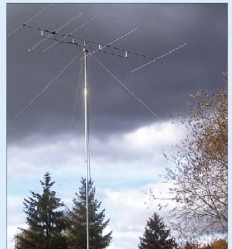
Bild 2: Yagi-Antennen werden im oberen KW-Bereich sowie im UKW-Bereich (hier eine 6-m-Antenne) häufig eingesetzt; sie lassen sich unter Beachtung einiger Grundregeln leicht selbst herstellen.
