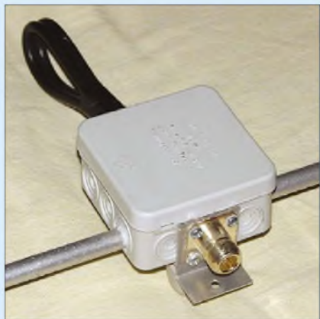
Bild 3: Der Haltewinkel für die Anschlussbuchse fixiert gleichzeitig die Antennendose auf dem Boom und sorgt für die notwendige Masseverbindung. Er kann auch im Inneren der Dose seinen Platz finden.
