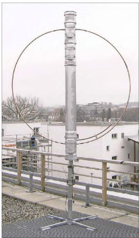
Bild 1: Aufbau der maxiLOOP mit 1,8 m Durchmesser für 80 und 40 m auf dem Antennendach der HTWG Konstanz
