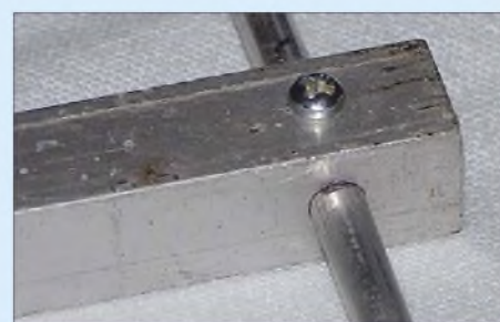
Bild 5: Durchdringende, leitende Elementmontage; das Element ist auf der gesamten Breite des Booms durch diesen kurzgeschlossen.
