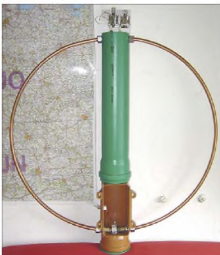
Bild 7: Gesamtansicht der miniLOOP mit geöffneter Revisionsklappe Fotos: DL6ZM
