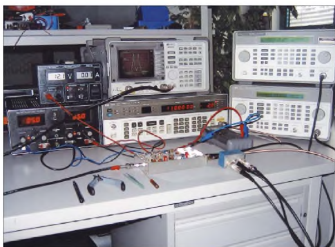
Bild 1: Messplatz mit drei HF -Generatoren, Spektrumanalysator, Netzteilen und Leistungsteiler/-addierer Fotos und Screenshots: DL1DH
