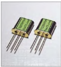
Bild 5: Zweipolige Quarzfilter für den Telegrafiebereich des 40-m-Bands
