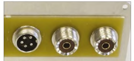
Bild 2: Isolierstreifen (dritter Teil der Platine) an der Außenseite des Bodenwinkels
