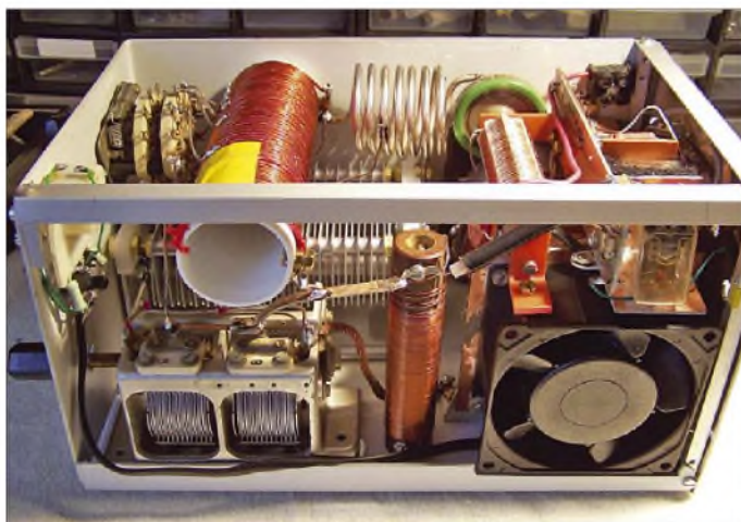
Bild 4: Aufbau des HF-Teils; hier noch mit dem ursprünglich vorgesehenen Keramikschalter
