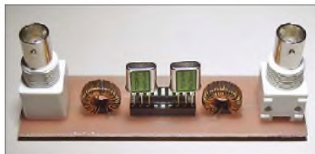
Bild 8: Der Probeaufbau war aus HF-Sicht nicht optimal – lange Anschlüsse sollten vermieden werden.
