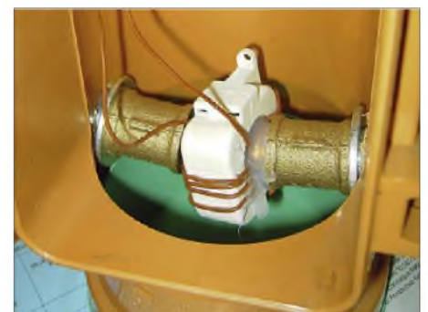
Bild 5: Neuartige galvanisch getrennte Einkopplungsmethode unter Verwendung eines Ringkerns
