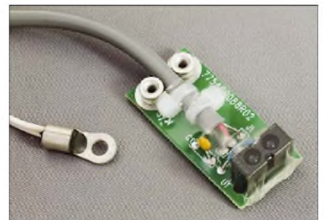
Bild 3: Temperatursensoren (links) und Drehzahlsensor (rechts)
