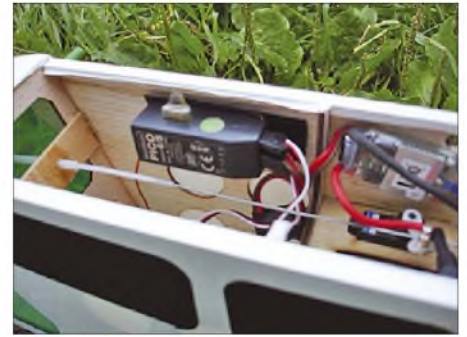
Der Oszillator des Empfängers ist im Leichtbaugehäuse kaum abgeschirmt und dadurch aus relativ großer Entfernung zu orten.
