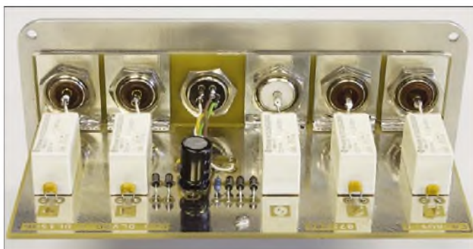
Bild 1: Der Kontaktstreifen der Platine wird rechtwinklig mit dem Hauptteil der Platine verlötet und dient gleichzeitig zu deren Befestigung am Bodenwinkel des Mastgehäuses.
