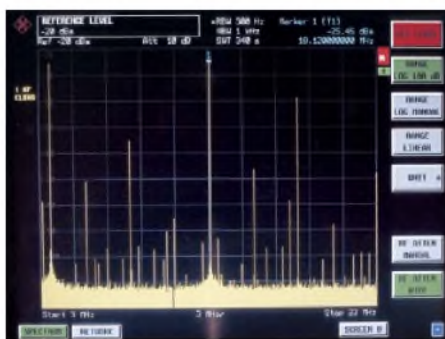
Bild 6: Spektren für den IE-500 bei 11 MHz Oszillatorfrequenz (0 dBm) und 7,1 MHz Eingangsfrequenz (oben 0 dBm, Mitte -10 dBm, unten -20 dBm, der Referenzwert des Analysators entspricht diesen Werten); die Mischerdämpfung beträgt je 5,5 dB. Man erkennt deutlich, dass Zahl und Amplitude der unerwünschten Produkte überproportional zu den Eingangspegeln steigen.
